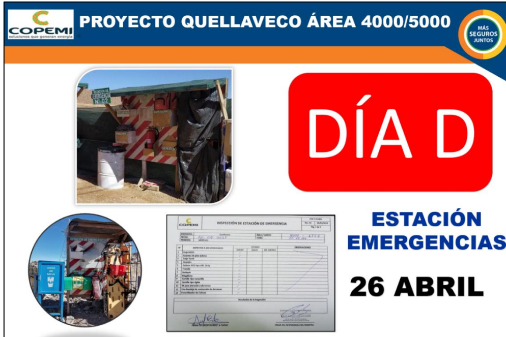
Figura 52: Estaciones de Emergencia implementadas en cada frente de trabajo, se verifica que los elementos estén completos y con fechas vigentes a través del check list pre-uso semanal.
