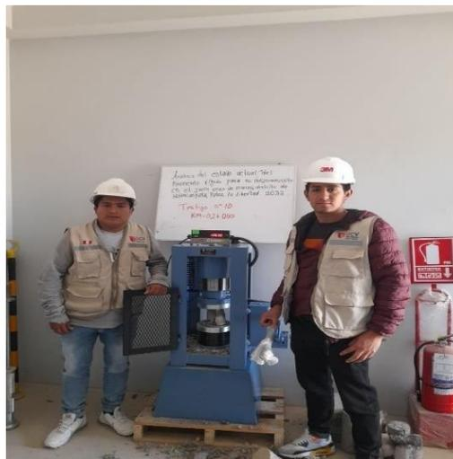
**Figura 27.** *Ensayo de resistencia de testigos.*
