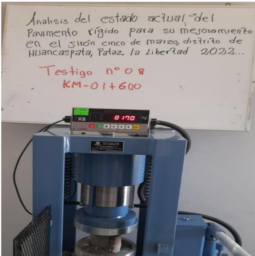
**Resistencia a la compresión del testigo N°8**
