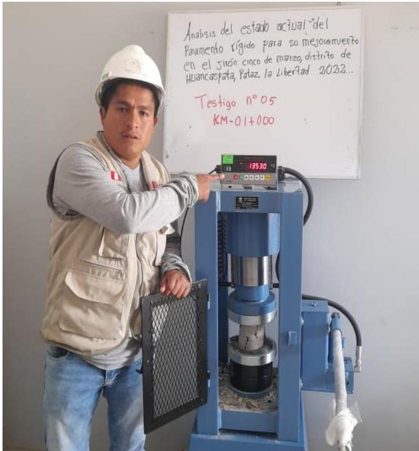
**Resistencia a la compresión del testigo N°5**
