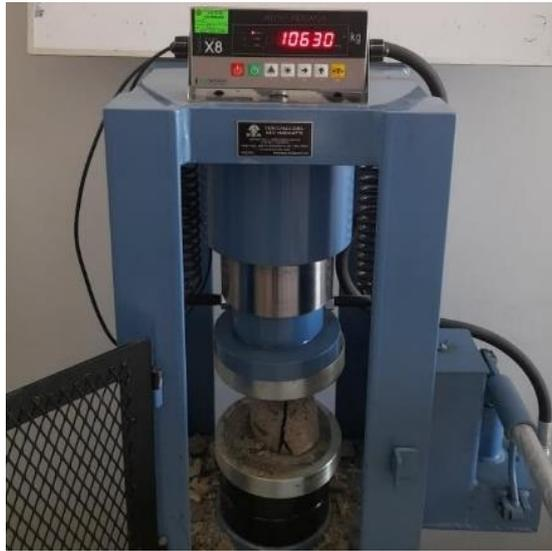
**Figura 28.** Resistencia del testigo.
