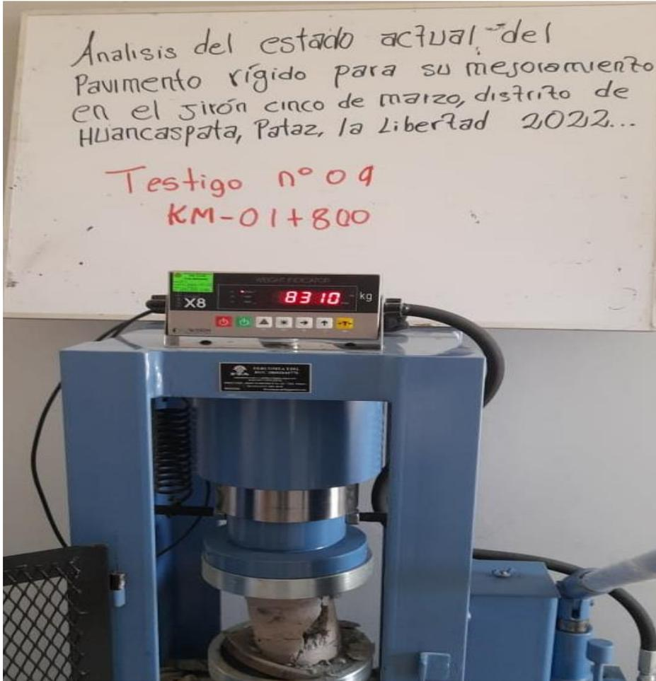
**Resistencia a la compresión del testigo N°9**
