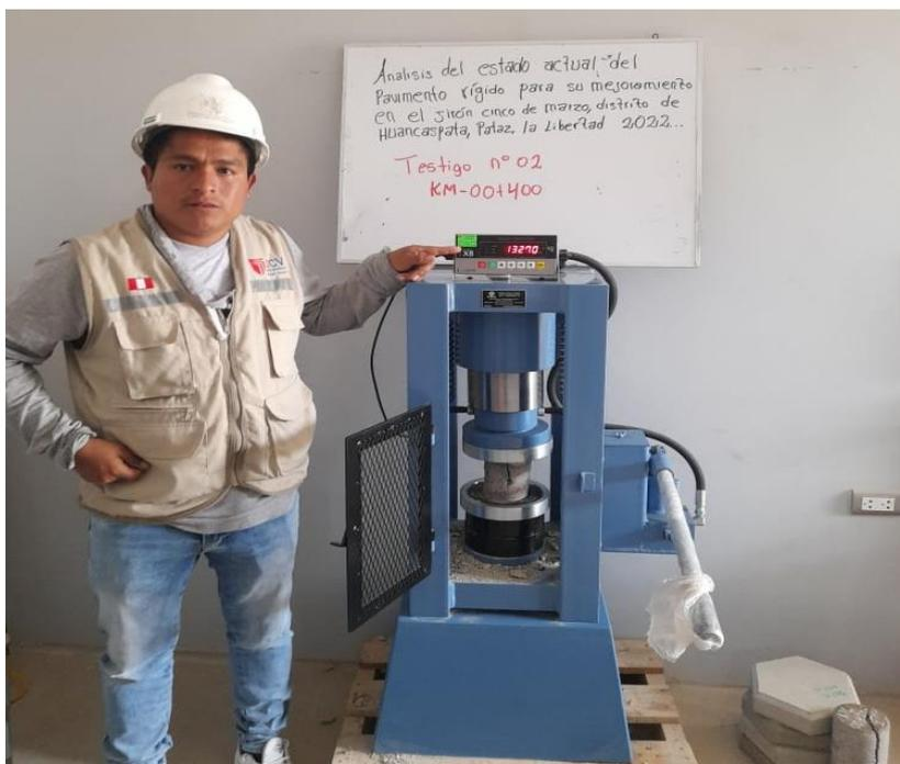
**Resistencia a la compresión del testigo N°2**
