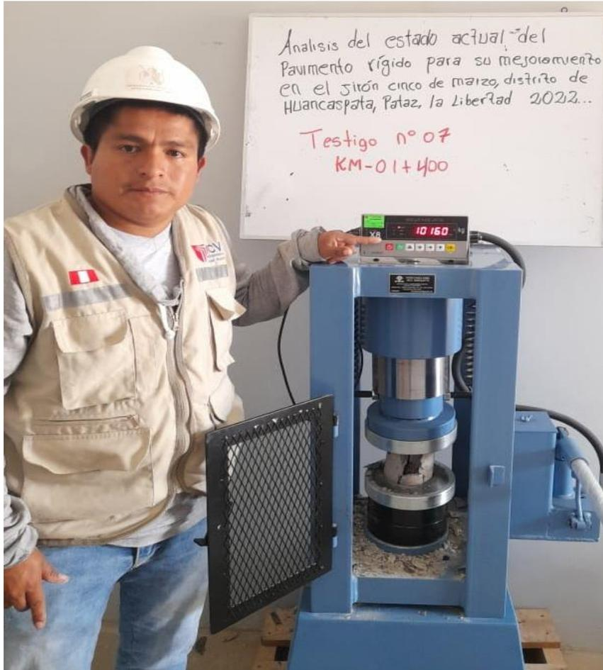
**Resistencia a la compresión del testigo N°7**
