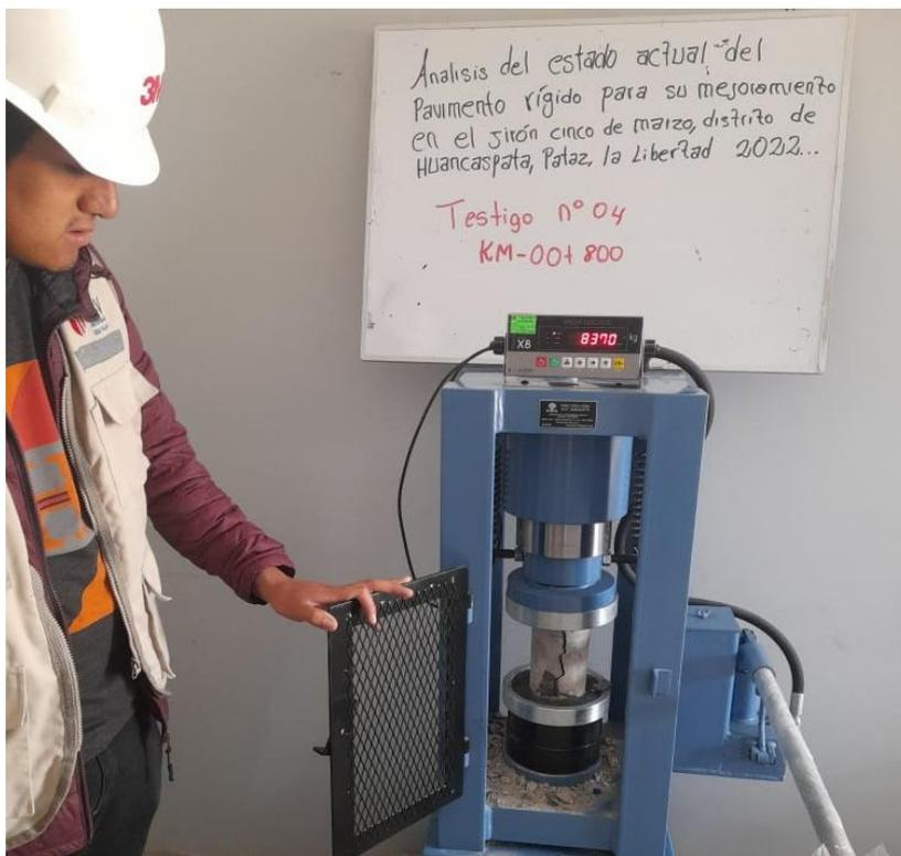
**Resistencia a la compresión del testigo N°4**
