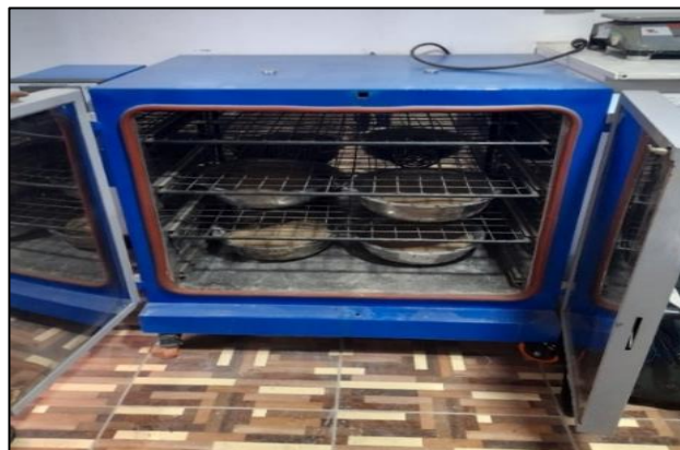
Figura N°5. Muestras colocadas en el horno para secado
