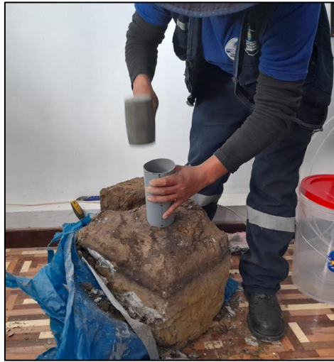
Figura Nº 23. Muestra inalterada de suelo fino
