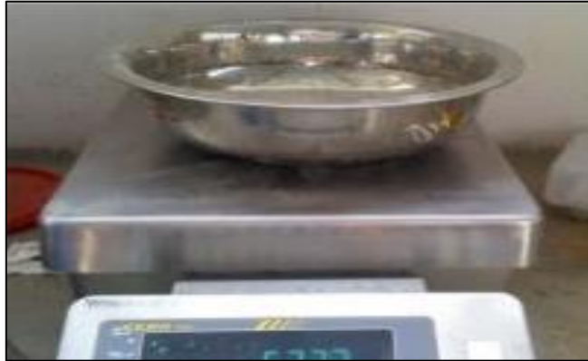
Figura N°6. La muestra es pesada con el contenedor
