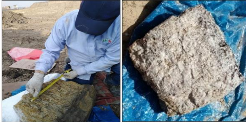
Figura N°3. Muestra inalterada para suelo fino.
