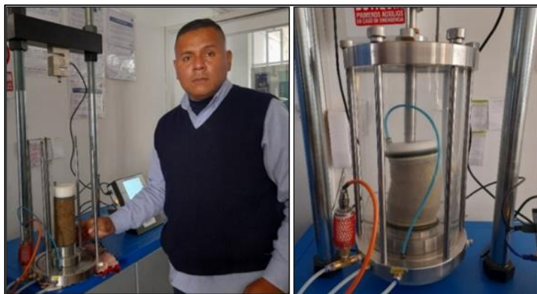
figura N°12. Ensayo triaxial UU con muestra de suelo inalterada
