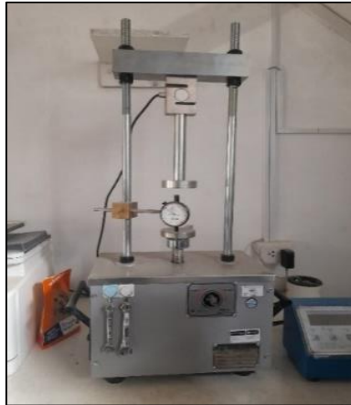
Figura N°13. Equipo de compresión no confinada
