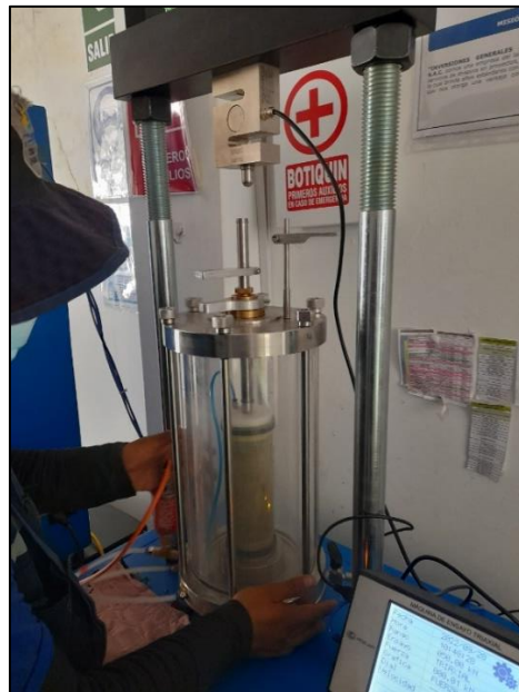
Figura N° 26. Preparación de la muestra para el ensayo triaxial UU
