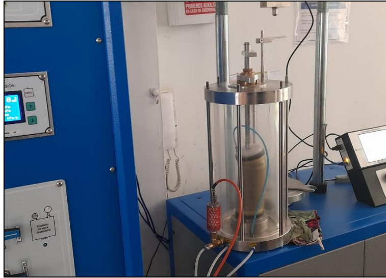
Figura N° 27. Desarrollo del ensayo triaxial UU
