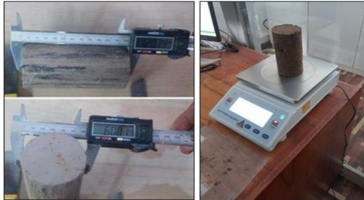
Figura N°15. Medidas y peso del espécimen
