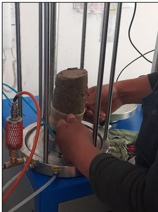
Figura N° 28. Muestra de espécimen después del ensayo triaxial
