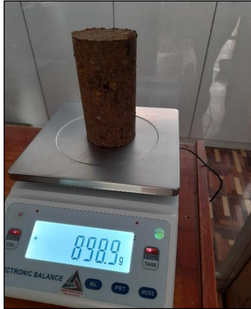
Figura N° 25. Determinar de peso del espécimen
