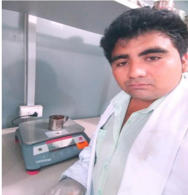
**FOTO N°15:** PESADO DE MUESTRA EN TARAS PARA LLEVAR AL HORNO DURANTE 24 HORAS PARA EL ENSAYO DE GRANULOMETRÍA.
