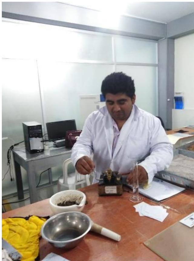
**FOTO N°18:** ENSAYO DE LÍMITE LÍQUIDO USANDO EL MÉTODO CASAGRANDE
