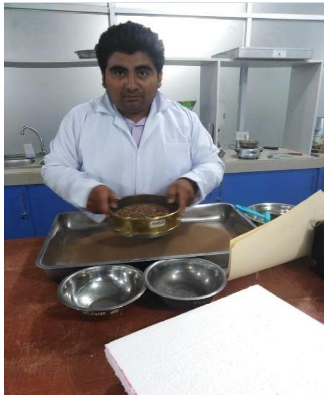
**FOTO N°16:** TAMIZADO DE MUESTRA SECA PARA OBTENER EL ENSAYO DE LÍMITES.
