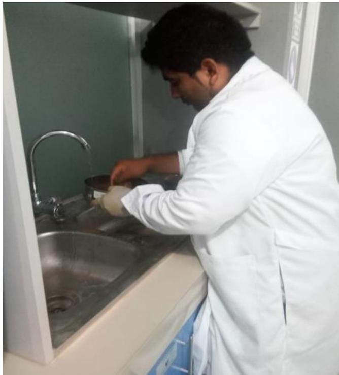
**FOTO N°14:** LAVADO DE MUESTRA Y SECADO PARA HACER EL ENSAYO DE LÍMITES.
