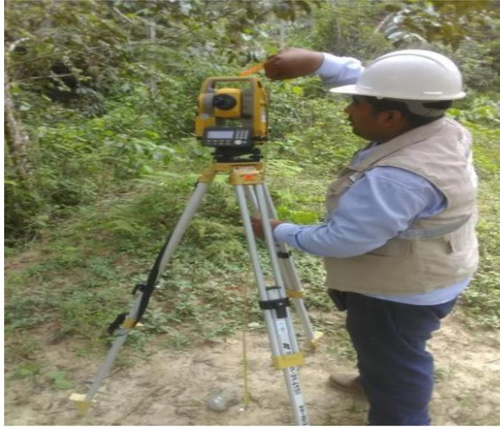
**FOTO N°1:** UBICACIÓN DEL PRIMER **BM1** CON SU RESPETIVA ALTURA DE EQUIPO Y INGRESO DE COORDENADAS CAPTADAS POR EL GPS.
