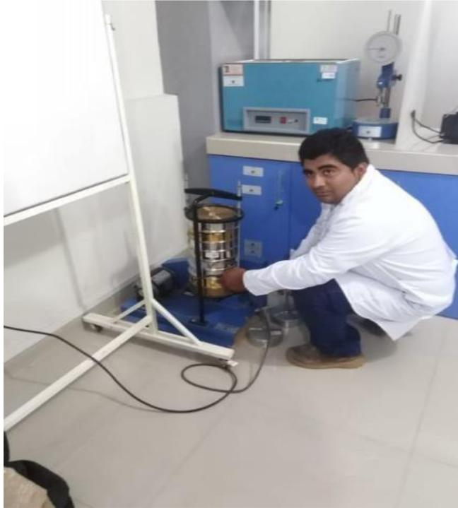
**FOTO N°17:** ENSAYO DE GRANULOMETRÍA USANDO TAMIZADOR ELÉCTRICO.
