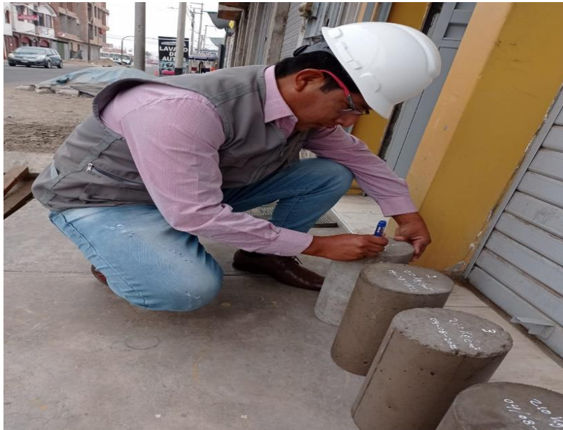
Fotografía 3. La codificación de las muestras de concreto
