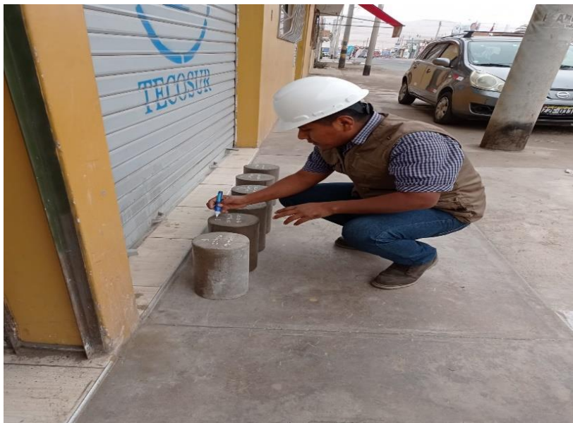
Fotografía 4. La codificación de las muestras de concreto
