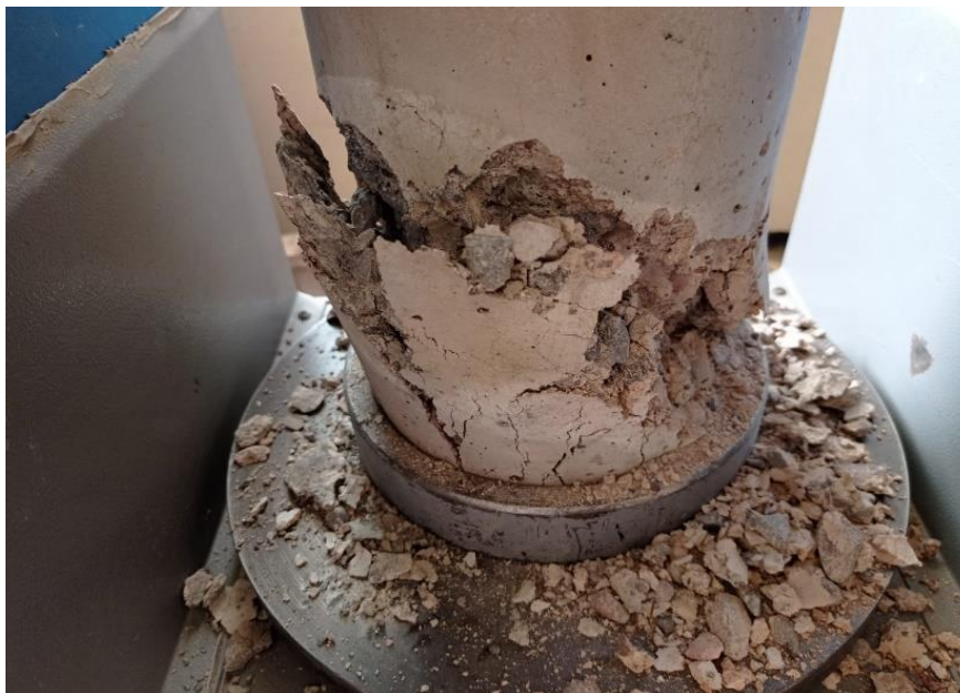
Fotografía 18. La rotura después de ser sometido a 800°C
