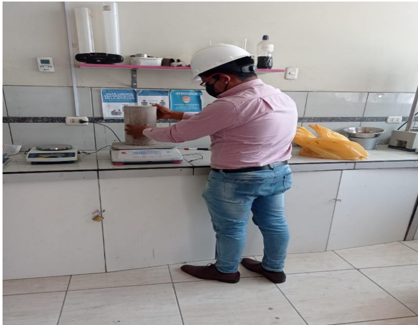
Fotografía 5. Se procede a pesar las briquetas de concreto
