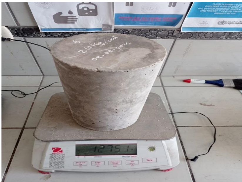
Fotografía 6. Se ve el peso de la briketa de concreto que es de 12751 g
