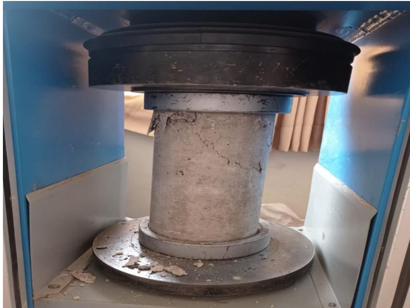
Fotografía 9. La rotura de las briquetas a los 28 días
