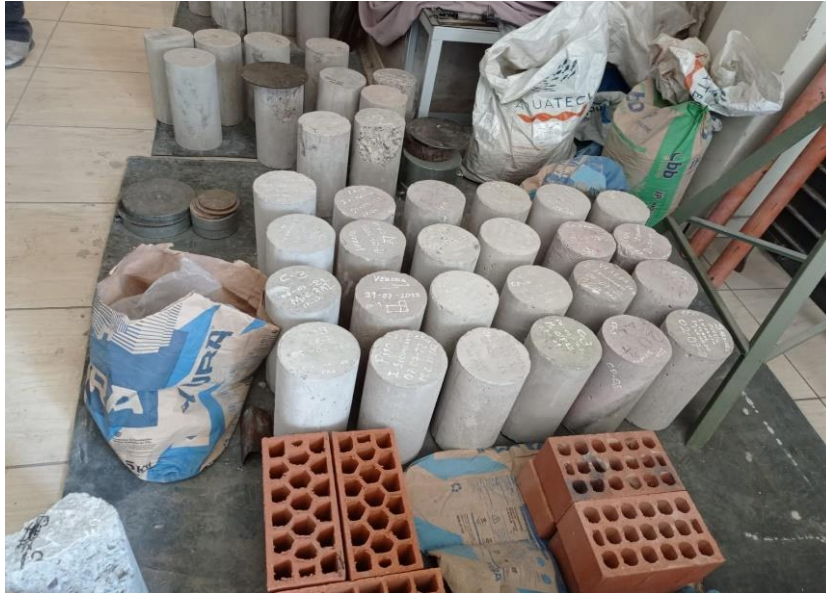
Fotografía 2. La preparación de las muestras de columnas 210 kg/cm 2
