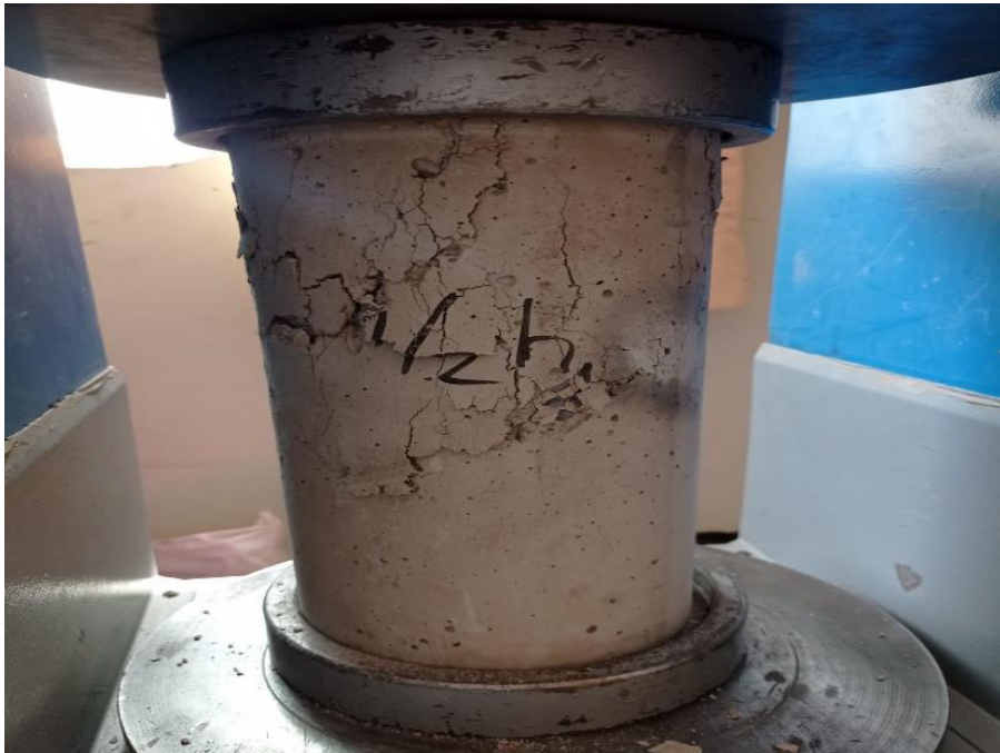
Fotografía 16. La rotura después de ser sometido a 800°C
