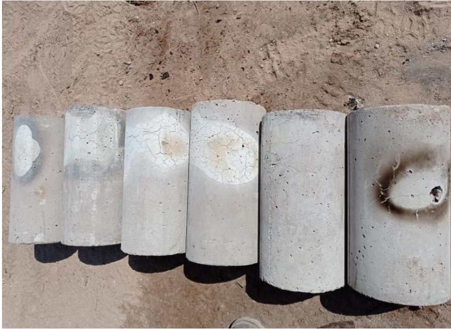
Fotografía 13. Quemado de las briquetas a 800°C
