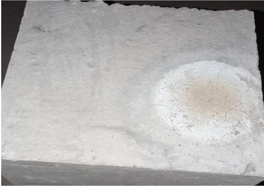
Fotografía 16. La rotura después de ser sometido a 800°C
