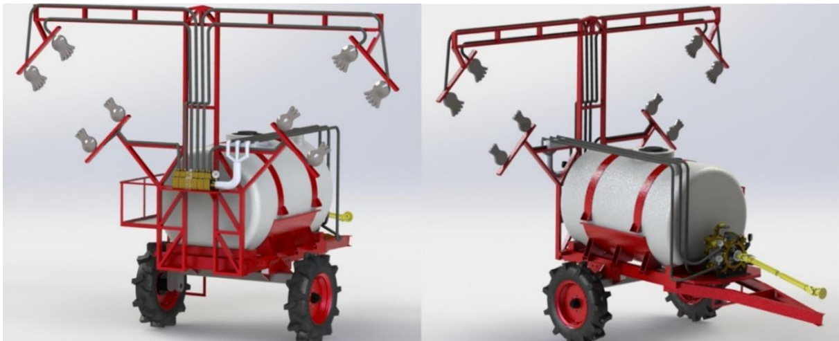
Figura 35. Renderizado de la maquinaria con sistema de pulverización hidráulica para cultivos de parrón tipo californiano. Nota: la apreciación general del pulverizador diseñado se evidencia con las vistas hechas.
