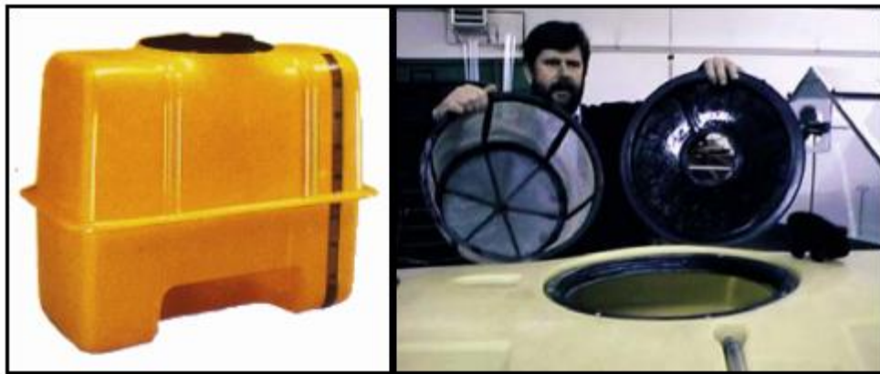
Figura 5 Depósito, boca de llenado y detalle de elementos Nota: se puede observar la estructura de un depósito de fertilizantes o pesticidas.
