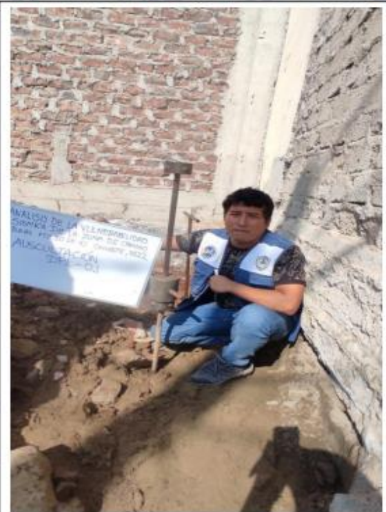
Foto N°01: Vista de la calicata C-01, con presencia de arena limosa (SM) de compacidad suelta a compacta, húmeda a saturada, de color marrón a beige claro de 0.45 a 3.10m. Presencia de napa freática a - 1.35m. de profundidad.
