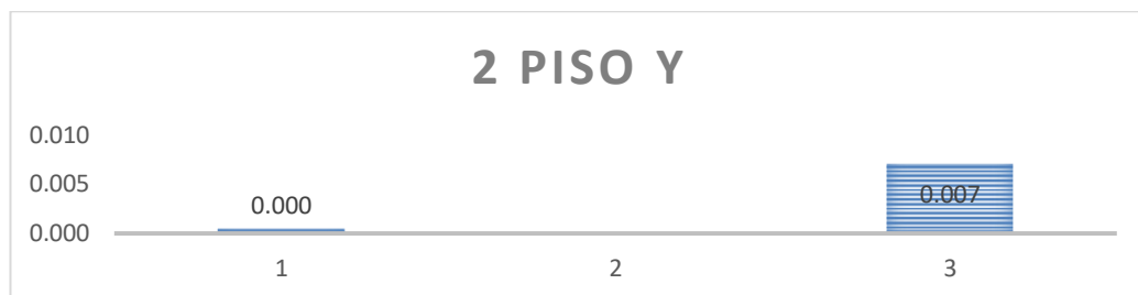
Figura 40. Distorsión de eje Y en segundo piso.
