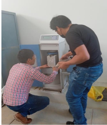
Foto 28,29 colocación de muestras a la máquina de compresión axial
