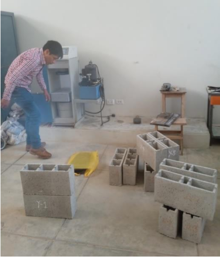
Foto 28,29 colocación de muestras a la máquina de compresión axial
