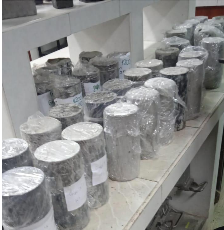
Elaboración de probetas de concreto
