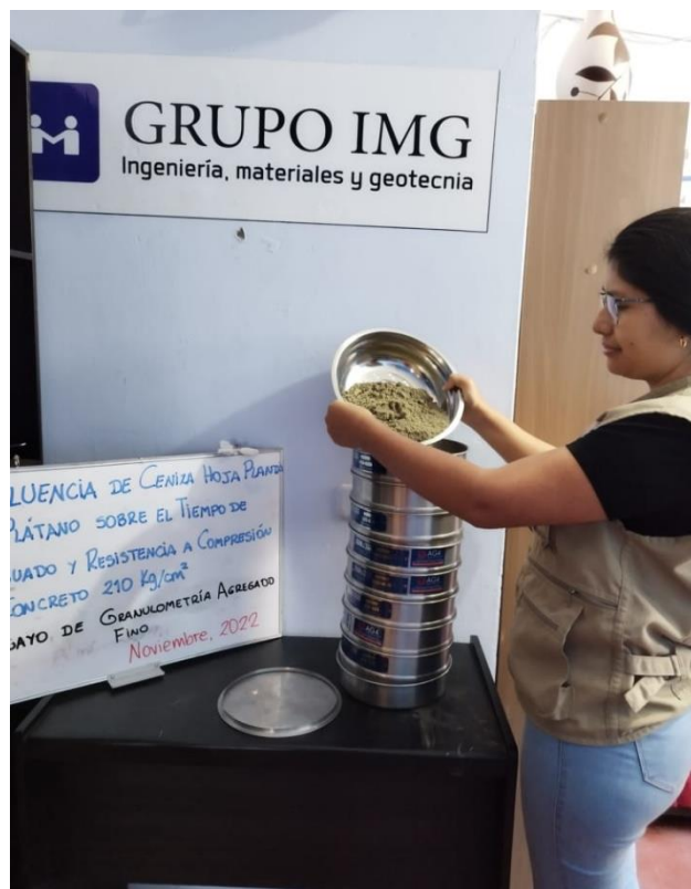
Ensayo de granulometría del agregado fino
