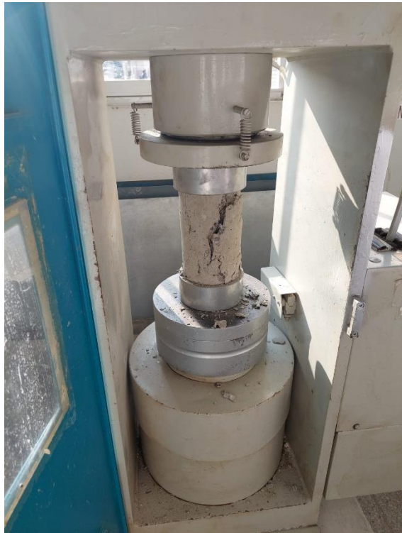
Ensayo de resistencia a compresión de probetas
