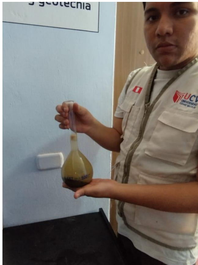
Muestra saturada de agregado fino
