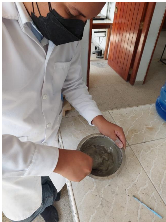
Preparación de la pasta de cemento para el ensayo de tiempo de fraguado
