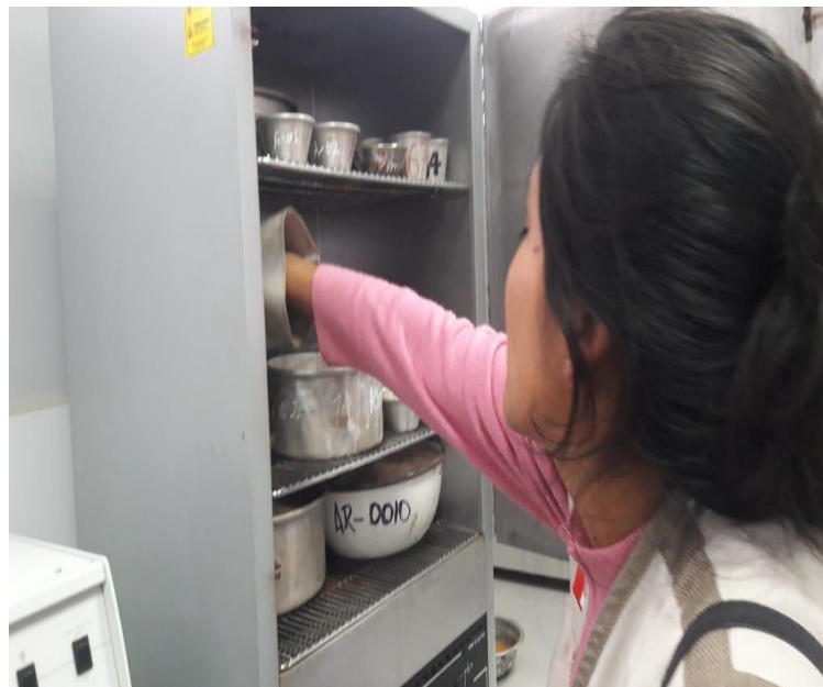
Ensayo de contenido de humedad de los agregados
