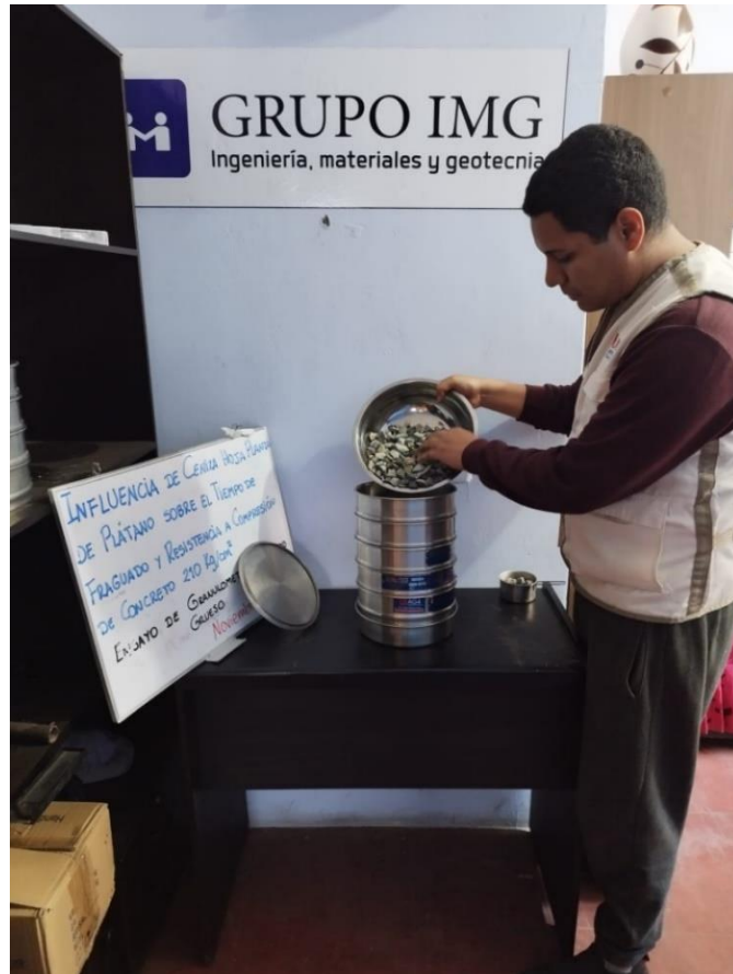
Ensayo de granulometría del agregado grueso
