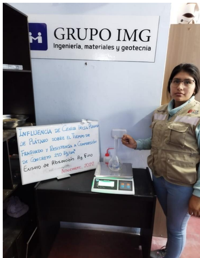
Peso de la fiola para el ensayo de peso específico y absorción del agregado fino
