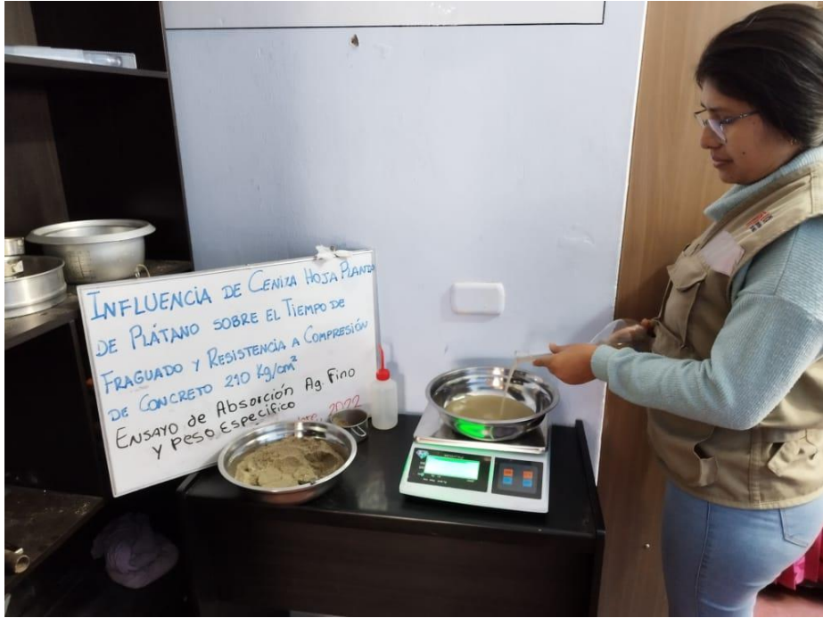
Ensayo de peso específico y absorción del agregado fino
