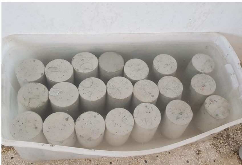
Curado de las probetas de concreto
