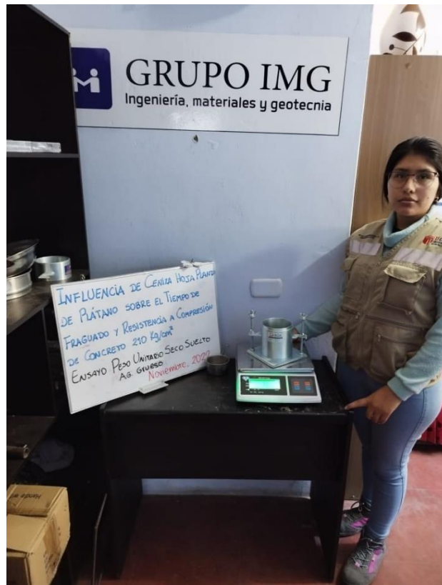
Pesado del molde para el ensayo de pesos unitarios
