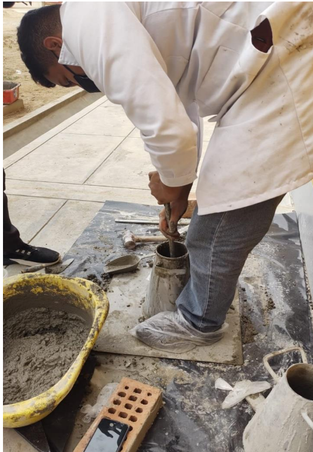
Ensayo de consistencia para la mezcla de concreto
