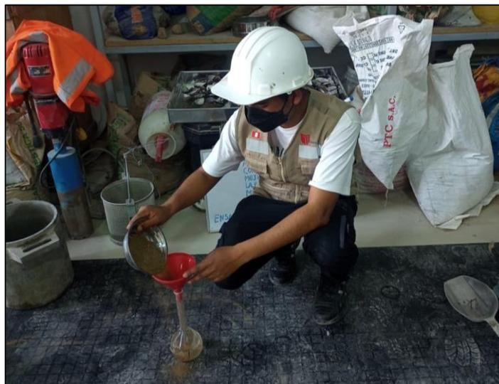
*Figura 29: Gravedad específica del agregado fino*
