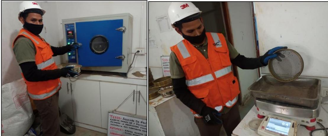
Figura 24: Colocación del Agregado fino al horno y tamizado.
