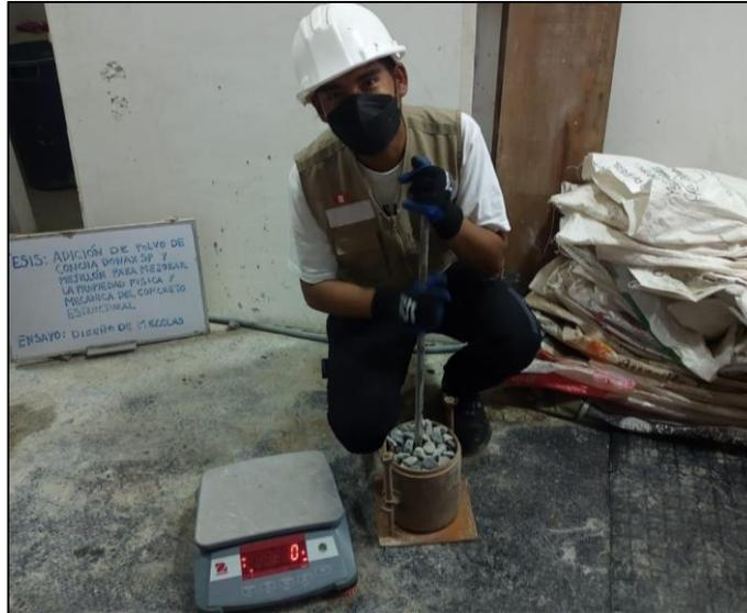
Figura 26: Compactado del agregado grueso
