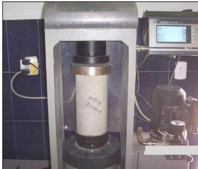
*Figura 10: Ensayo de resistencia a la compresión*
