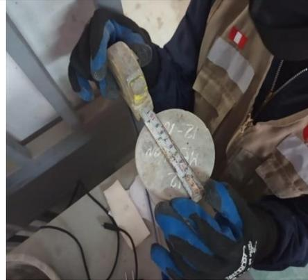
Fotografía 14. Medida de diámetro de probeta
