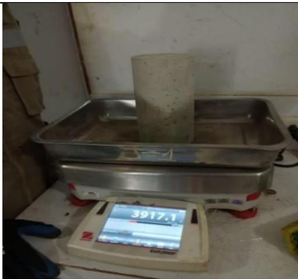
Fotografía 15. Pesaje de la probeta retirada de la poza de agua
