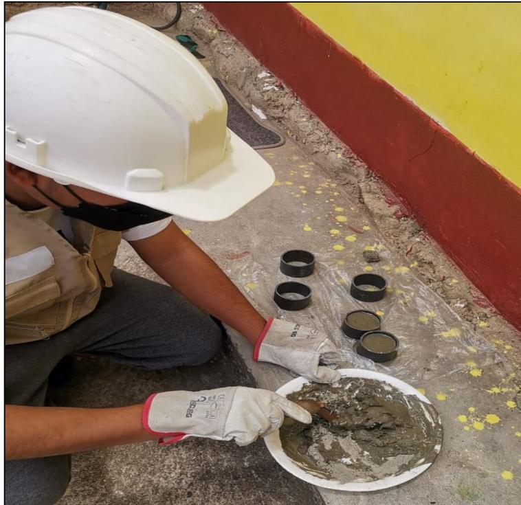
*Figura 40:* Elaboración de la mezcla de agua y cemento
