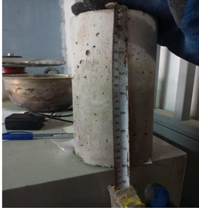
Fotografía 13. Medida de longitud de probeta
