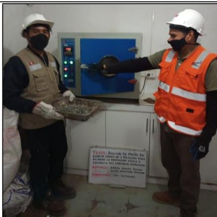
Fotografía 1. Colocación del agregado grueso al horno.
