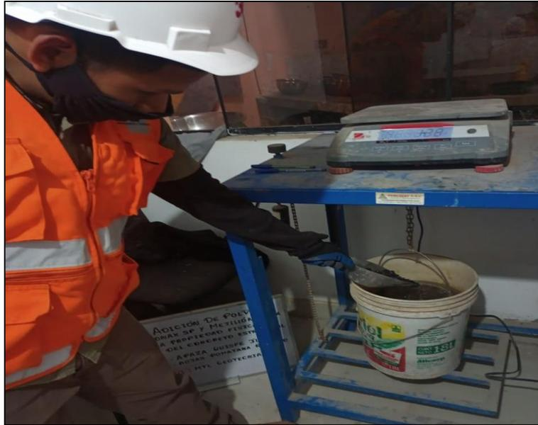
Figura 30: Gravedad específica del agregado grueso
