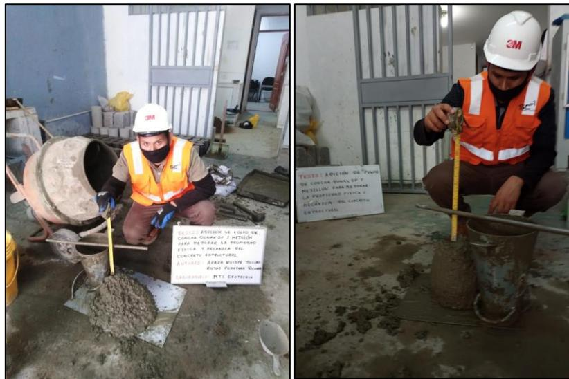
Figura 34: Mediciones del slump del concreto
