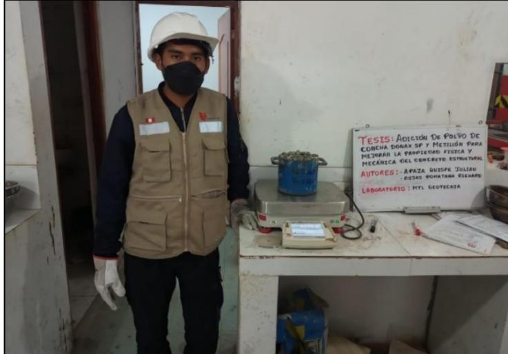
*Figura 28: Peso unitario suelto del agregado grueso*
