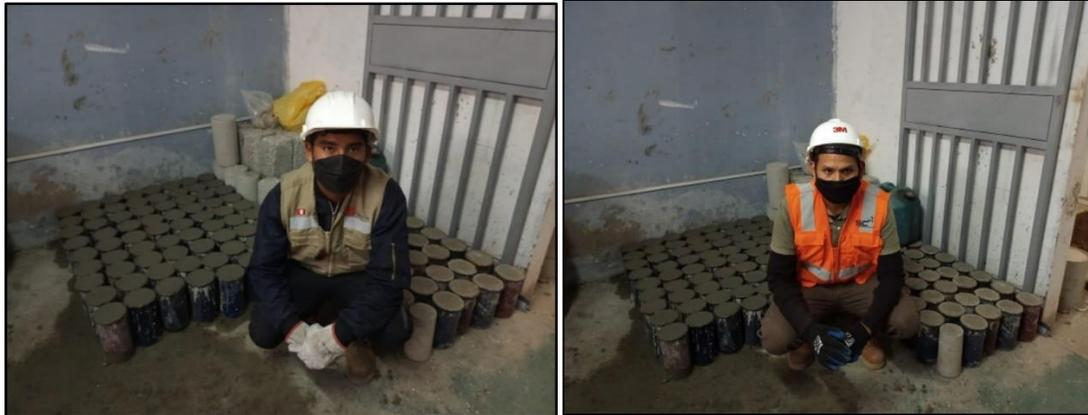
*Figura 37:* Cantidad total de probetas patrones y experimentales elaborados
