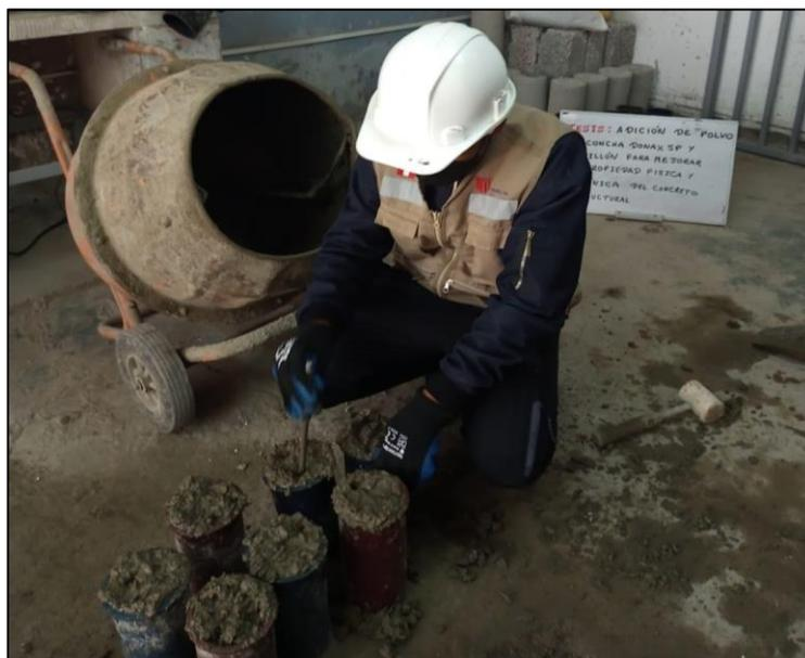
*Figura 36: Vaciado de mezcla a los moldes cilíndricos*
