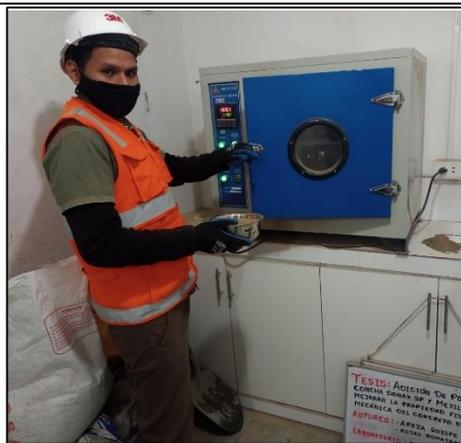
Fotografía 2. Colocación de agregado fino al horno
