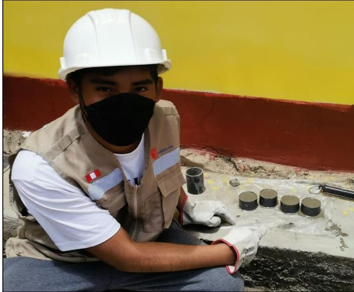
*Figura 41:* Vaciado de la mezcla a los moldes PVC
