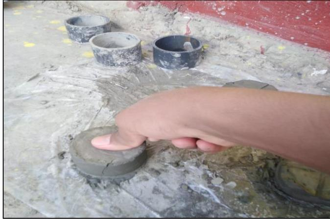
*Figura 43: Fraguado final de la muestra.*
