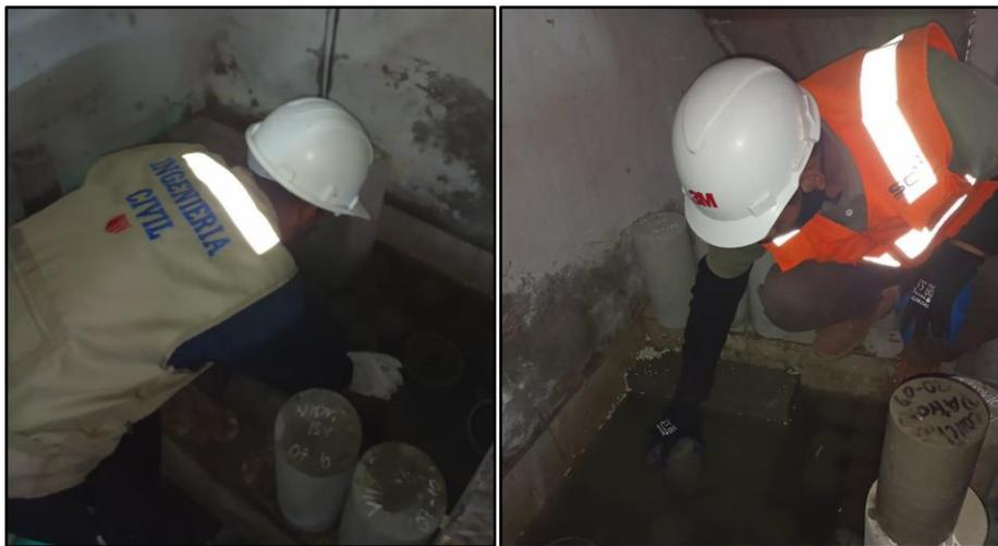
*Figura 38:* Colocación y retirado de las probetas en la poza.
