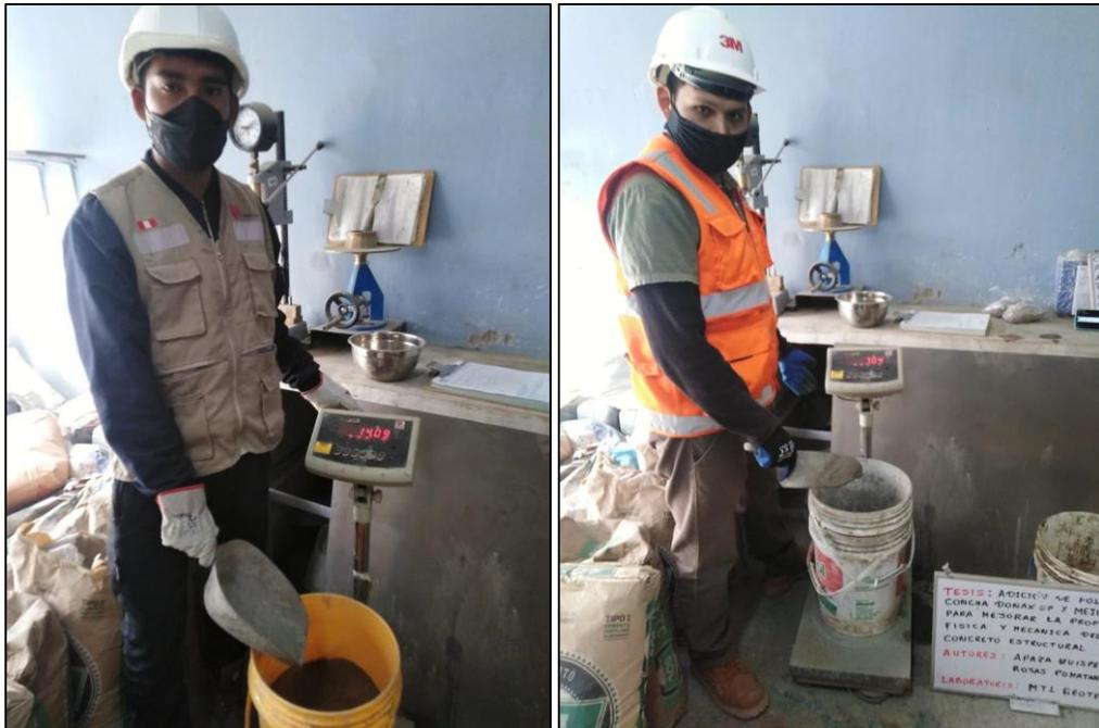
Figura 33: Peso de los agregados para los diseños de mezcla.
