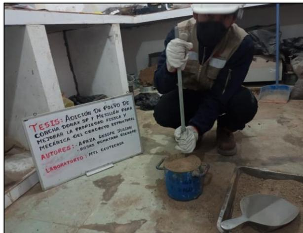
Figura 25: Compactado del agregado fino
