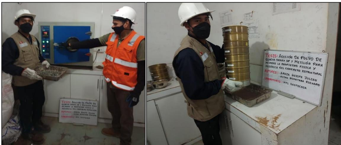
Figura 23: Colocación del Agregado grueso al horno y tamizado
