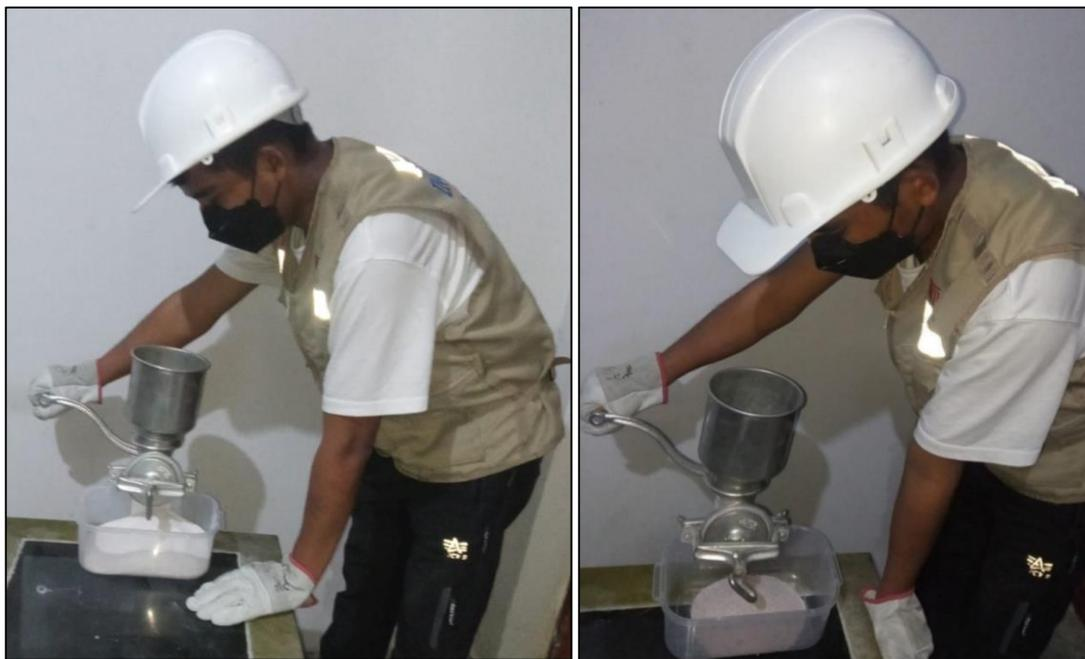
*Figura 22: Pulverización de Conchas Donax sp y Mejillón mediante un molino*
