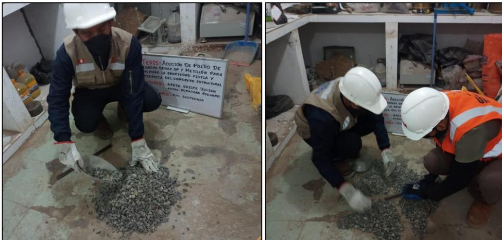
Figura 27: Cuarteo del agregado grueso.
