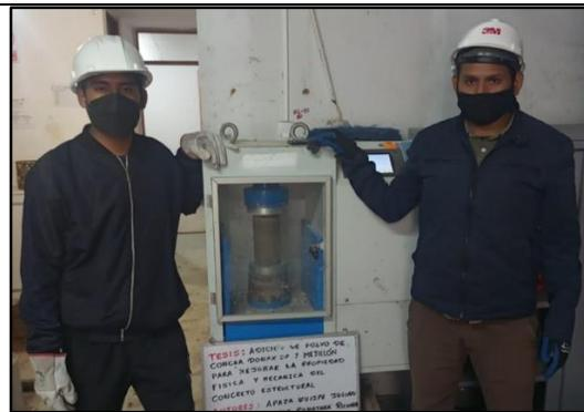
Fotografía 16. Colocación de probetas a la prensa hidráulica
