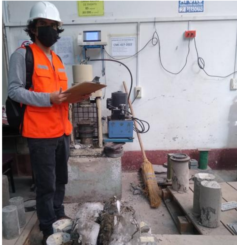
Ensayo de rotura de probetas
