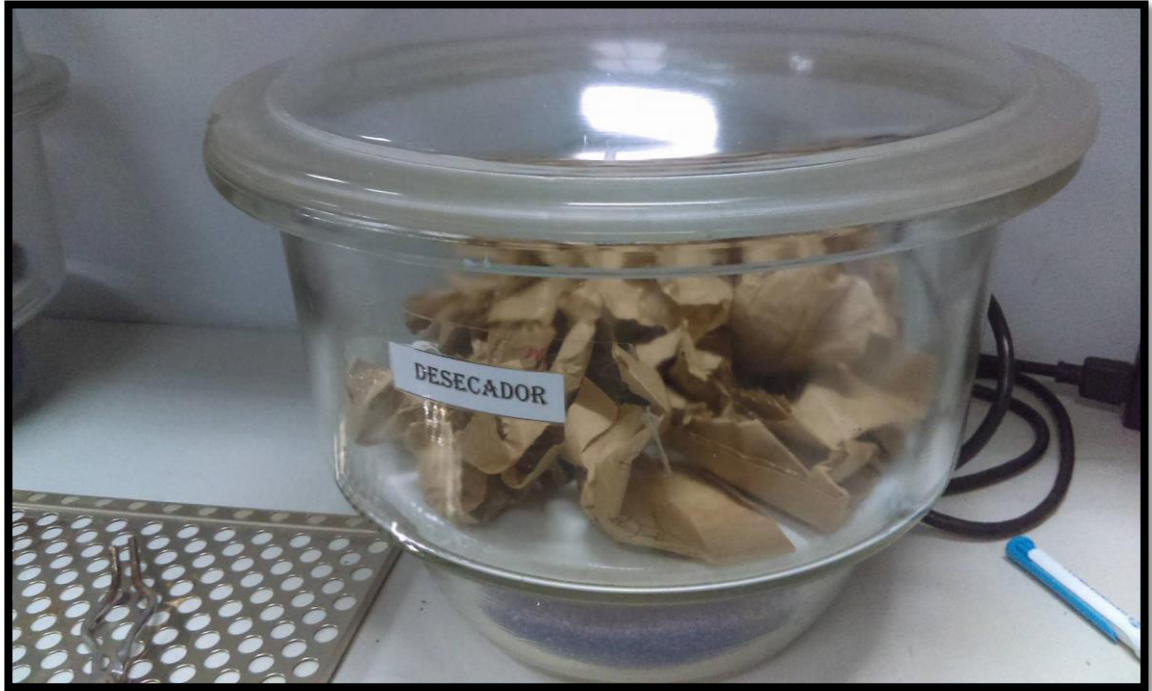
FOTO N°8: Muestras en el desecador para luego pesarlas.
