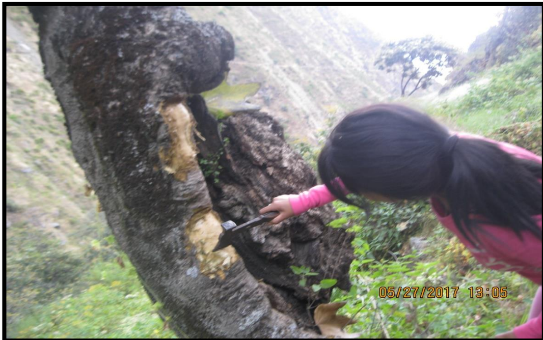
FOTO N°4: Sacando las tres muestras de cubito de madera de 2 cm x 2cm.
