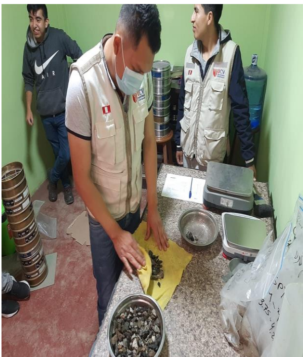
Anexo 11.4. Lavado y secado en el horno los agregados finos y gruesos.
