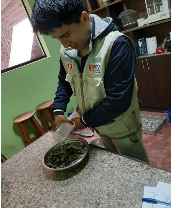
Anexo 11.4. Lavado y secado en el horno los agregados finos y gruesos.
