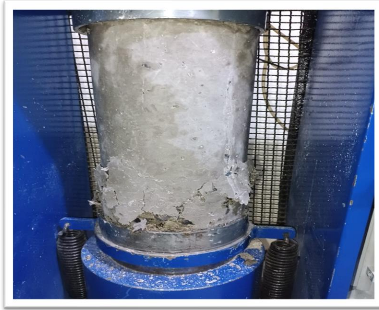
Figura 46. Verificación de falla en prensa hidráulica.
