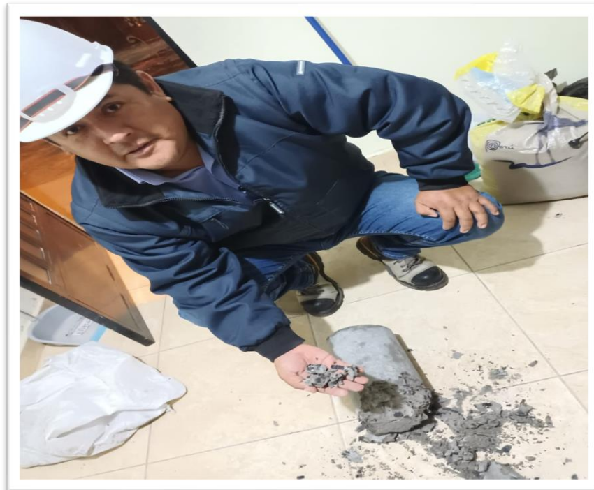
Figura 45. Material suelto despues de la ruptura, concreto patron.
