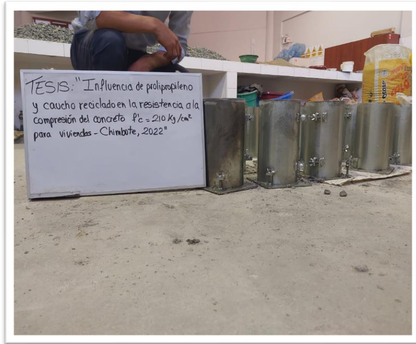
Figura 26. Probetas cilíndricas de 15 cm*30 cm.
