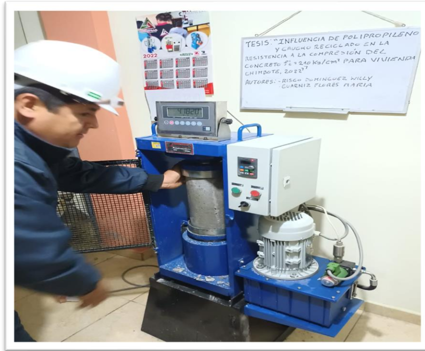
Figura 40. Colocacion de probetas en prensa hidraulica.
