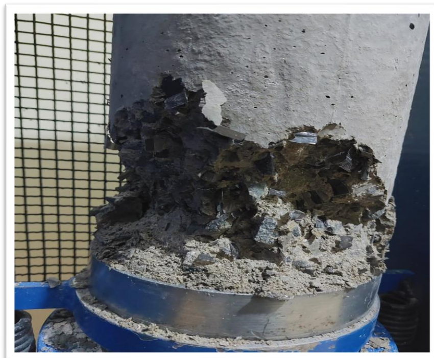
Figura 35. Tipo de falla despues de aplicarle presión.
