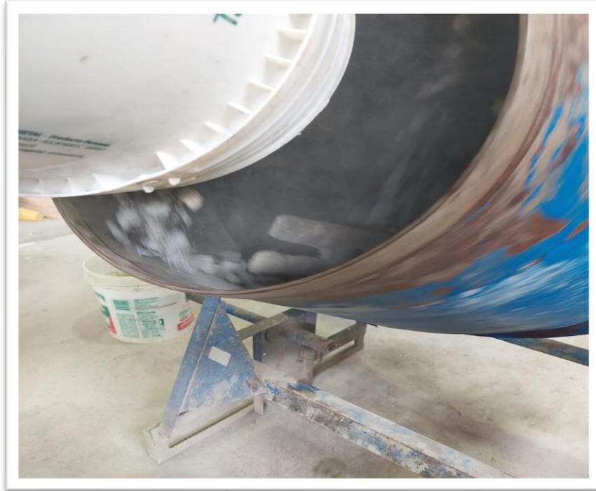
Figura 20. Incorporacion de agregado grueso (piedra \frac{3}{4} " ).
