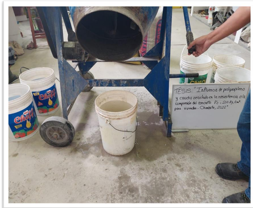
Figura 14. Limpieza de mezclador de concreto para retirar impurezas.
