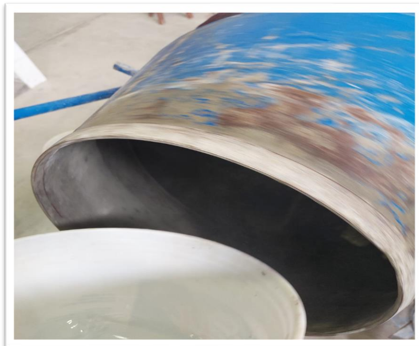
Figura 15. Incorporación de agua según diseño de mezcla.
