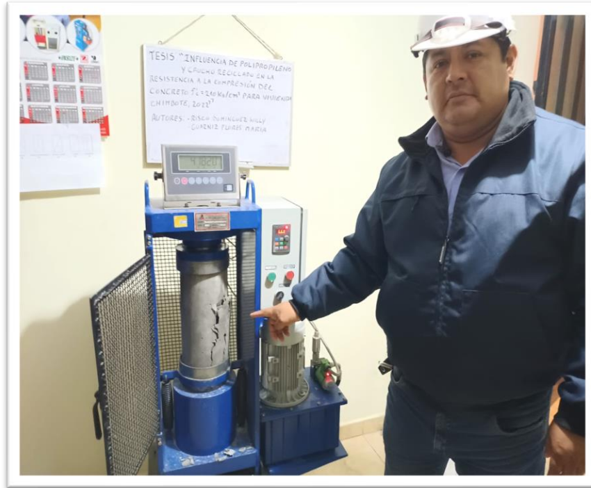
Figura 42. Probetas 28 días tipo de falla.
