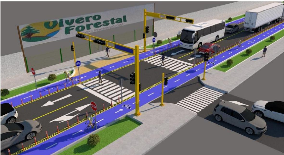
Figura 12: Modelamiento AC3D – Tramo Típico en las Intersecciones de la Ciclovía.
