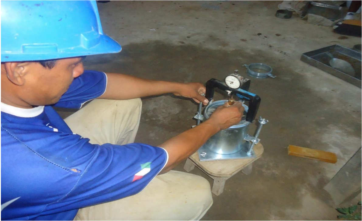
Ilustración 132, Ensayo de abrasión y penetración CBR ASTM D 1883 elaboración propia.
