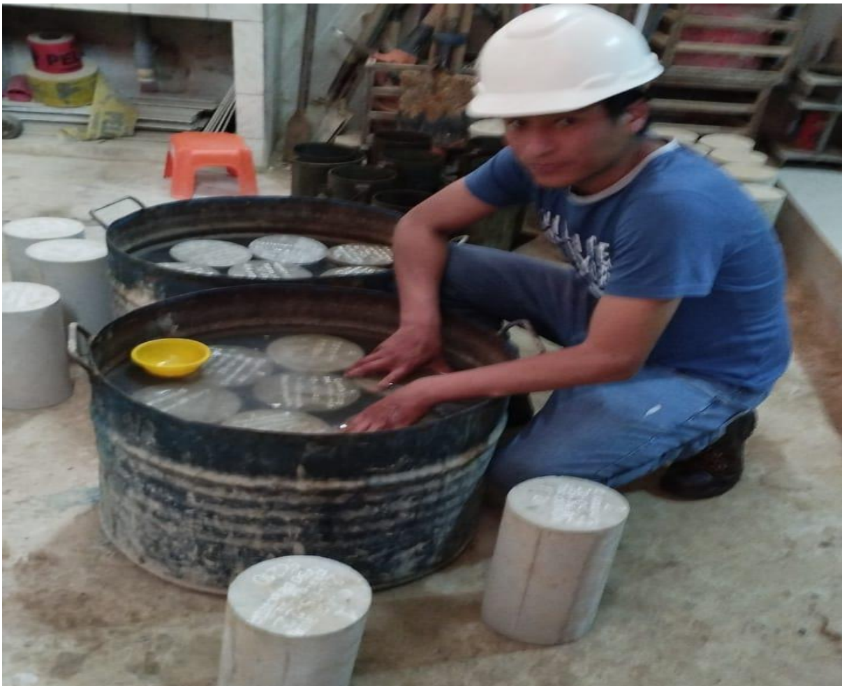
Ilustración 125, ensayo de resistencias F'c= 140, 175 y 210kg/cm 2 elaboración propia.
