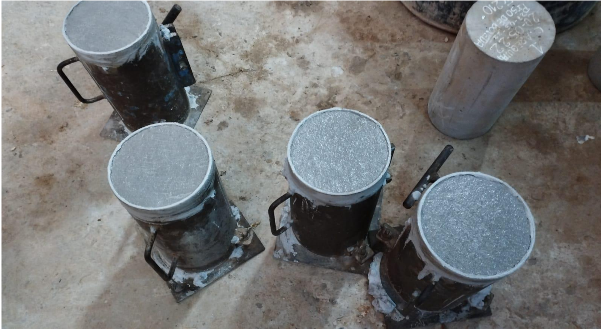
Ilustración 124, ensayo de resistencias f'c 140, 175 y 210 kg/cm 2 elaboración propia.
