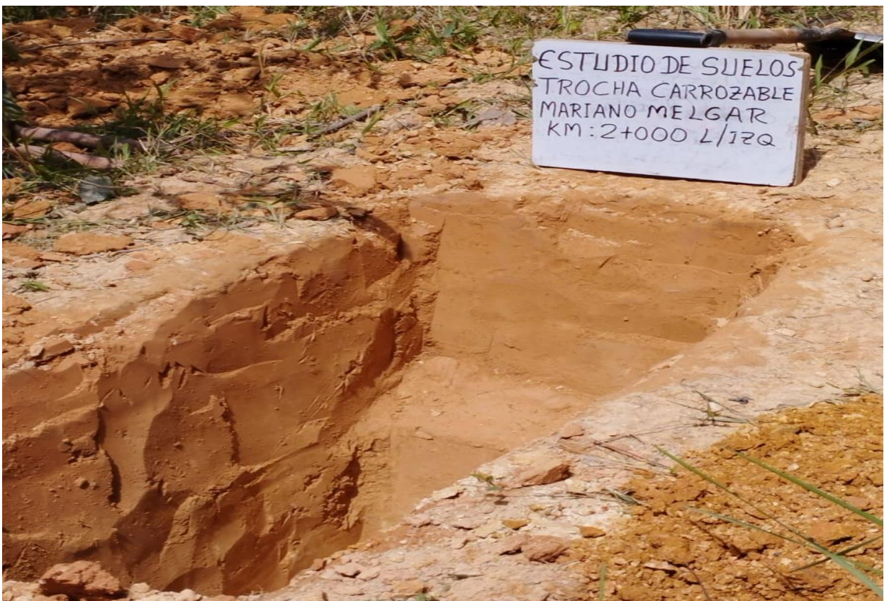
Ilustración 104, Calicata N°03 progresiva 2+000 elaboración propia.
