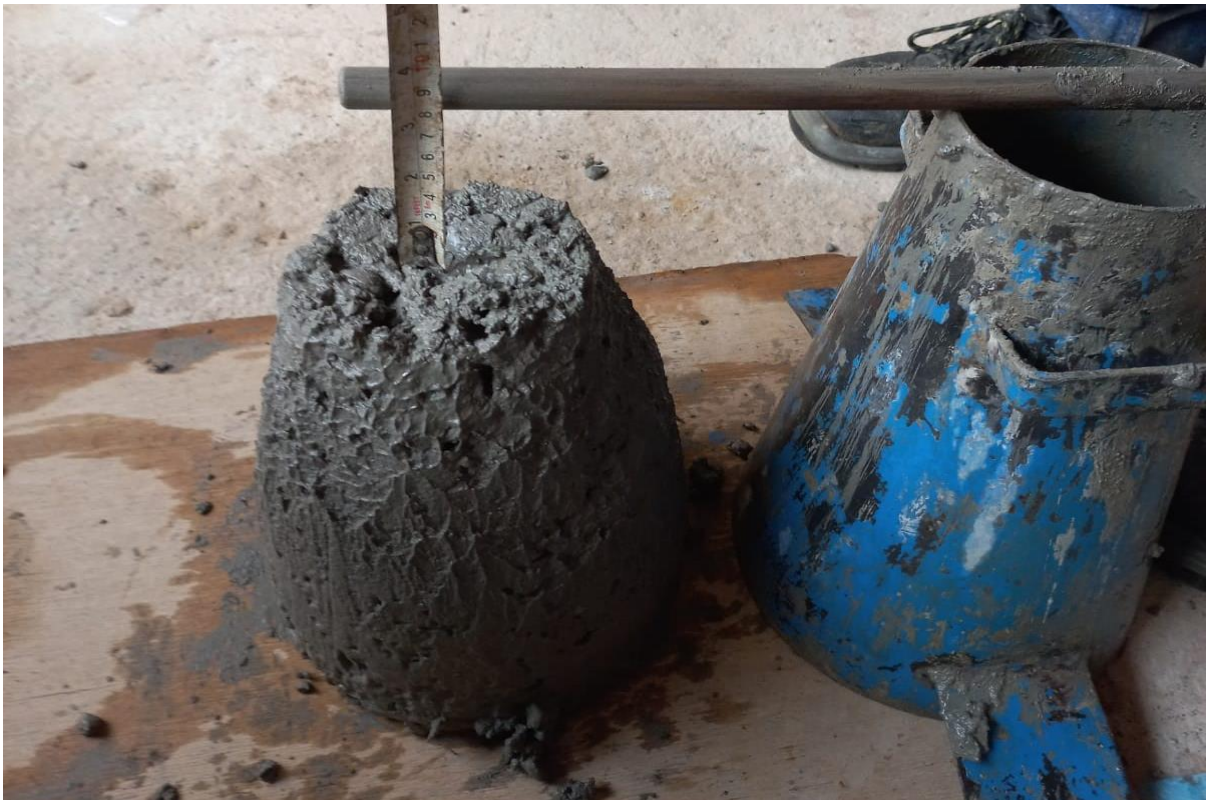
Ilustración 123, verificación de SLUMP elaboración propia.
