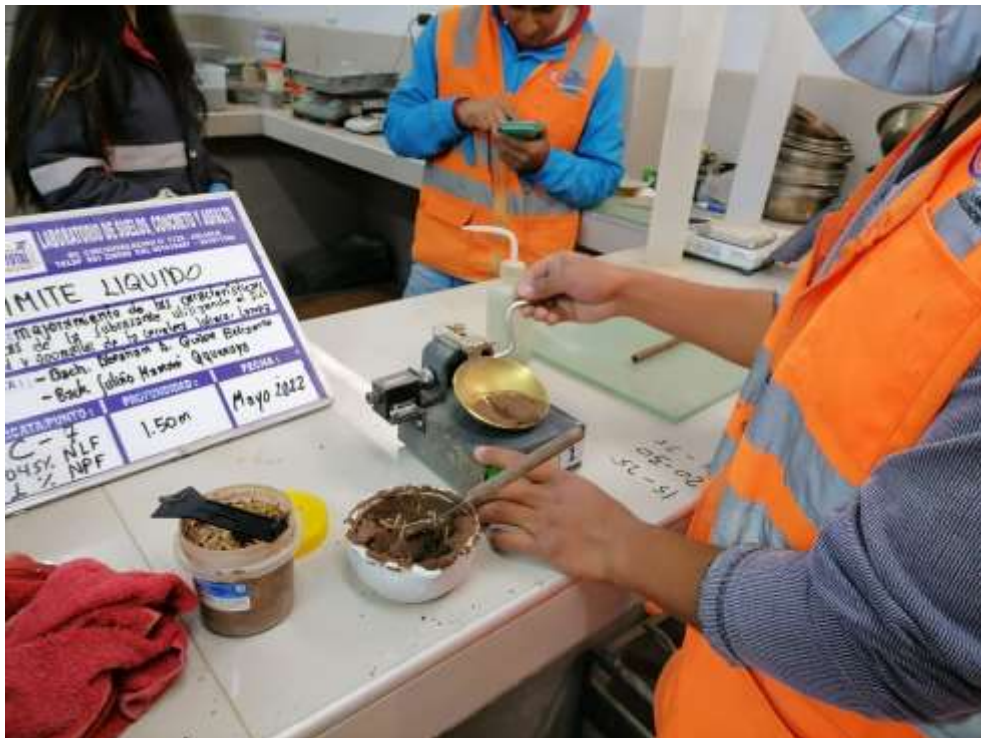
Fotografía 20. Conteo de golpes con la cuchara de Casagrande
