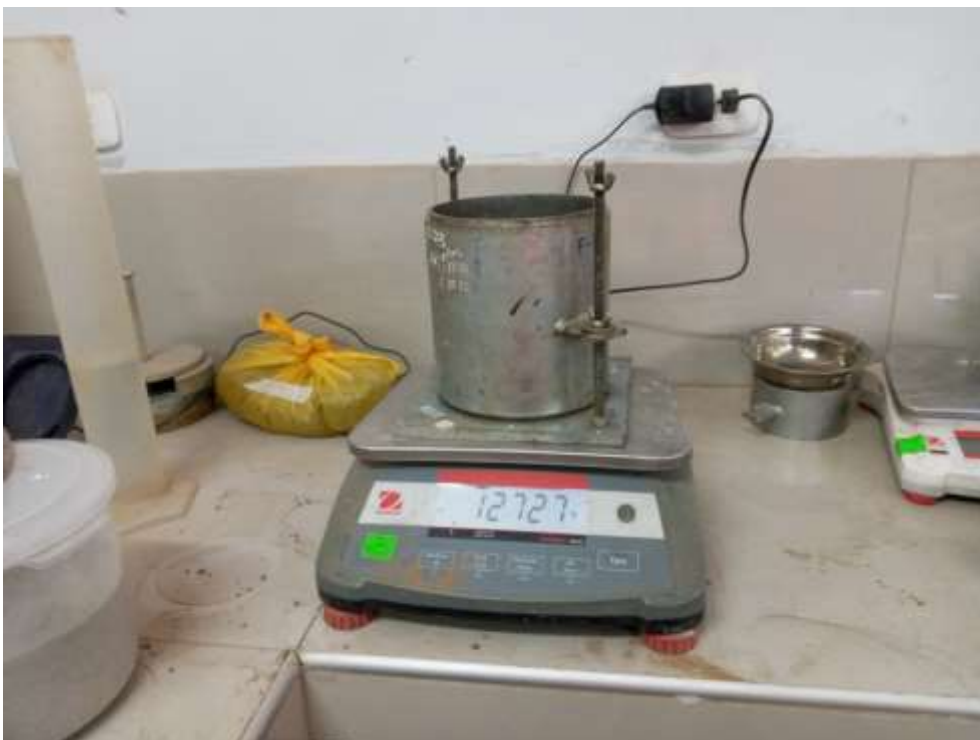
Fotografía 57. Peso del cilindro de CBR vacío
