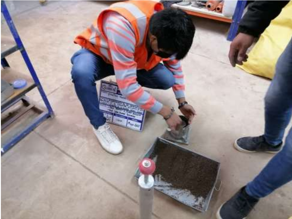
Fotografía 51. Capa de la muestra colocada en el cilindro
