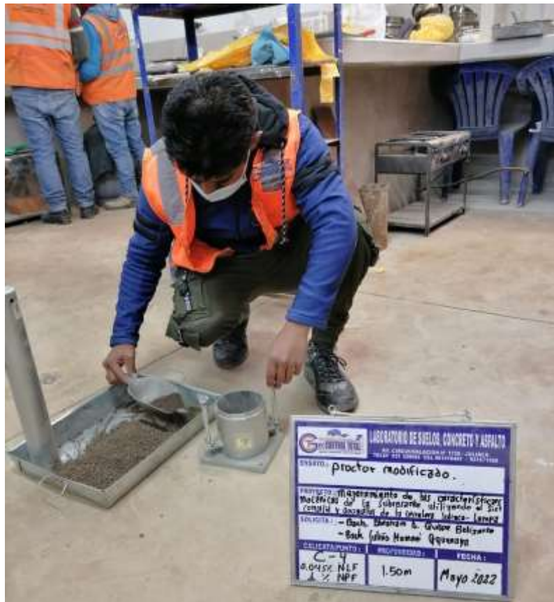
Fotografía 53. Mezcla de la muestra de la calicata 4 con los aditivos del consolidador
