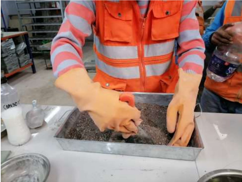
Fotografía 43. Mezcla del Solidry en la muestra
