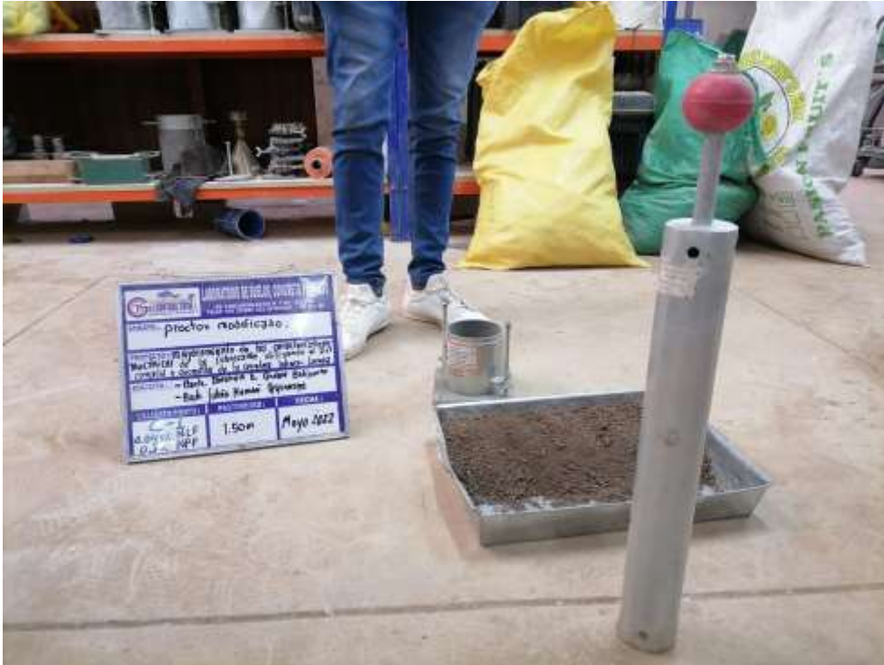
Fotografía 49. Inicio del ensayo de Proctor modificado
