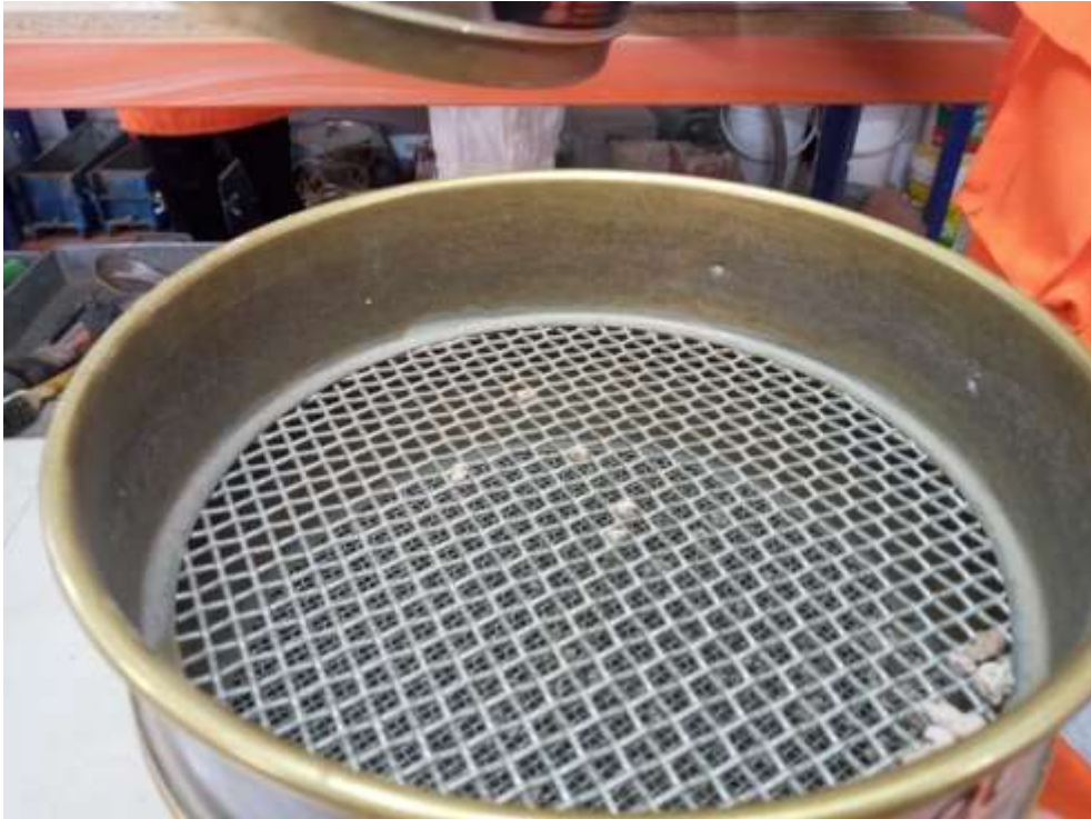
Fotografía 11. Material retenido en los distintos tamices
