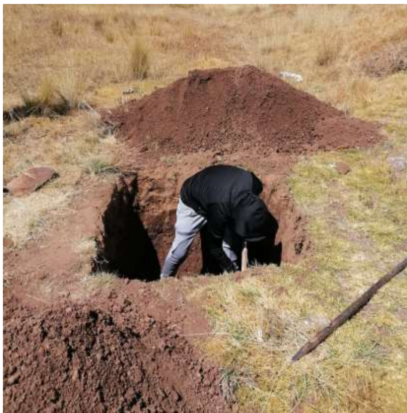
Fotografía 9. Extracción del material para laboratorio
