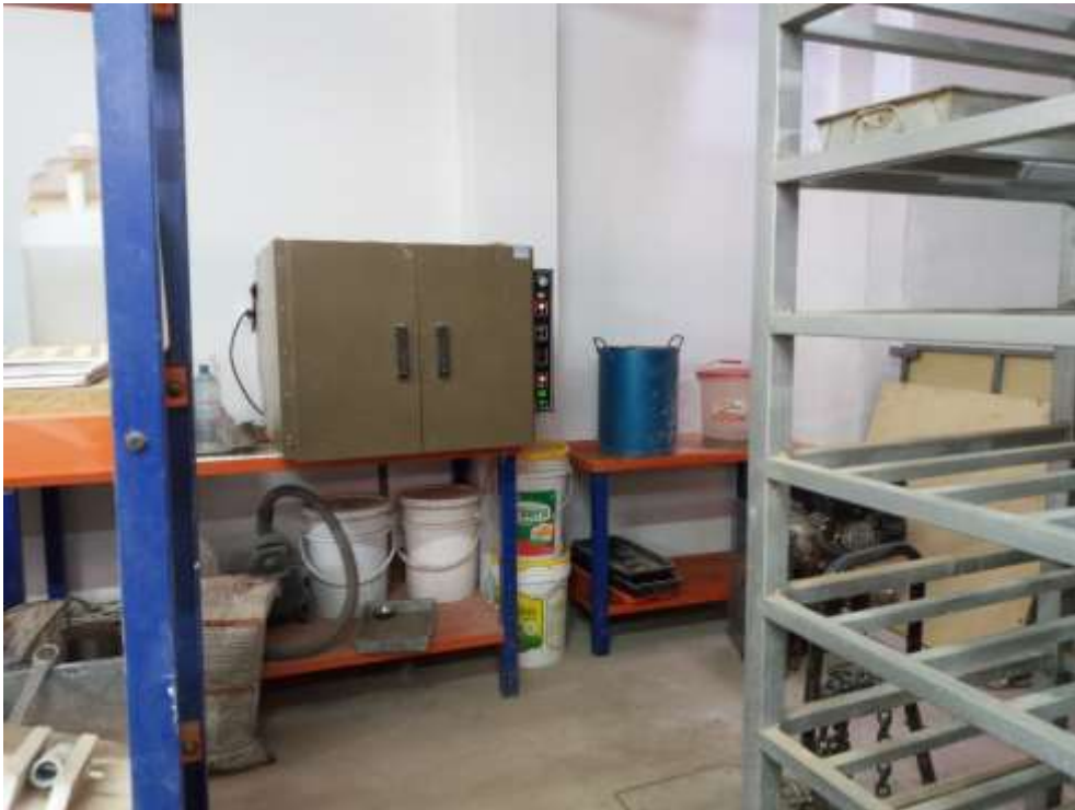
Fotografía 25. Secado de las muestras en el horno a 110 grados
