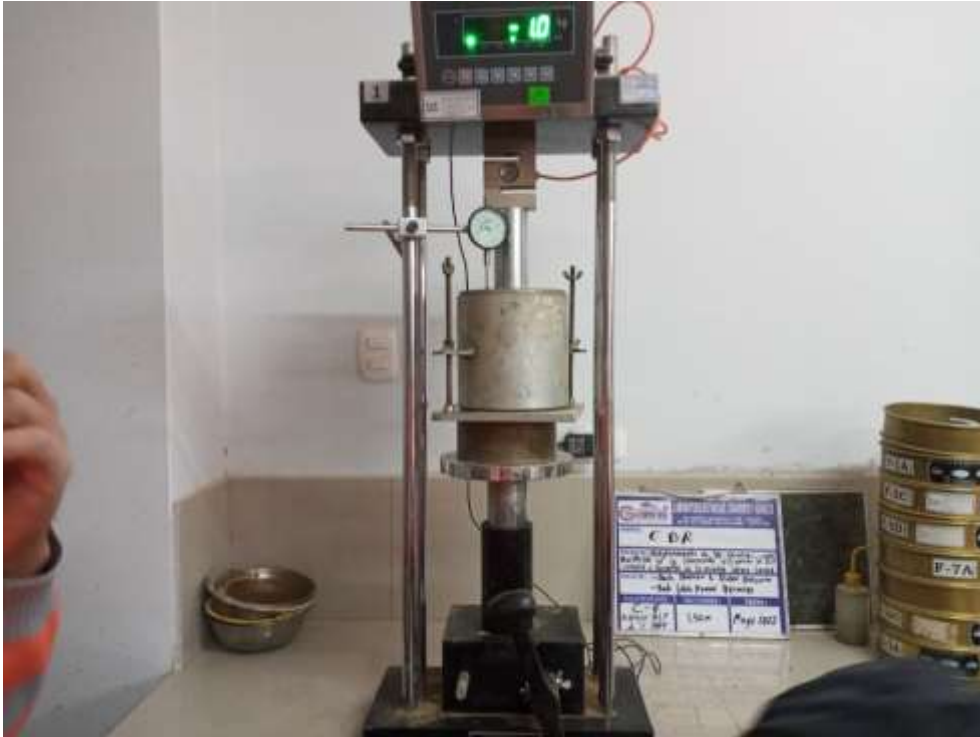
Fotografía 63. Aplicación de la carga de 44N en los moldes de CBR
