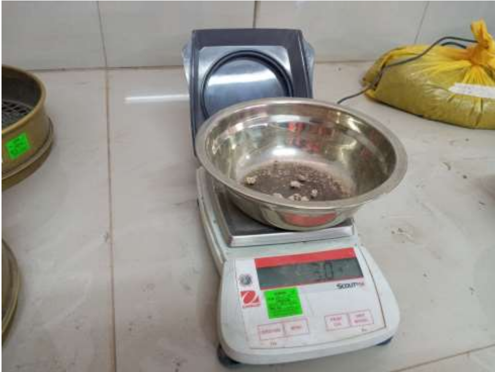
Fotografía 15. Registro del peso retenido de los tamices
