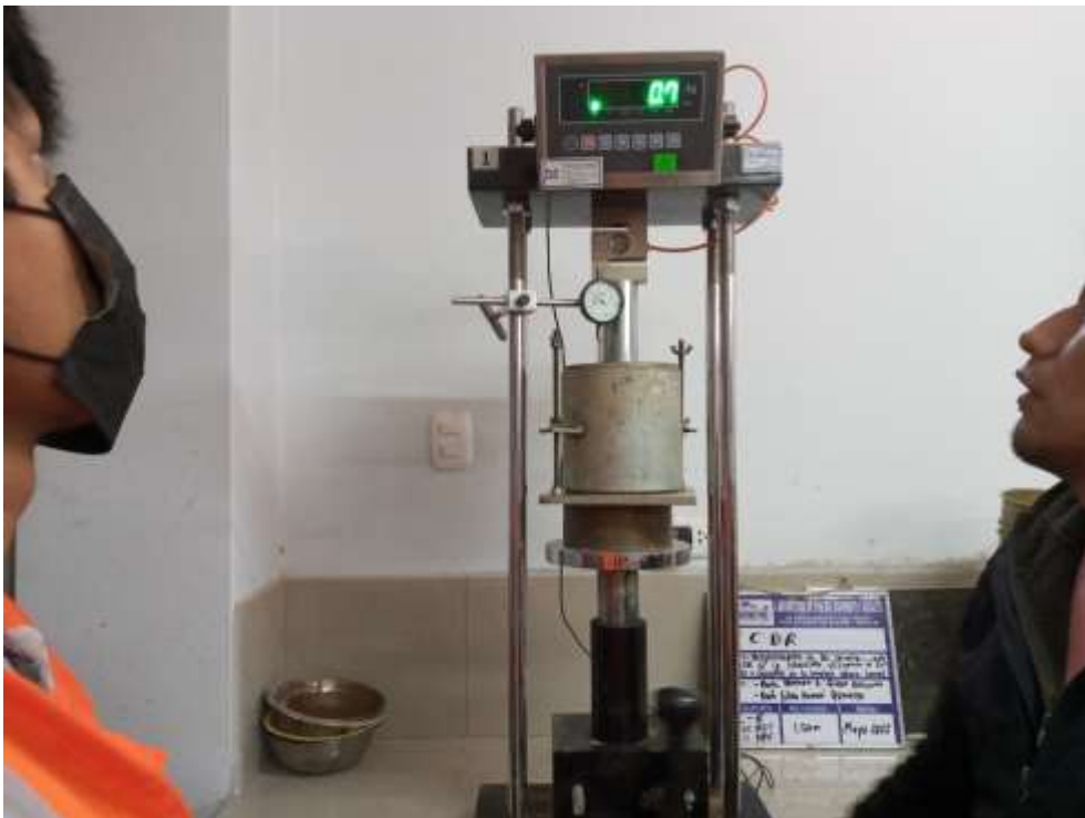
Fotografía 64. Aplicación de la carga con una velocidad de 0.05 de pulgada por minuto
