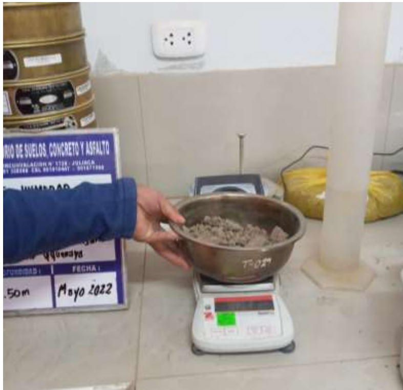
Fotografía 29. Peso de la muestra después del secado en el horno
