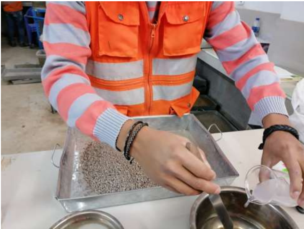
Fotografía 40. Colocación del Consolid 444 dosificado en un recipiente
