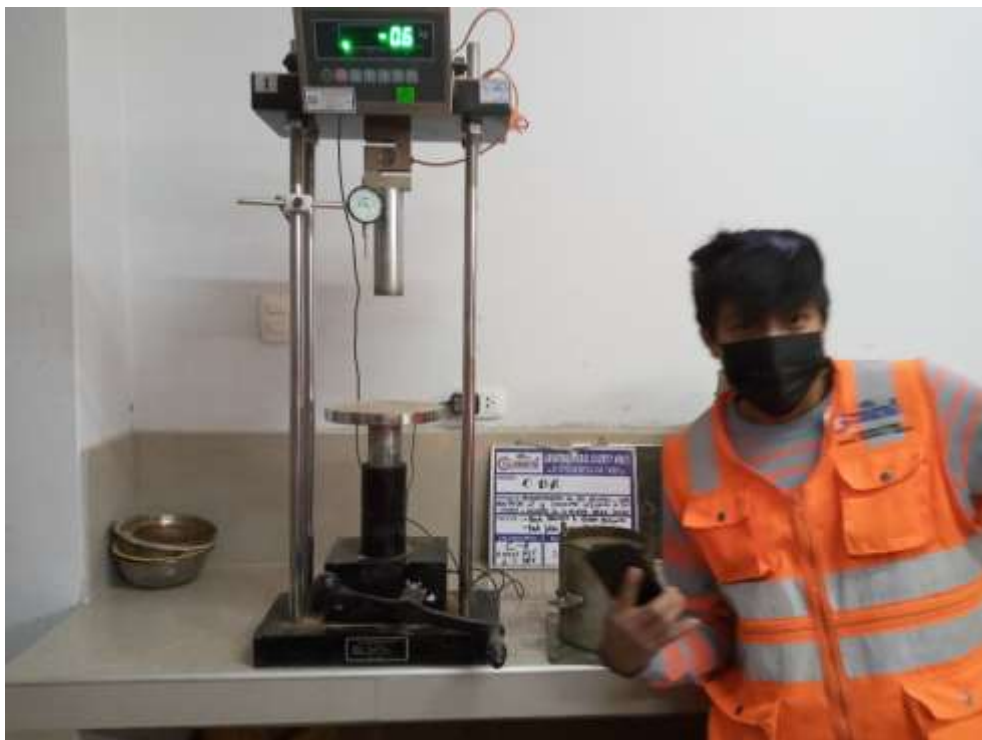
Fotografía 62. Dispositivo de carga y pisón de penetración para el ensayo de CBR
