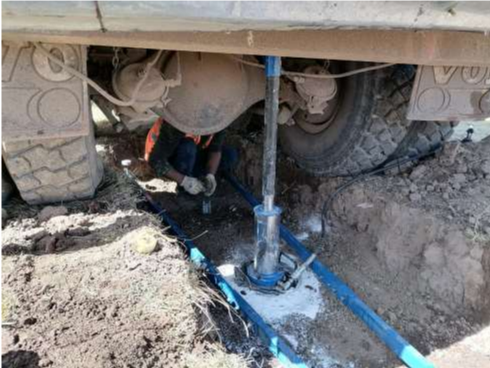
Fotografía 77. Aplicación de la carga con incrementos a cada 15 minutos
