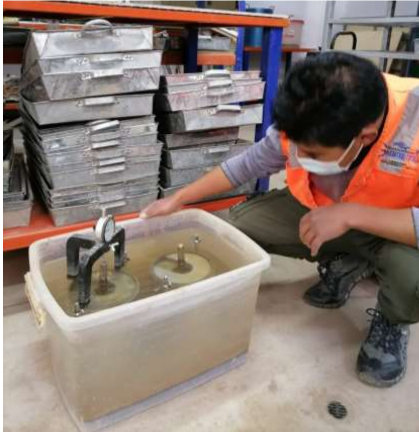
Fotografía 61. Inmersión de los moldes en agua durante 4 días
