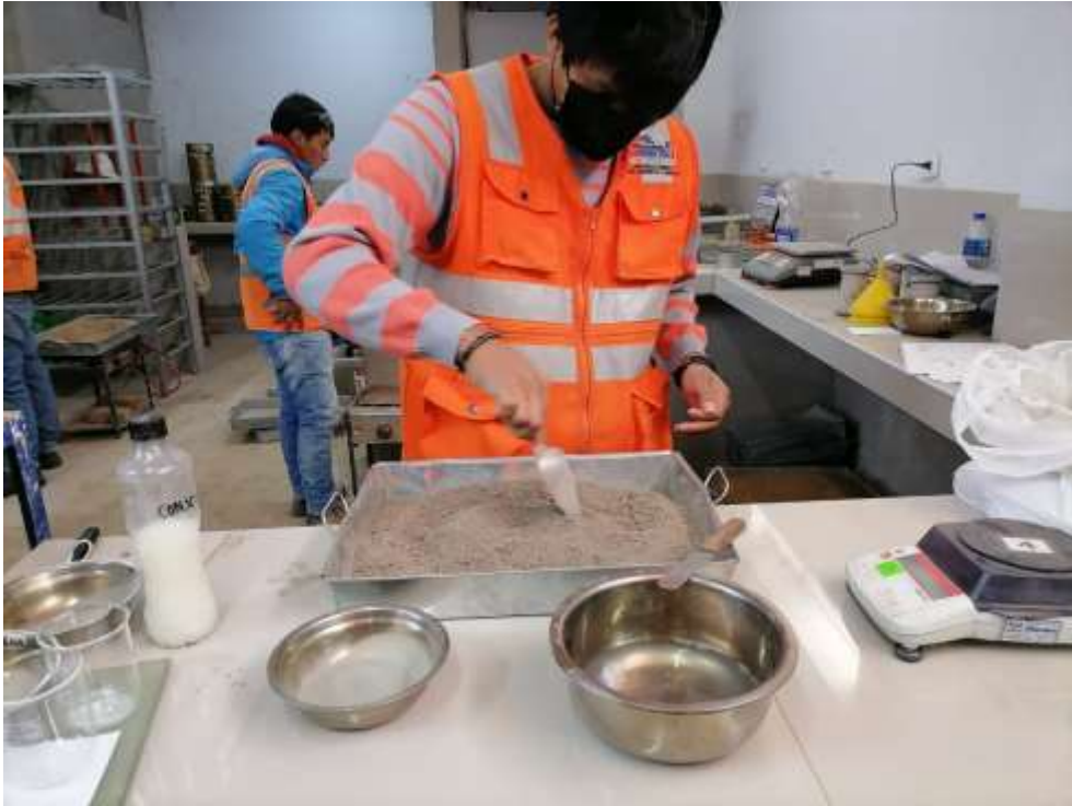
Fotografía 39. Preparación de la muestra para la adición del sistema Consolid
