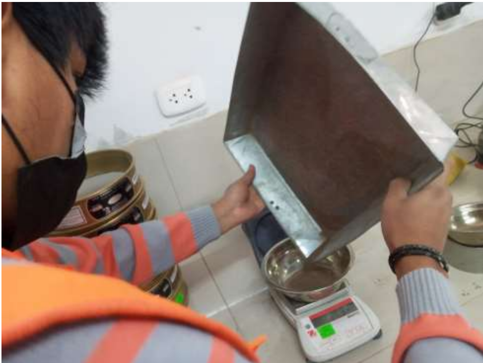
Fotografía 14. Proceso de pesado del material retenido en los diferentes tamices
