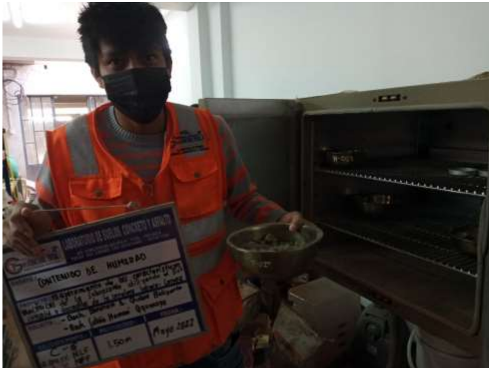
Fotografía 28. Secado de las muestras en el horno de 110°C por 24 horas
