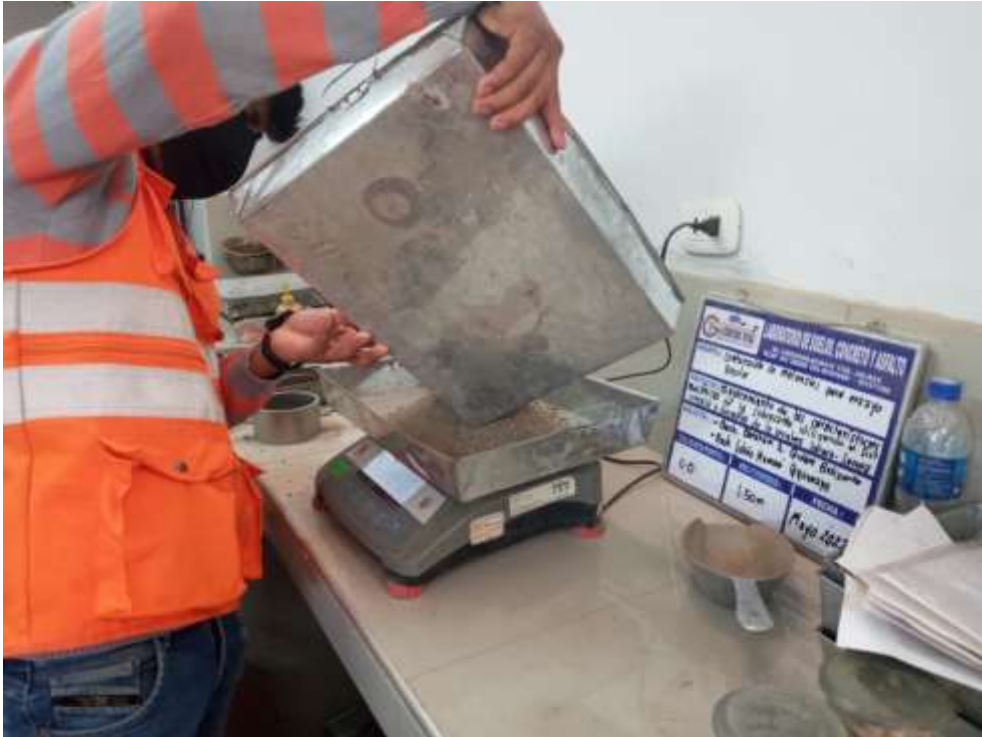
Fotografía 37. Peso de la muestra para el ensayo Proctor
