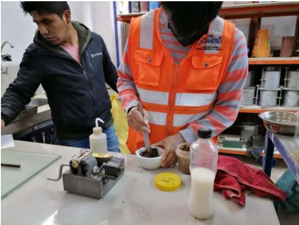
Fotografía 18. Humectación de la muestra en el ensayo de límite líquido
