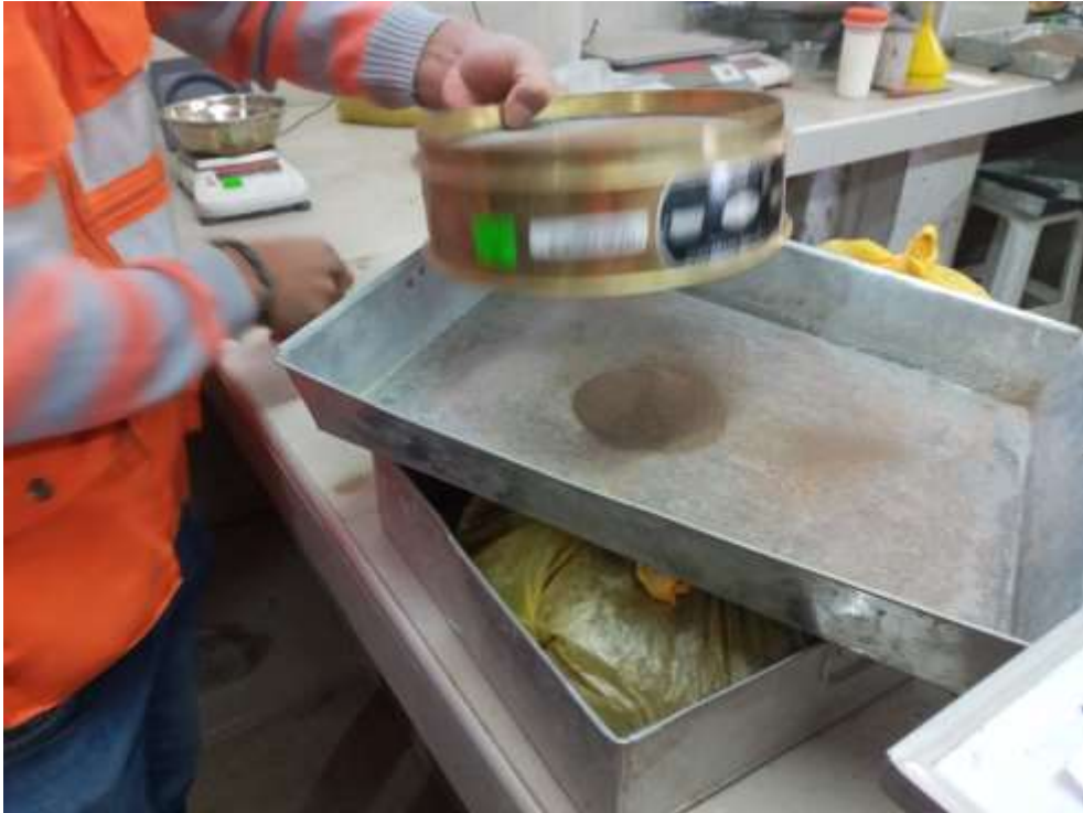
Fotografía 13. Material Fondo (material pasante al tamiz N°200)
