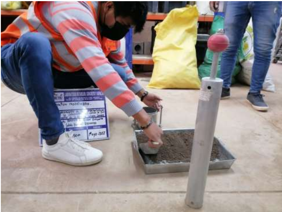
Fotografía 50. Separación de la muestra en 5 capas
