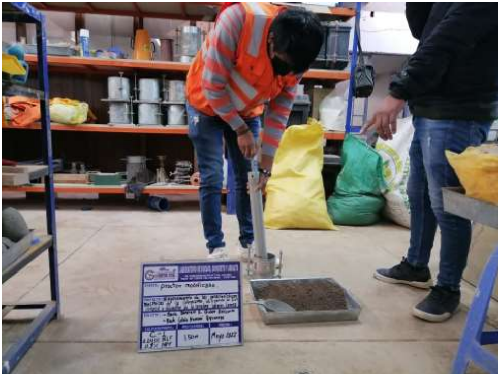
Fotografía 52. Inicio de los 56 golpes por cada capa del ensayo Proctor modificado
