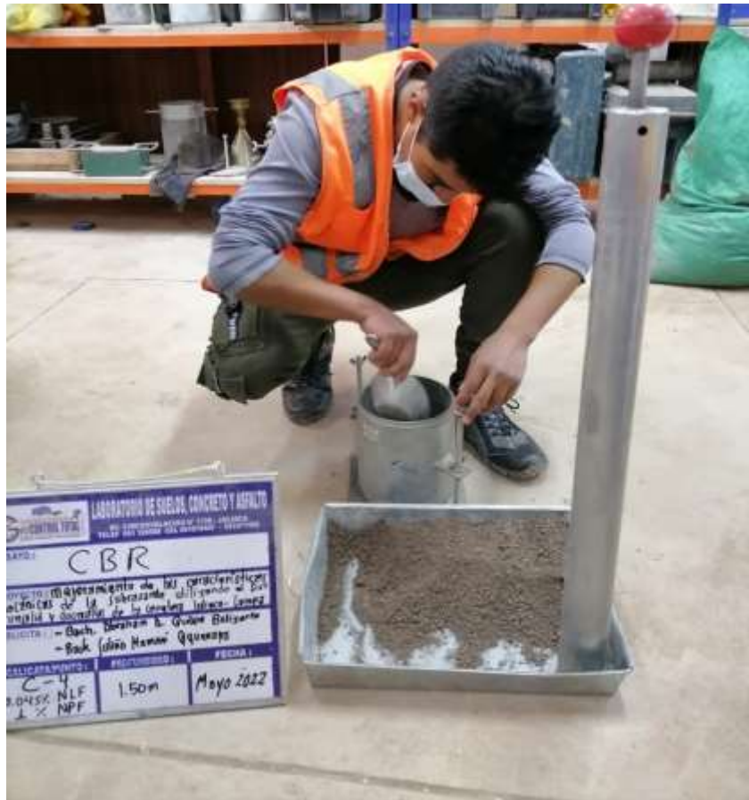
Fotografía 58. Peso del molde de CBR vacío
