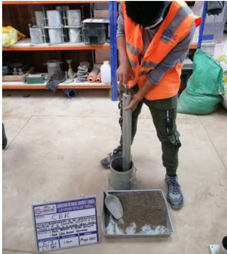
Fotografía 60. Inicio de la compactación CBR a 10, 25 y 56 golpes por capa
