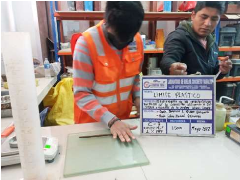
Fotografía 22. Inicio del ensayo de límite plástico
