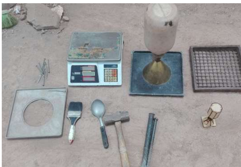
Figura 7. Instrumentos del ensayo de densidad de arena
