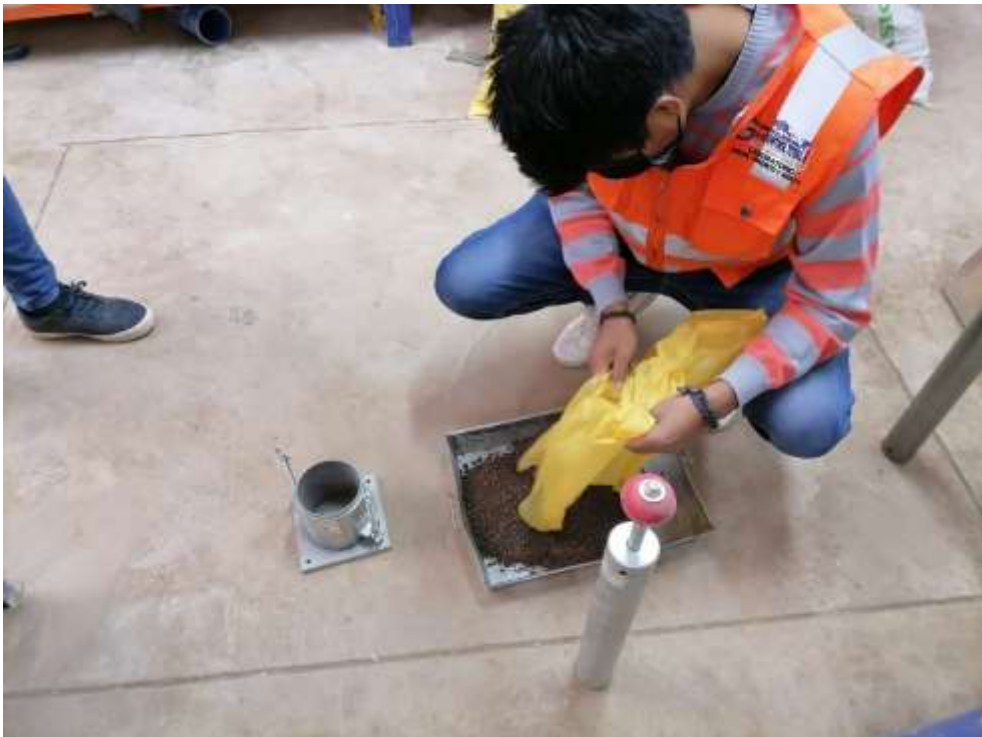
Fotografía 48. colocación de la muestra con el aditivo en la bandeja
