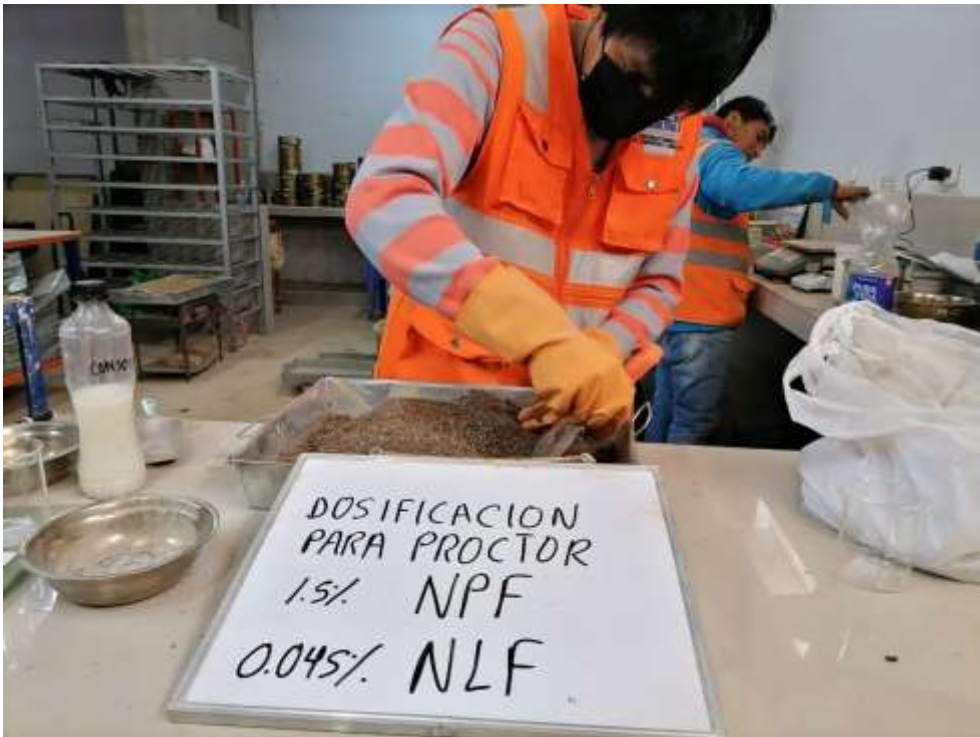
Fotografía 46. Otras dosificaciones del sistema consolid en la muestra de suelo
