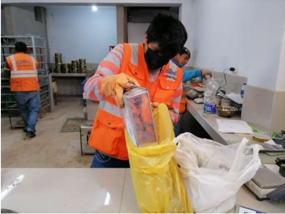
Fotografía 47. colocación de la muestra con el aditivo consolid en bolsas
