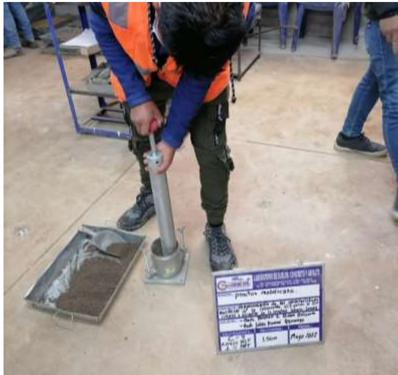
Fotografía 54. 56 golpes por cada capa del ensayo Proctor en la muestra de la C-4
