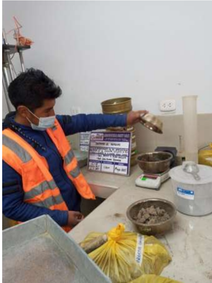
Fotografía 27. Registro del suelo con la humedad natural
