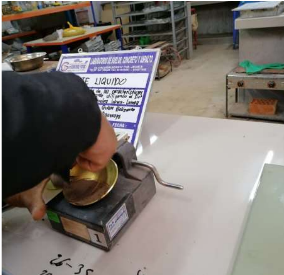
Fotografía 19. Separación de la muestra en la cuchara de Casagrande
