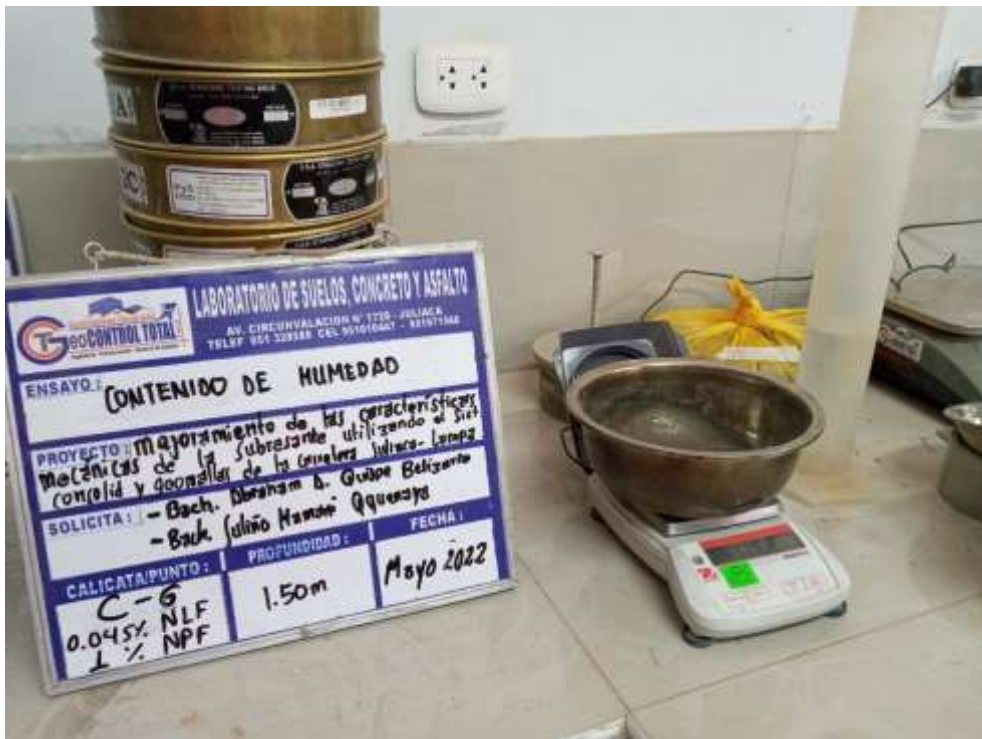
Fotografía 26. Inicio del ensayo de contenido de humedad
