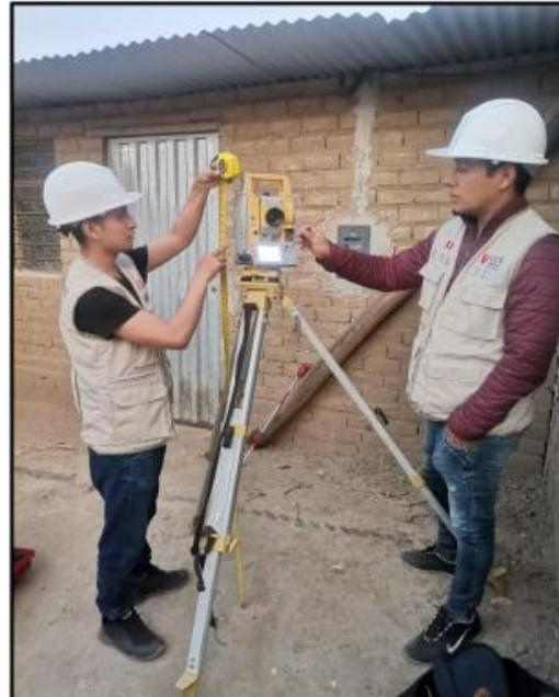
N°2. Determinando la altura de la estación total para su configuración
