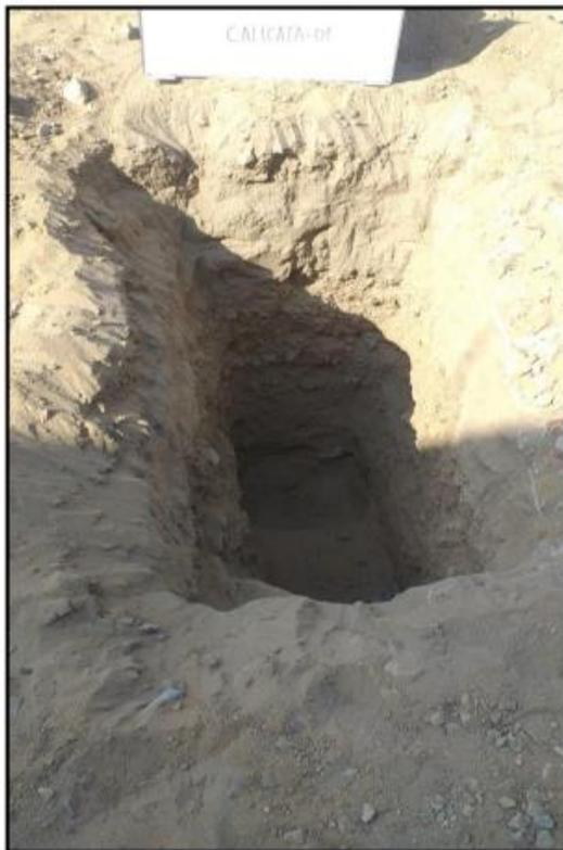
**N°10.** Excavación para la extracción de las muestras
