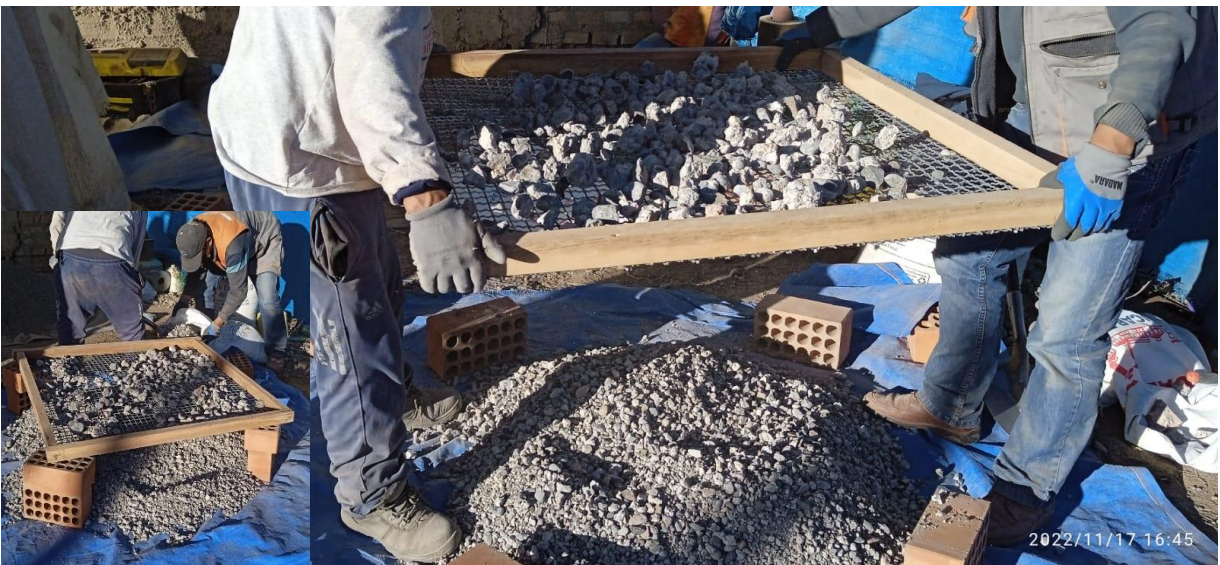
Fotografía 4. Zarandeo de agregado reciclado de concreto.
