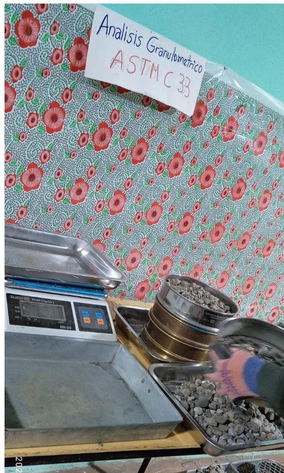
Fotografía 6. Zarandeo de agregado reciclado de concreto.
