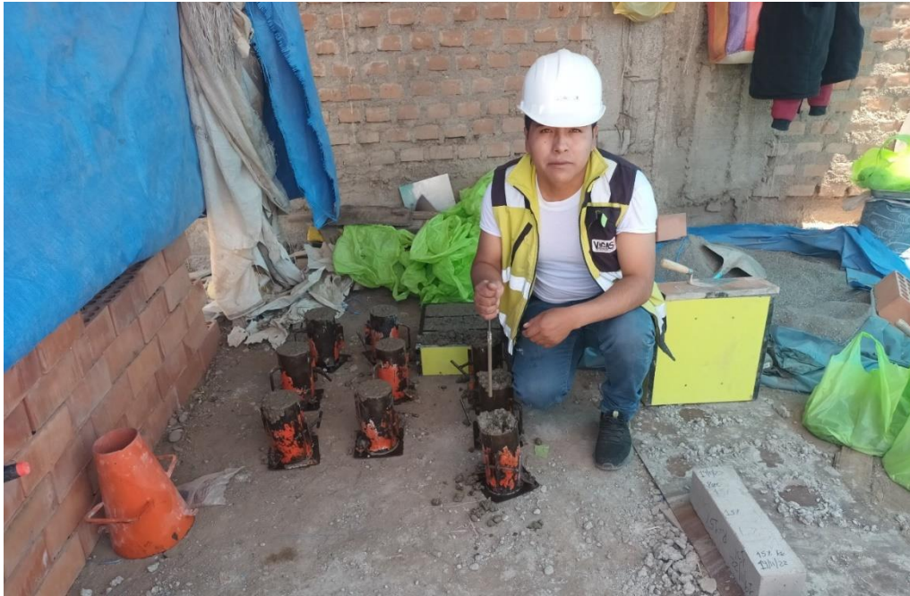
Fotografía 11. Envarillado de mezcla de molde de briquetas.
