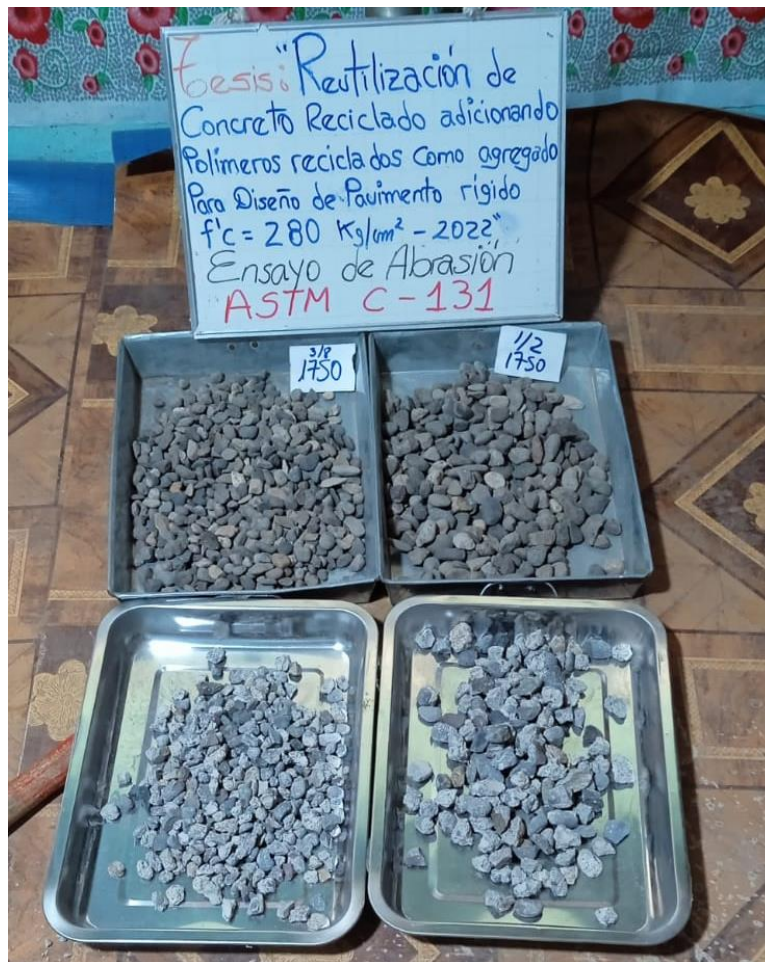
Fotografía 8. Zarandeo de agregado reciclado de concreto.
