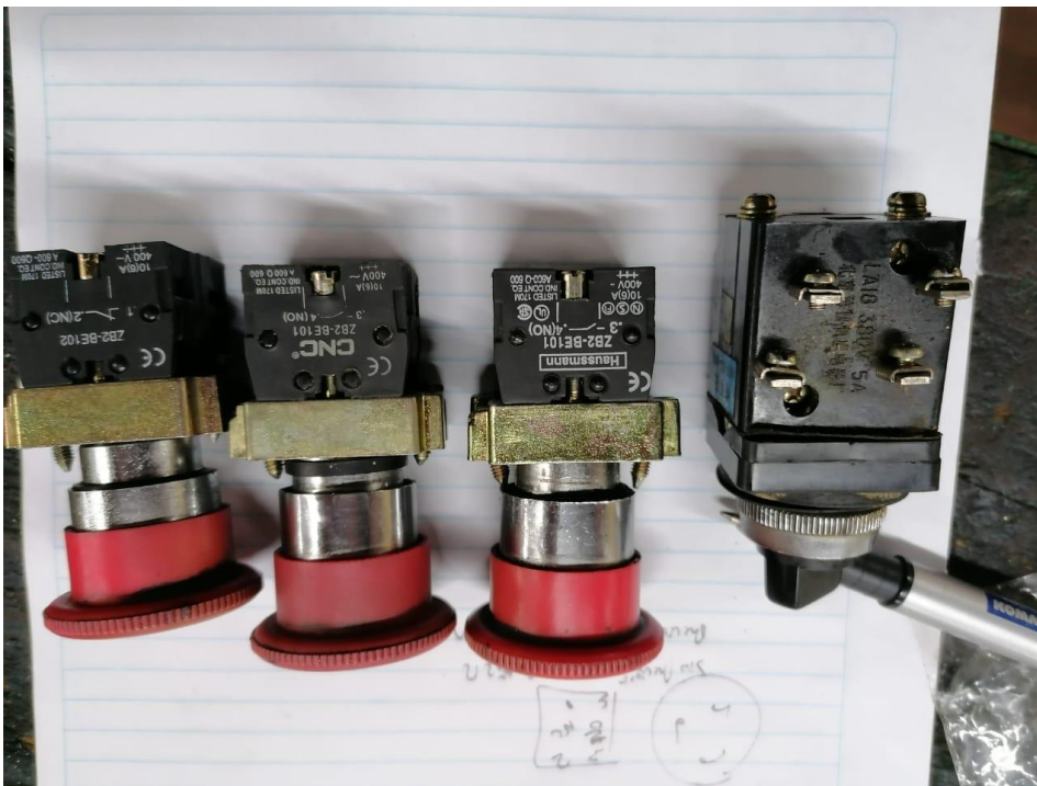
Figura 2: Pulsadores de emergencia y selector de velocidad de giro
