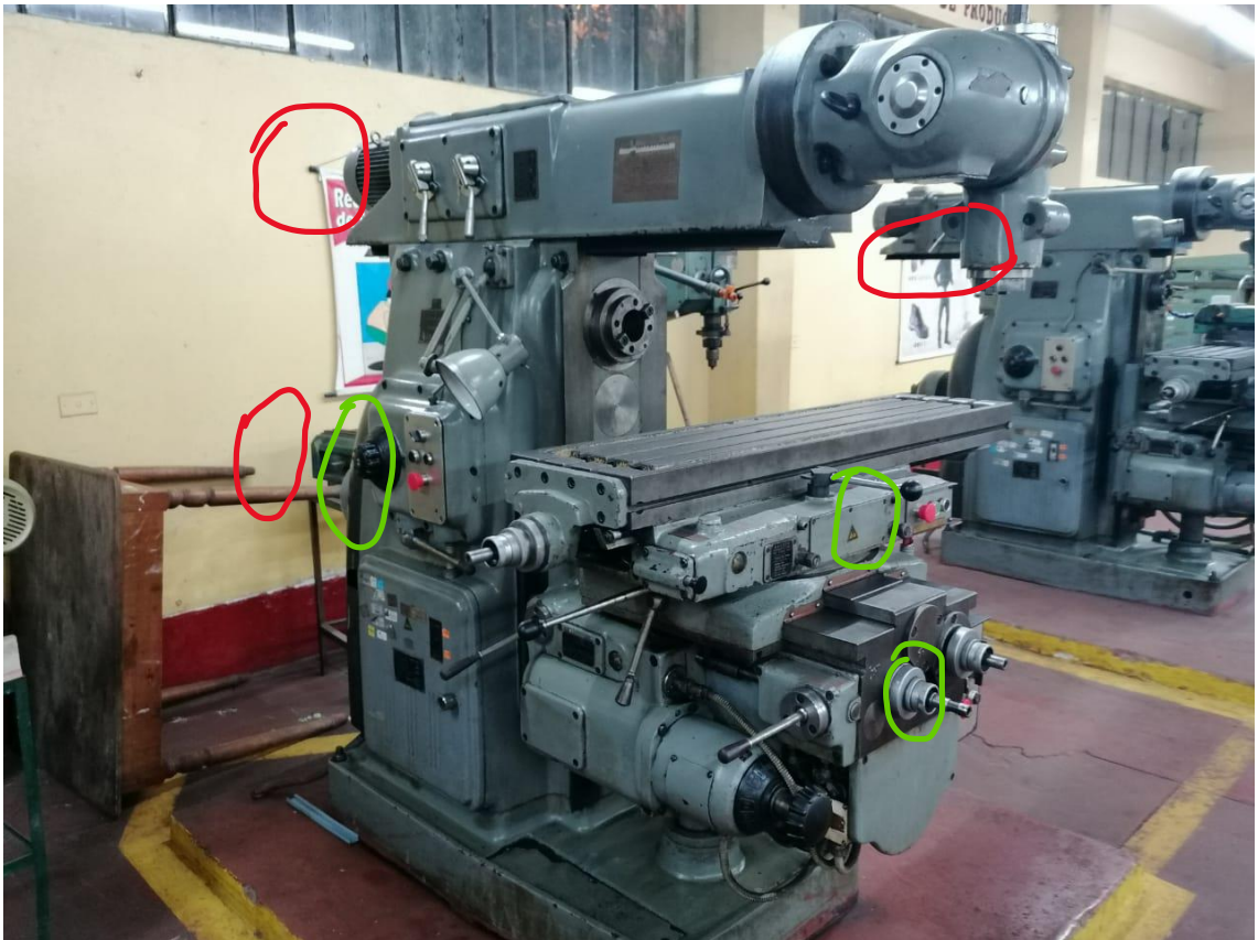
Figura 1b: Maquina fresadora universal N°4, Inoperativa con señalización de posibles fallas
