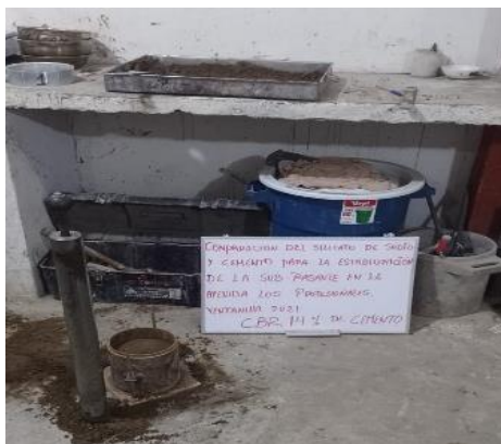
Foto 17: Ensayo de relación de soporte de california, 4% de cemento.
