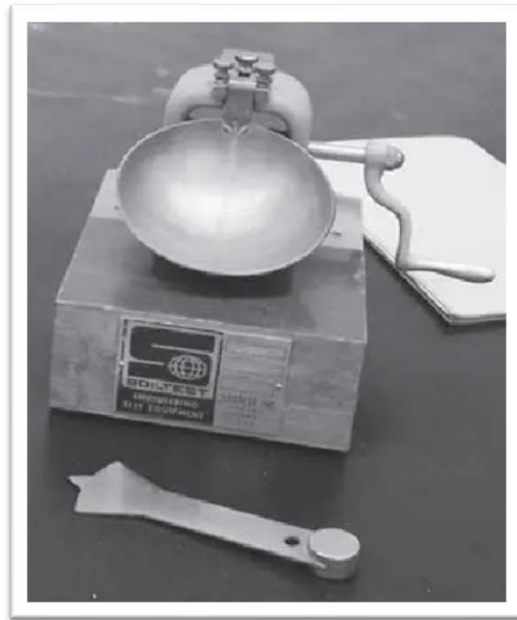
Figura 5. Se señala la utilización del dispositivo de límite líquido y el utensilio de ranurado Fuente: Fundamentos de ingeniería geotécnica
