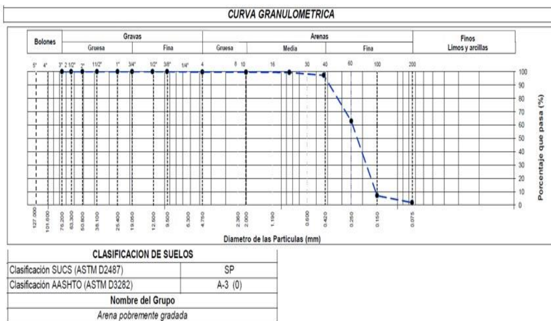
Figura 22. Análisis Granulométrico por tamizado (C-3)
