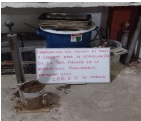
Foto 15: Ensayo de compactación para determinar la máxima densidad seca y óptimo contenido de humedad. Al 6% de cemento.
