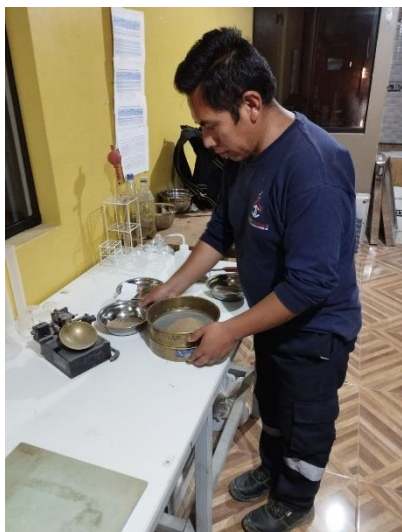
Figura 27. Ensayo de óptimo contenido de humedad
