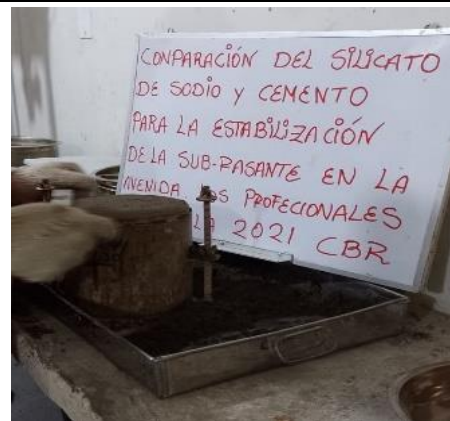
Foto 18: Ensayo de relación de soporte de california CBR.
