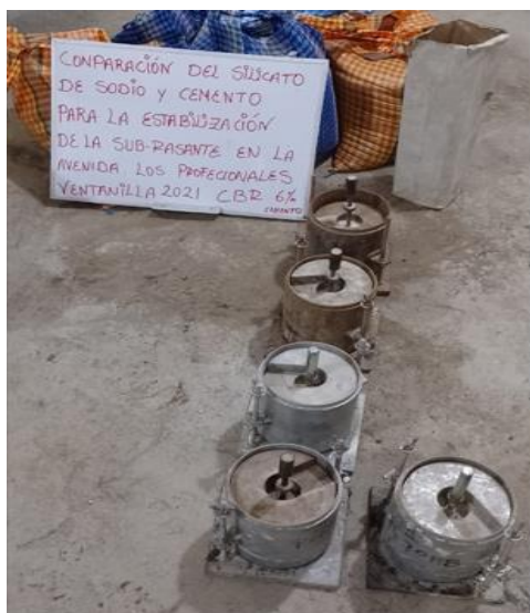
Figura 33. Moldes de CBR con adición del 6% de cemento.
