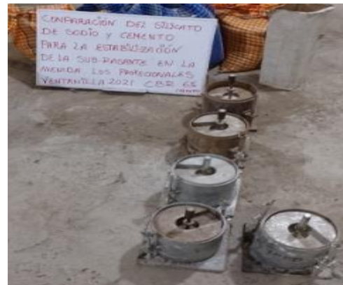
Foto 16: Ensayo de relación de soporte de california, 6% de cemento.
