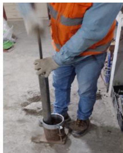
Figura 31. Ensayo de Proctor modificado
