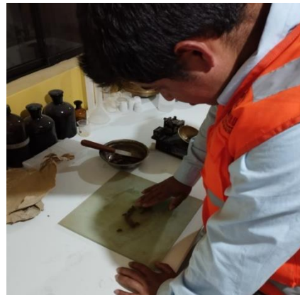
Foto 24: ensayo de Limite plástico
