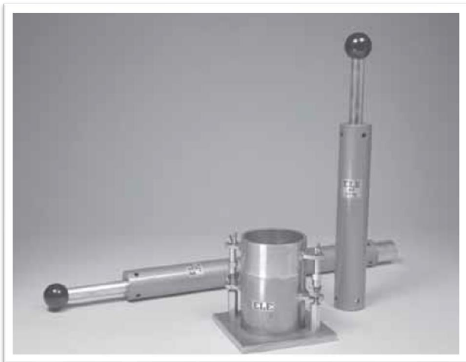
Figura 9. Se observa los martillos utilizados para las pruebas de Proctor estándar y modificado. Extraído de ELE International
