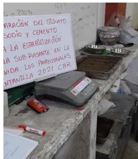
Figura 34. Ensayo de CBR con la suma de silicato de sodio y cemento.
