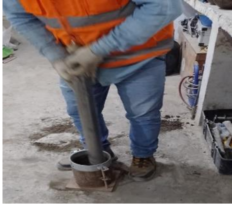
Foto 19: Ensayo de relación de soporte de california golpes.
