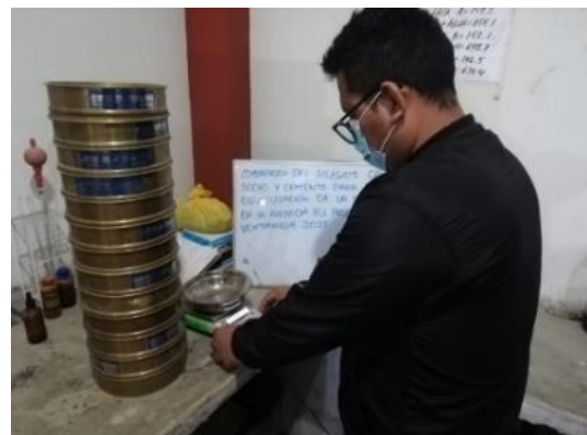
Foto12: Análisis granulométrico del suelo para determinar su clasificación de suelo.
