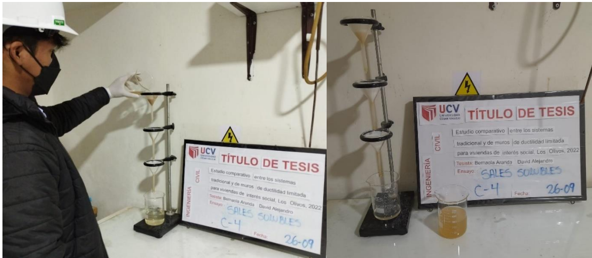
Figura 216 Ensayo de sales solubles, proceso de colocación de agua destilada y agitación.
