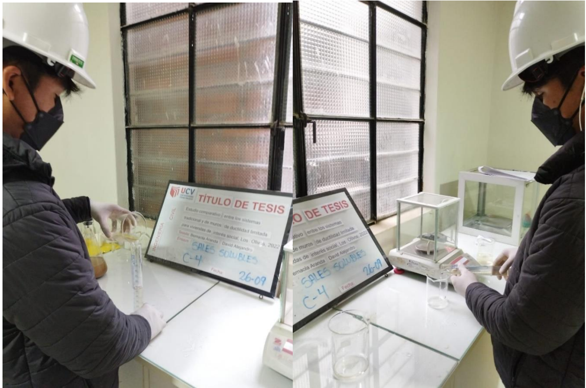
Figura 214 Ensayo de sales solubles, proceso de colocación de agua destilada.
