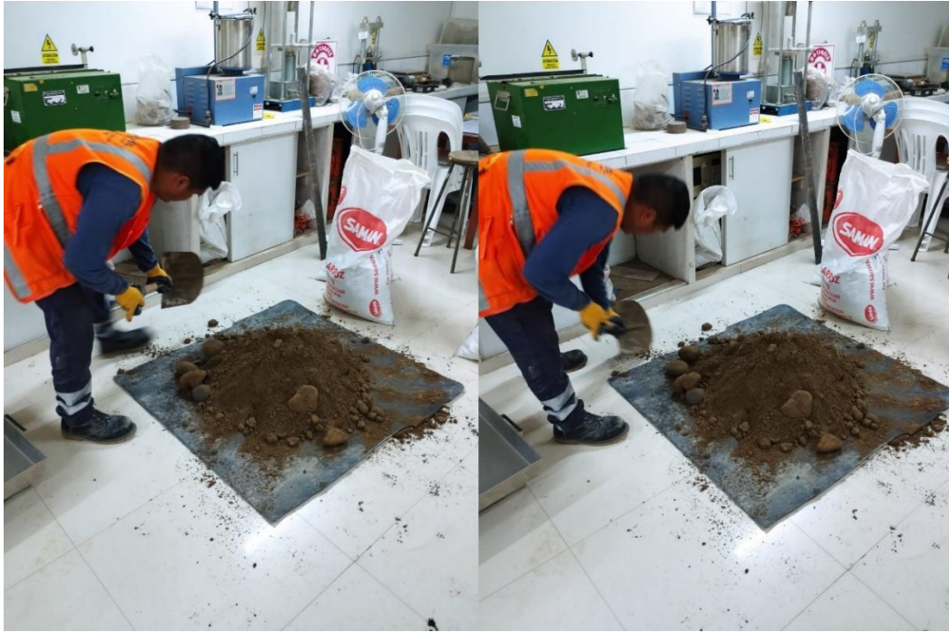
Figura 203 Proceso de homogenización de la muestra.
