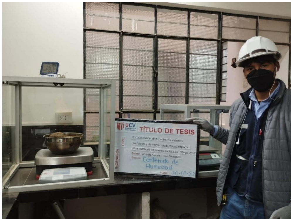
Figura 204 Pesado de la muestra para hallar el contenido de humedad.
