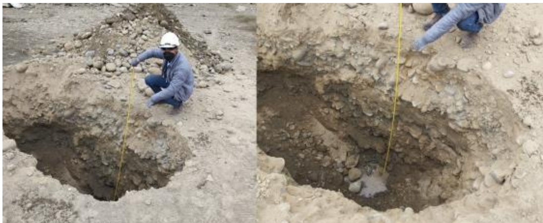
Figura 26 Registro de presencia de napa freática a profundidad 2,10m de la C-1.
