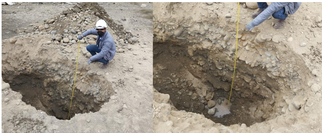
Figura 198 Registro de presencia de napa freática a profundidad 2,10m de la C-1.
