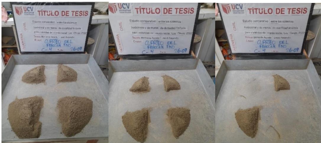
Figura 208 Cuarteo para obtención de muestra representativa m-2 C-2.
