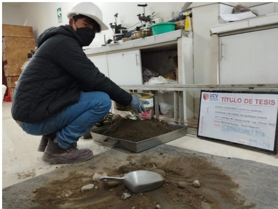
Figura 206 Separación de grava y material fino.
