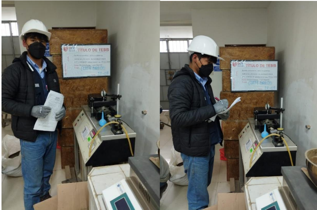
Figura 212 Ensayo de Corte Directo.
