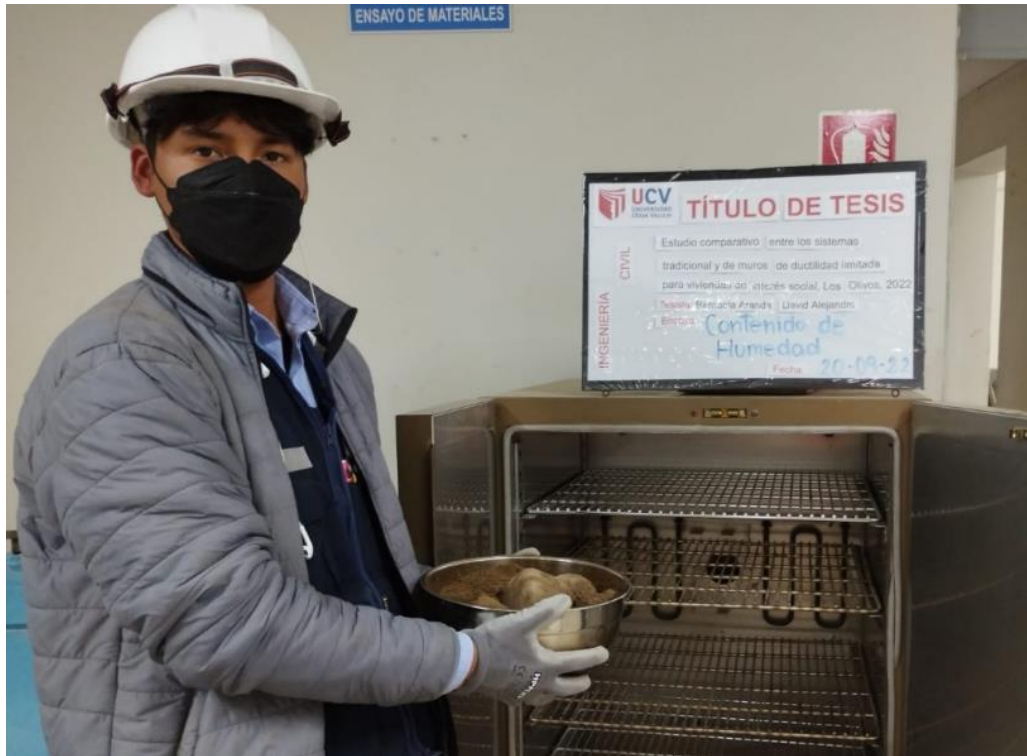
Figura 205 Imagen representativa de colocación de la muestra en el horno.
