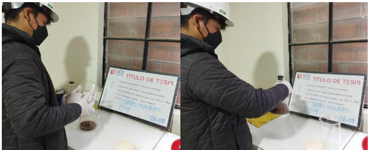
Figura 215 Ensayo de sales solubles, proceso de colocación de agua destilada y agitación.
