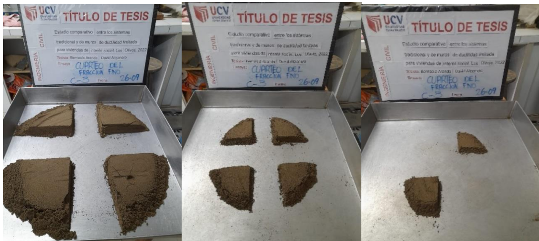
Figura 207 Cuarteo para obtención de muestra representativa m-1 C-2.
