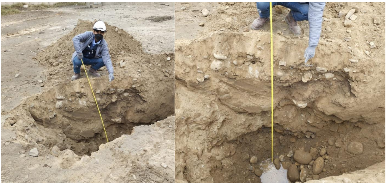
Figura 200 Registro de presencia de napa freática a profundidad 2,10m de la C-2. Fuente: Propia, Tomada (19/09/2022- 10:44 a.m.)
