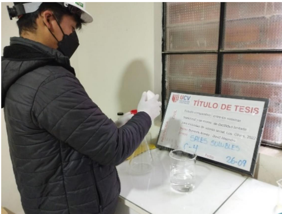
Figura 213 Ensayo de sales solubles, proceso de colocación de muestra.
