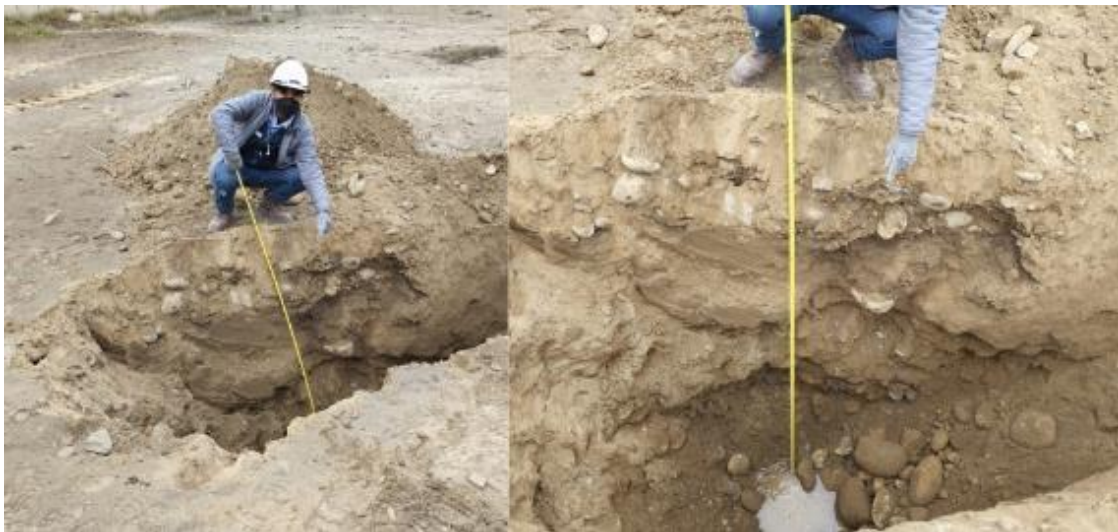
Figura 28 Registro de presencia de napa freática a profundidad 2,10m de la C-2.
