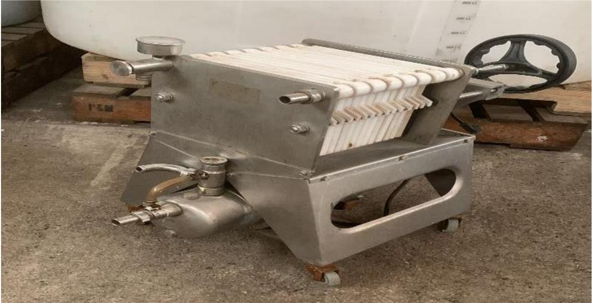
**Figura 8: Máquina filtradora con membranas**
