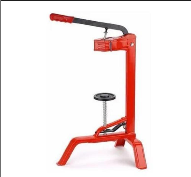
**Figura 10: Máquina encorchadora**
