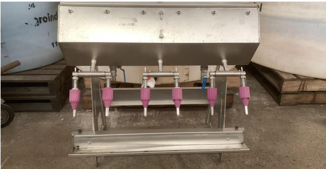
**Figura 9: Máquina dispensadora de llenado de botellas**
