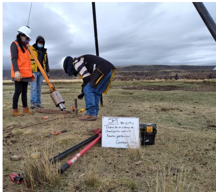
Fotografía 16. Martillo de 140lb con altura de golpeo 30" para la realización del ensayo SPT in situ.
