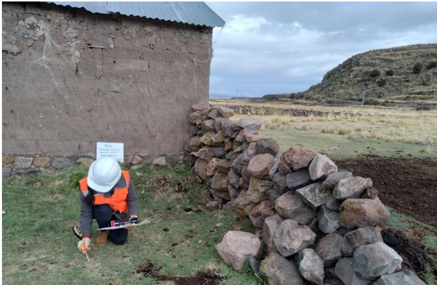
Fotografía 8. Registro de temperatura del suelo.
