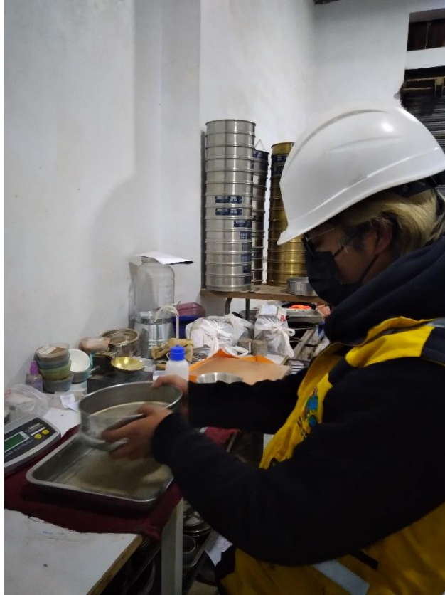
Fotografía 27. En laboratorio, análisis granulométrico por tamizado.
