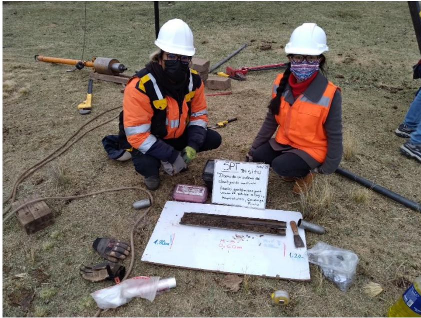
Fotografía 23. Extracción de tercera muestra.
