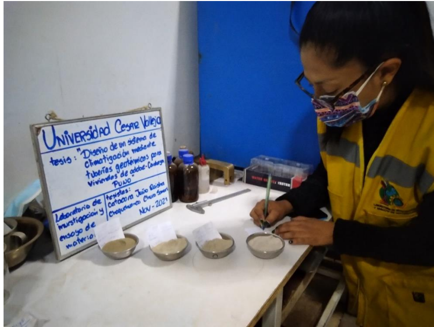
Fotografía 33. En laboratorio, registro datos de contenido de humedad.
