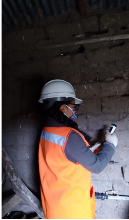
Fotografía 7. Registro de temperatura ambiental dentro de la vivienda.
