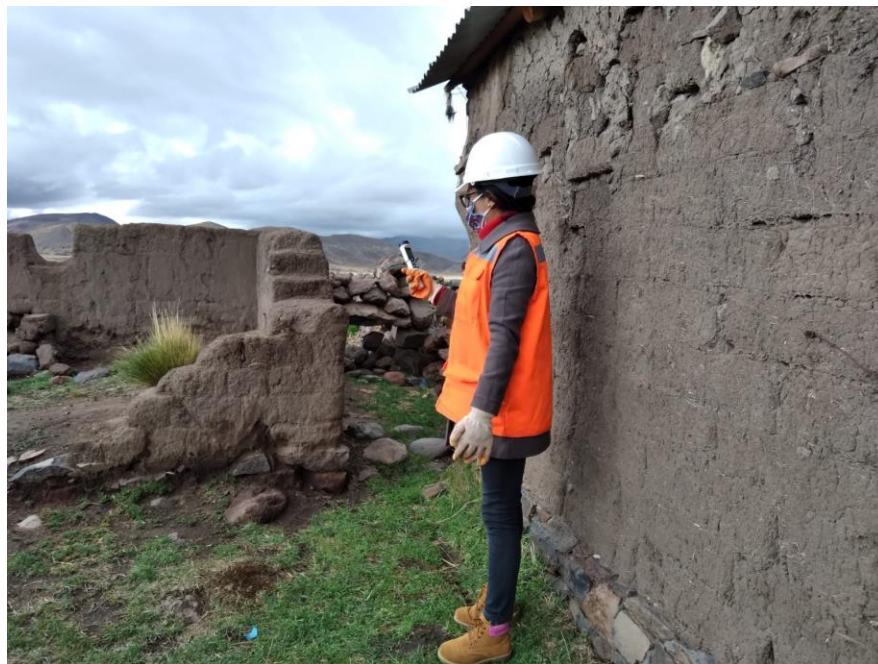
Fotografía 6. Registro de temperatura ambiental fuera de la vivienda.
