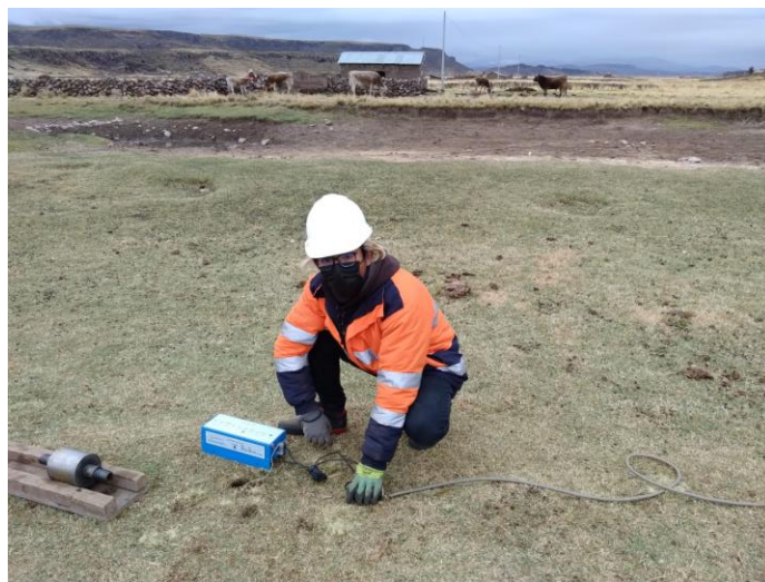
Fotografía 24. Registro de la temperatura del subsuelo a 2m de profundidad.
