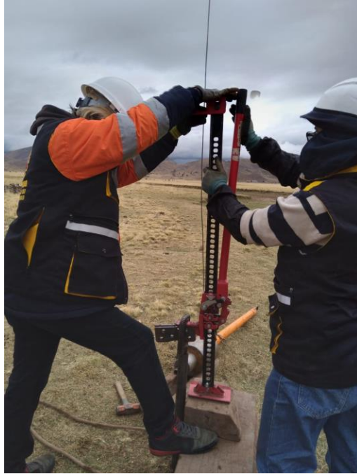
Fotografía 19. Manejo de instrumentos para realización de ensayo SPT in situ.
