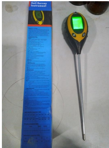
Fotografía 3. Termómetro medición de temperatura de suelo. Certificado y calibrado.
