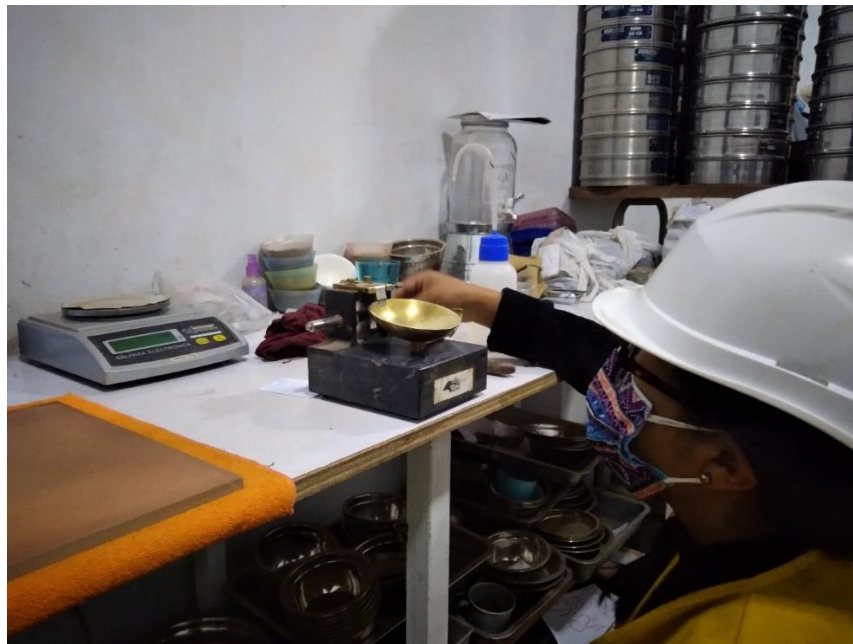
Fotografía 28. En laboratorio, calibración de la cuchara de Casa grande para límites líquidos.
