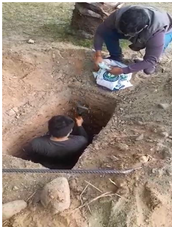
Figura 1. Excavación de una calicata de la cual se obtienen las muestras para realizar los ensayos correspondientes en el laboratorio
