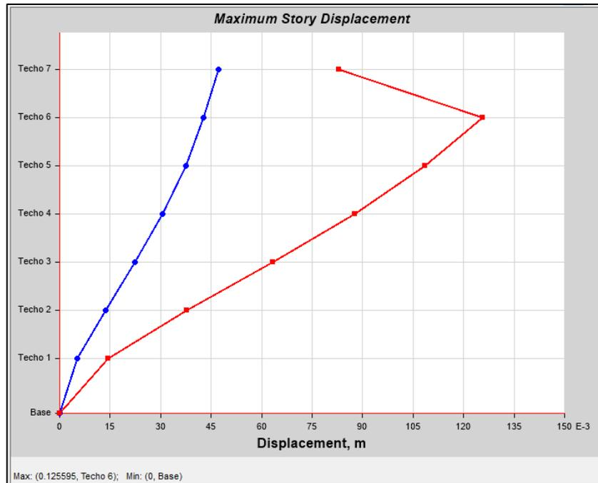
Figura N° 25. Desplazamientos laterales de la estructura empleando disipadores sísmicos en dirección Y.
