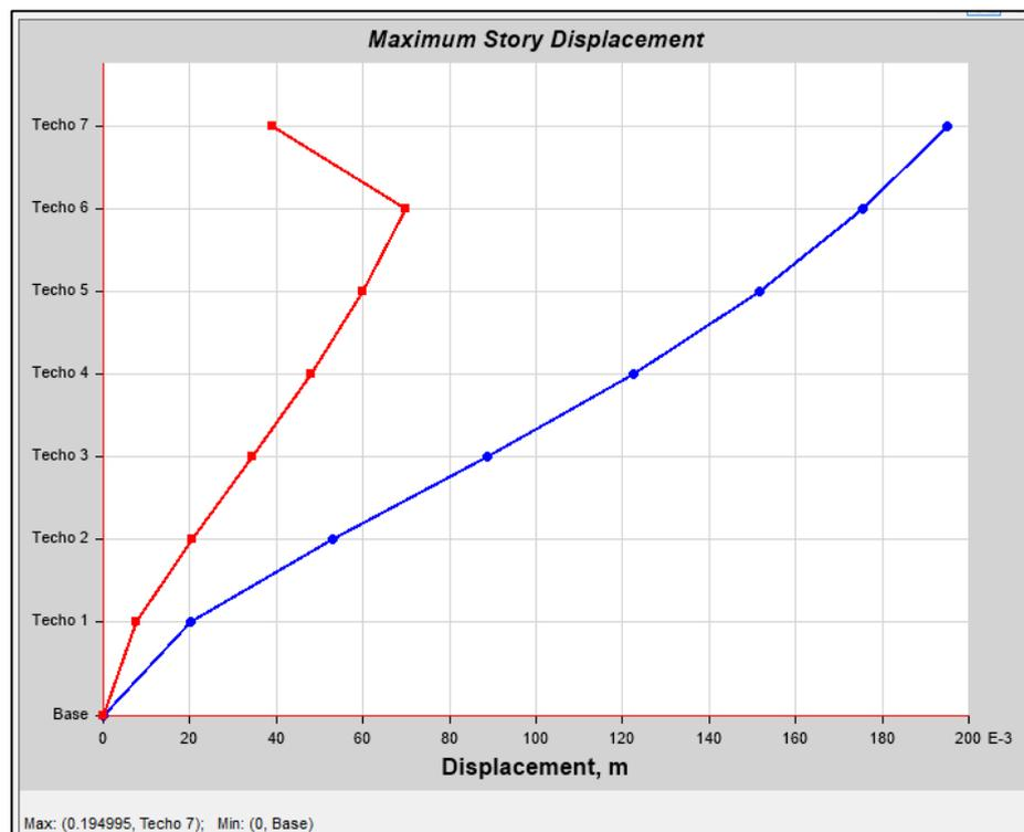
Figura N° 12. Desplazamientos laterales en dirección X – estructura sin aislamiento sísmico.
