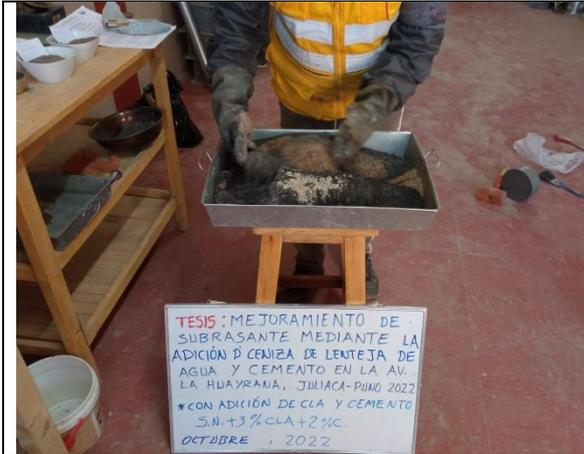
**Fotografía 23.** Combinación de la ceniza de lenteja de agua, cemento y suelo
