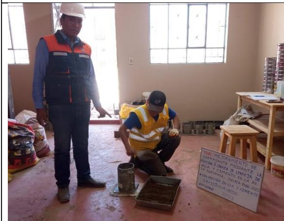
**Fotografía 19.** Ensayo de Proctor modificado
