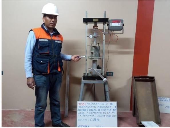
Figura 15. Ensayo de valor de soporte California
