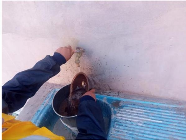
Figura 12. Lavado de muestra a través del tamiz N° 200
