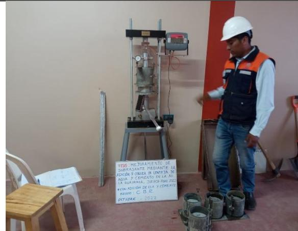
**Fotografía 24.** Ensayo de Californian Bearing Ratio
