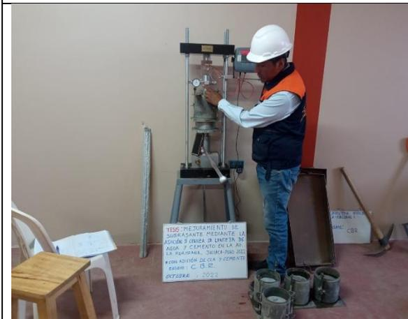
**Fotografía 25.** Ensayo de Californian Bearing Ratio
