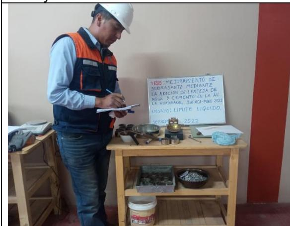
**Fotografía 15.** Ensayo de límite líquido con la cuchara de Casagrande
