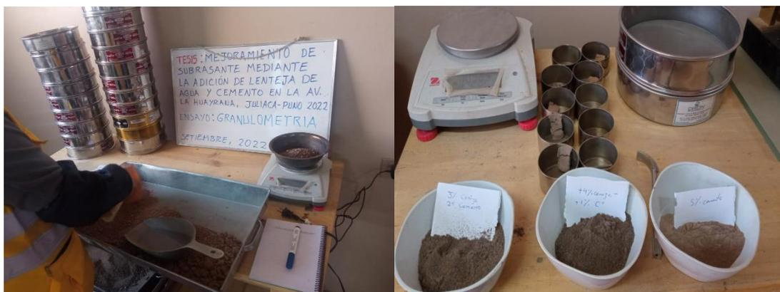
Figura 28. Adición de la ceniza de lenteja de agua y cemento al suelo
