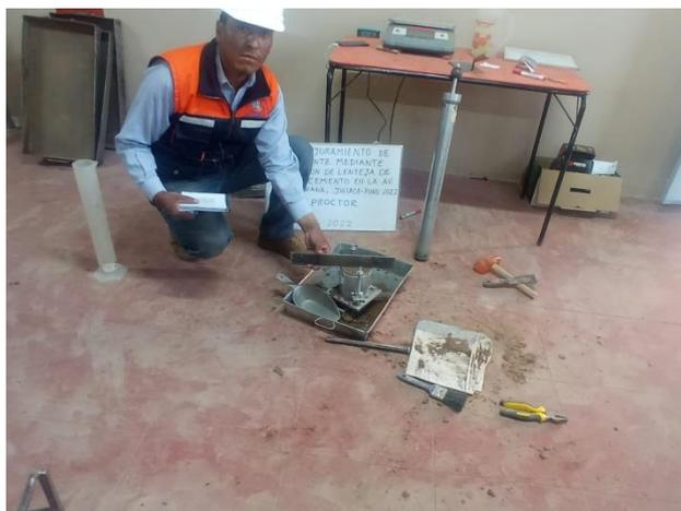
*Figura 14. Ensayo de Proctor modificado*
