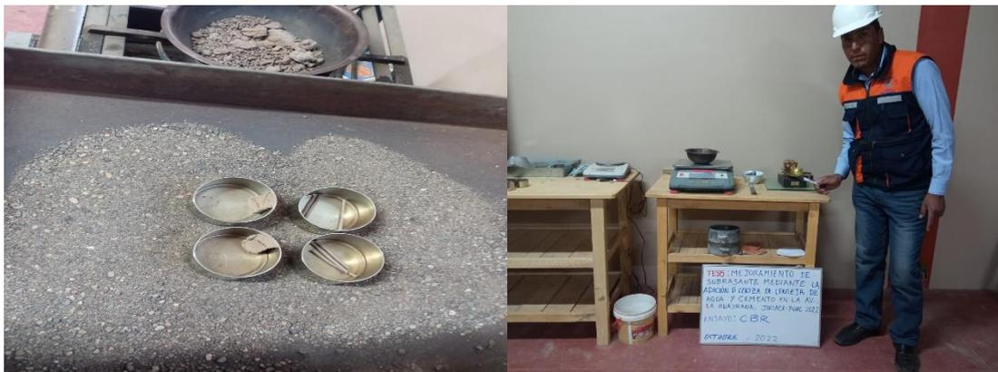
Figura 24. Obtención del límite líquido, límite plástico e índice de plasticidad
