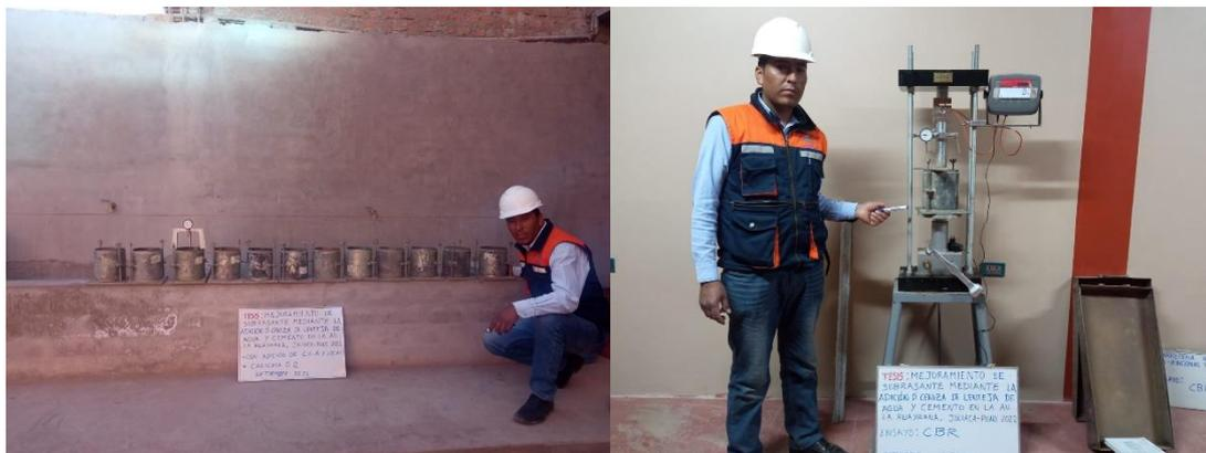
Figura 26. Obtención de la capacidad de soporte CBR
