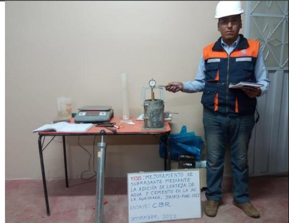
**Fotografía 18.** Dial para la medición de la expansión
