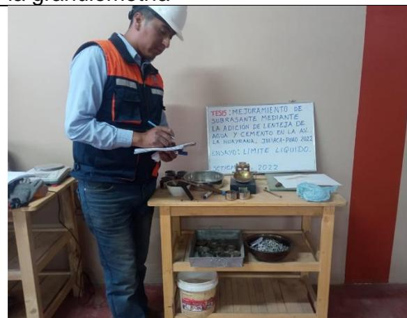
**Fotografía 14.** Ensayo de límite líquido con la cuchara de Casagrande
