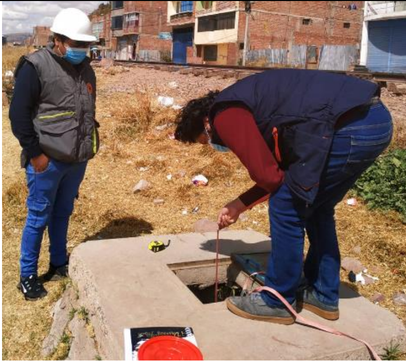
Imagen N° 29 : Se aprecia el aforo del pozo artesanal N° 03
