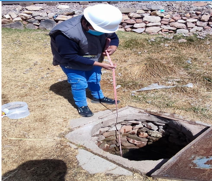
Imagen N° 16 : Se aprecia el aforo del pozo artesanal N° 01
