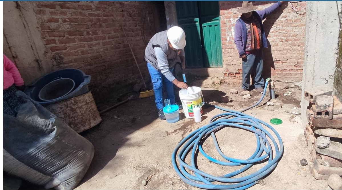
Imagen N° 9 :Se aprecia el aforo del pozo tubular N° 05
