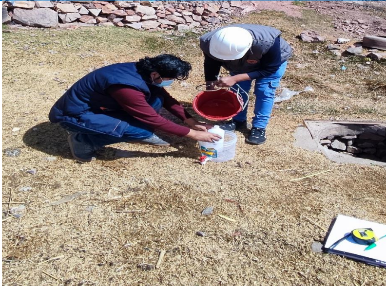
Imagen N° 15 : Se aprecia la toma de muestras de agua para laboratorio del pozo artesanal N° 01
