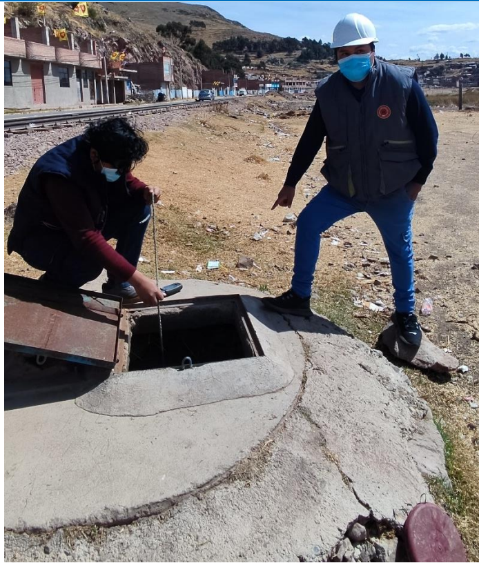
Imagen N° 17 : Se aprecia el aforo del pozo artesanal N°02
