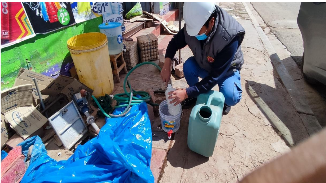
Imagen N° 26 : Se aprecia la toma de muestras de agua para el análisis de laboratorio del pozo tubular N° 04
