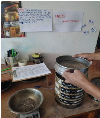
Ensayo de Granulometría para el agregado fino
