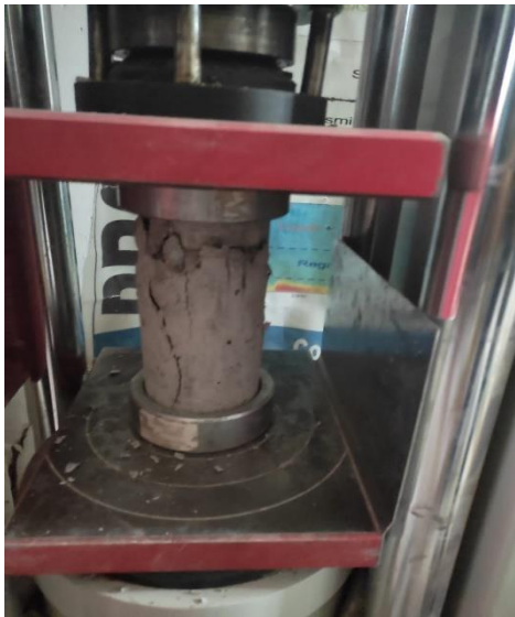
Aplicación de la fuerza hacia las probetas.
