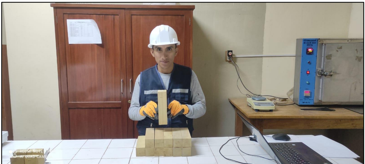
Foto 10. Probetas para el ensayo de compresión perpendicular 5cm x 5cm x 15 cm según N.T.P 251.016.
