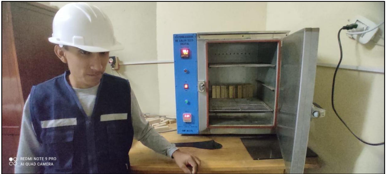
Foto 7. Retirando las muestras de la estufa, se dejan enfriar en desecador y se pesan. Se repite el tratamiento hasta peso constante.
