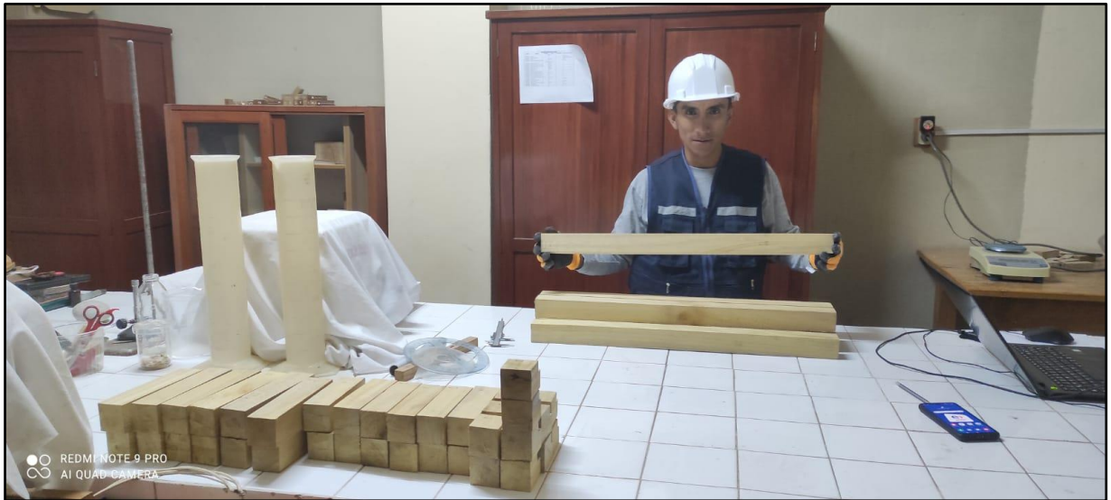
Foto 13. Probetas para el ensayo de flexión estática 5cm x 5cm x 75 cm según N.T.P 251.017.
