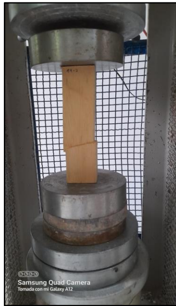
Foto 17. Falla registrada, al esfuerzo de carga axial.
