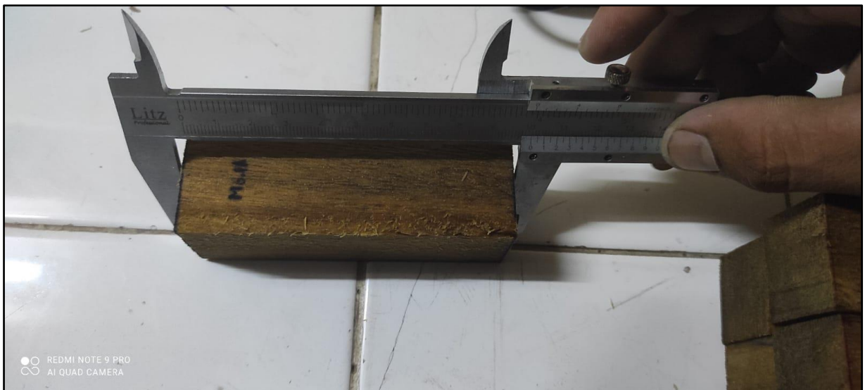
Foto 8. Se realiza la medición directa del largo (mm) de la probeta geométrica con la precisión requerida con un vernier.
