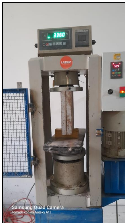
Foto 18. Ensayo de compresión perpendicular 5cm x 5cm x 15 cm según N.T.P 251.016.
