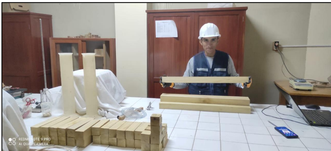
Foto 2. Muestra de las probetas para la realización de los ensayos físicos y mecánicos según las N.T.P.
