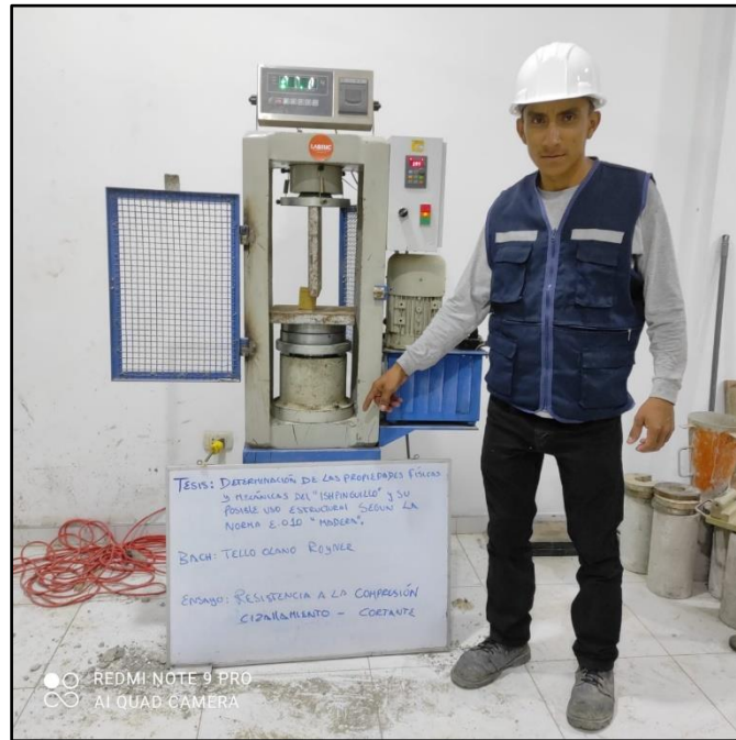
Foto 21. Ensayo de cizallamiento 5cm x 5cm x 6.5 cm según N.T.P 251.013.
