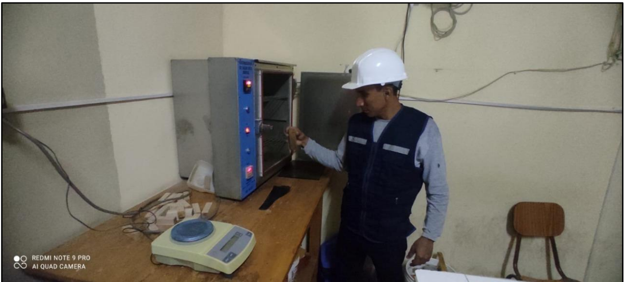
Foto 6. Colocación en la estufa donde se aplica un calentamiento gradual hasta alcanzar los 103^{\circ} \pm 2^{\circ} \text{C} .
