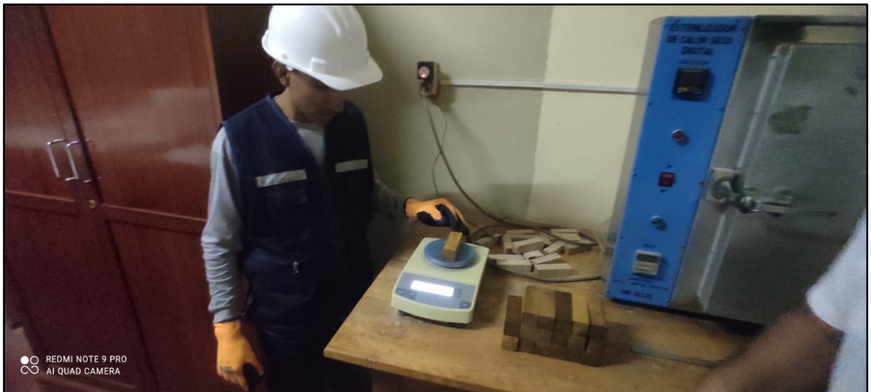
Foto 4. Peso saturado de las probetas 3cm x 3cm x 10cm, para ensayo de contenido de humedad N.T.P 251.010.
