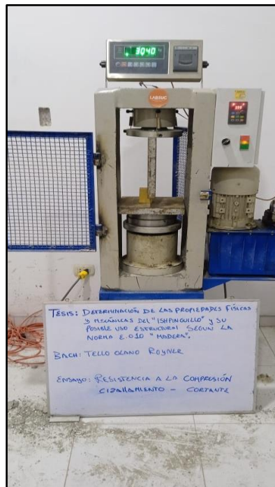
Foto 22. Carga registrada para el ensayo de cizallamiento por el equipo de compresión (Kg) en el laboratorio.
