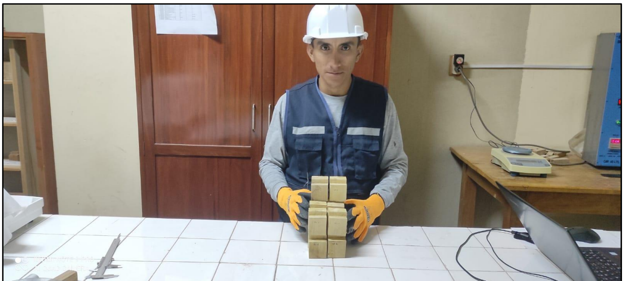
Foto 12. Probetas para el ensayo de cizallamiento 5cm x 5cm x 6.5 cm según N.T.P 251.013.
