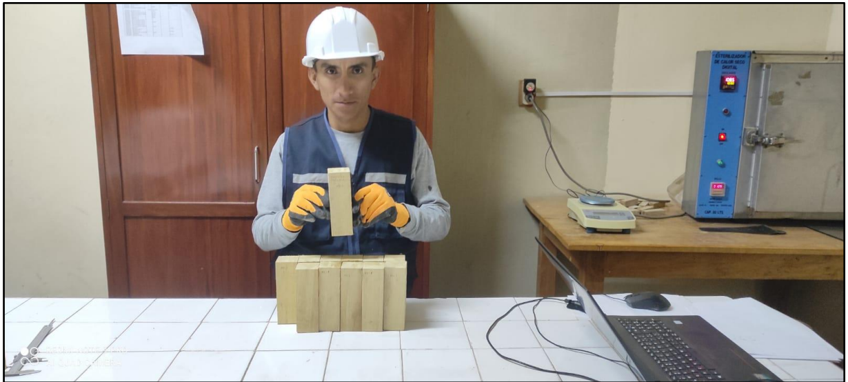
Foto 11. Probetas para el ensayo de compresión paralela 5cm x 5cm x 20 cm según N.T.P 251.014.
