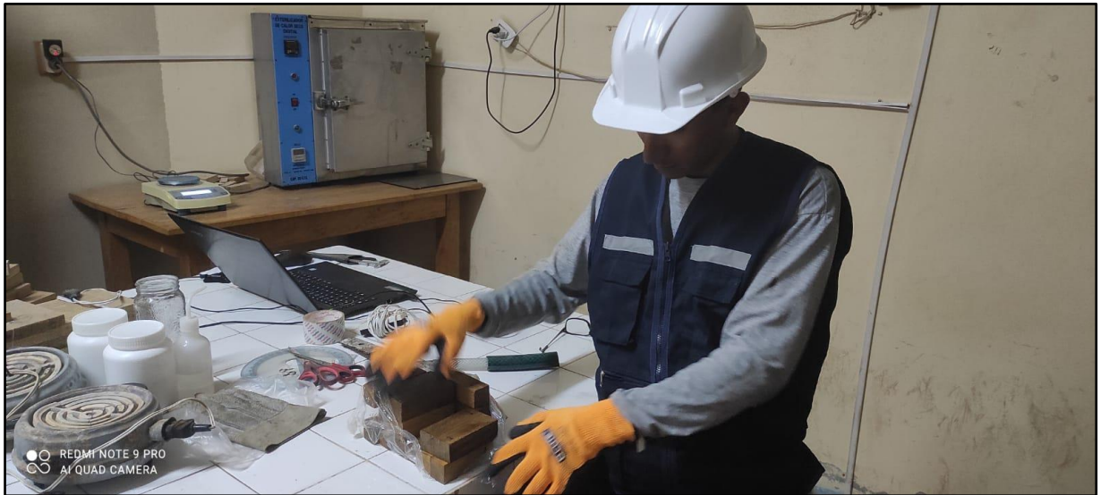
Foto 3. Probetas saturadas durante 48 horas, medidas 3cm x 3cm x 10cm, para ensayo de contenido de humedad N.T.P 251.010.
