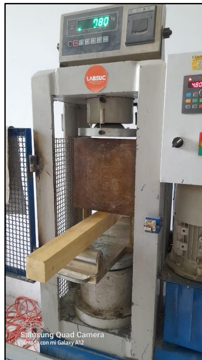
Foto 20. Carga registrada para el ensayo a flexión estática por el equipo de compresión (KN) en el laboratorio.
