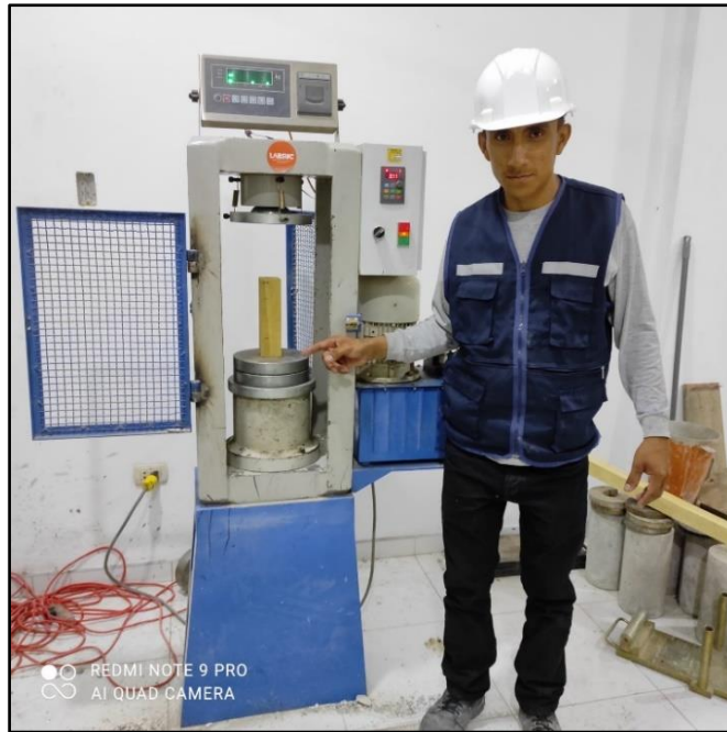
Foto 15. Ensayo de compresión paralela con probetas de 5cm x 5cm x 20 cm según N.T.P 251.01.
