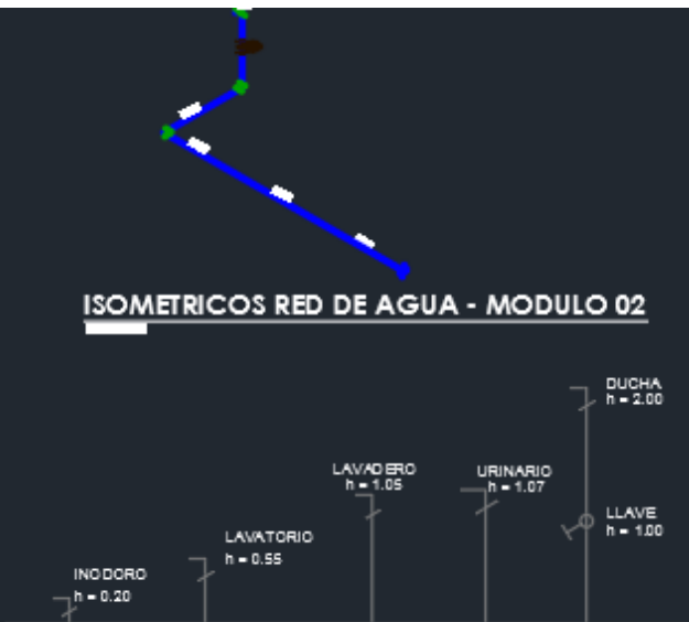
ALTURAS DE SALIDAS PARA APARATOS SANITARIOS
