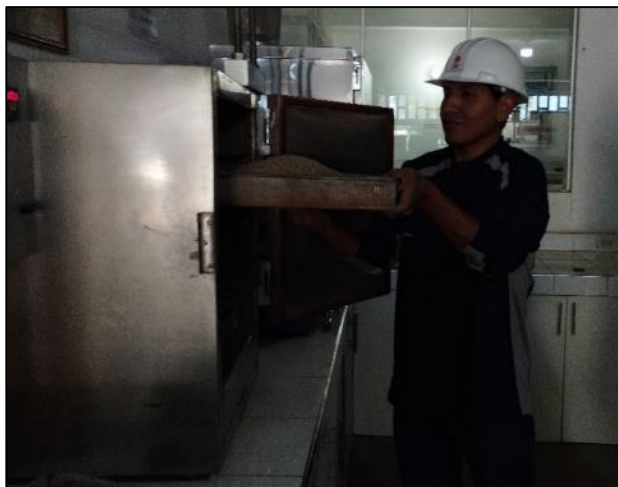
Figura 18: Llevando al horno las muestras
