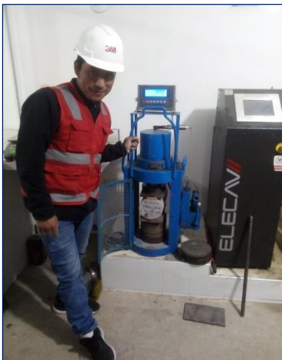
Figura 22: Ensayo a traccion por compresion diametral
