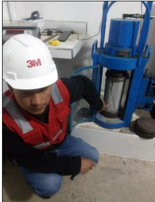
Figura 21: Ensayo de rotura a compresion
