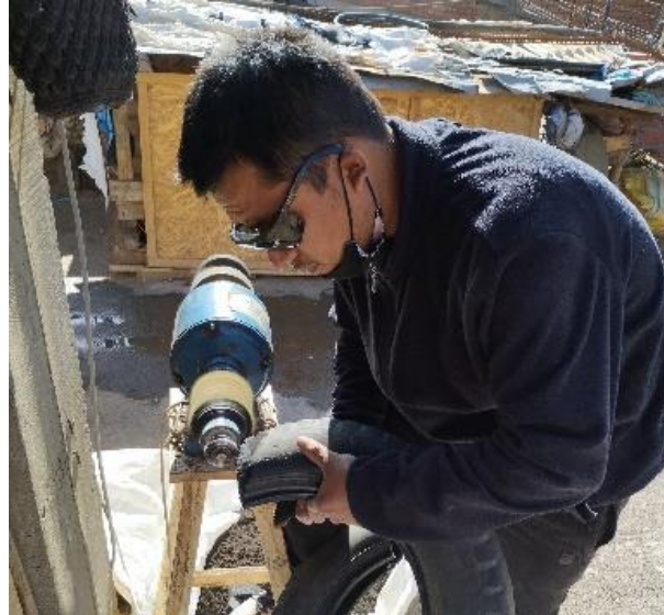
Figura 15: Molido de Caucho con esmeril electrico
