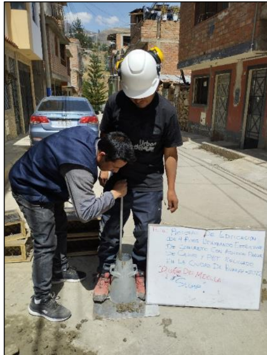
Figura 20: Procediendo con 25 golpes de varilla para cada capa.
