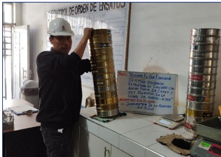
Figure 17: Tamizado de muestras
