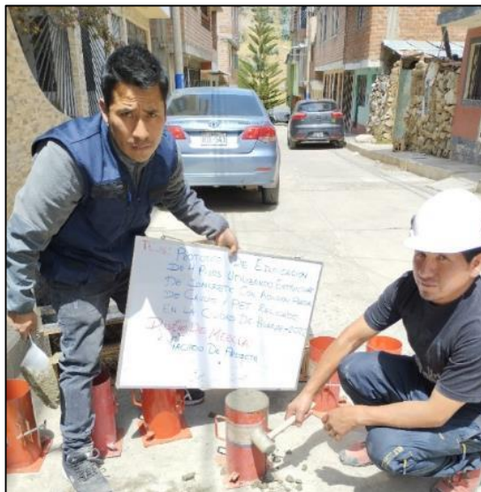
Figura 19: Llenado de probetas
