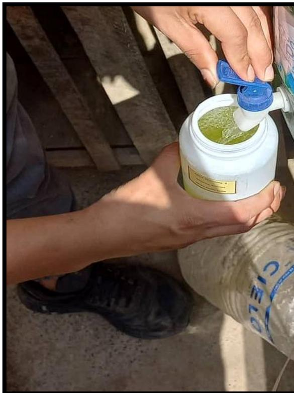
Figura 52. Toma de muestra del tratamiento con *eicchornia* para el ensayo de detergentes en el laboratorio.
