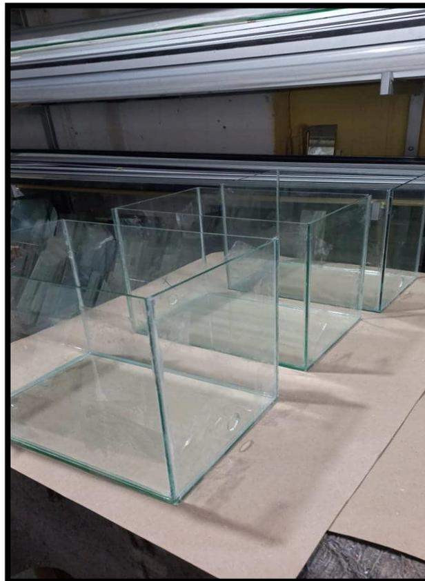
Figura 15. Elaboración de los humedales artificiales.
