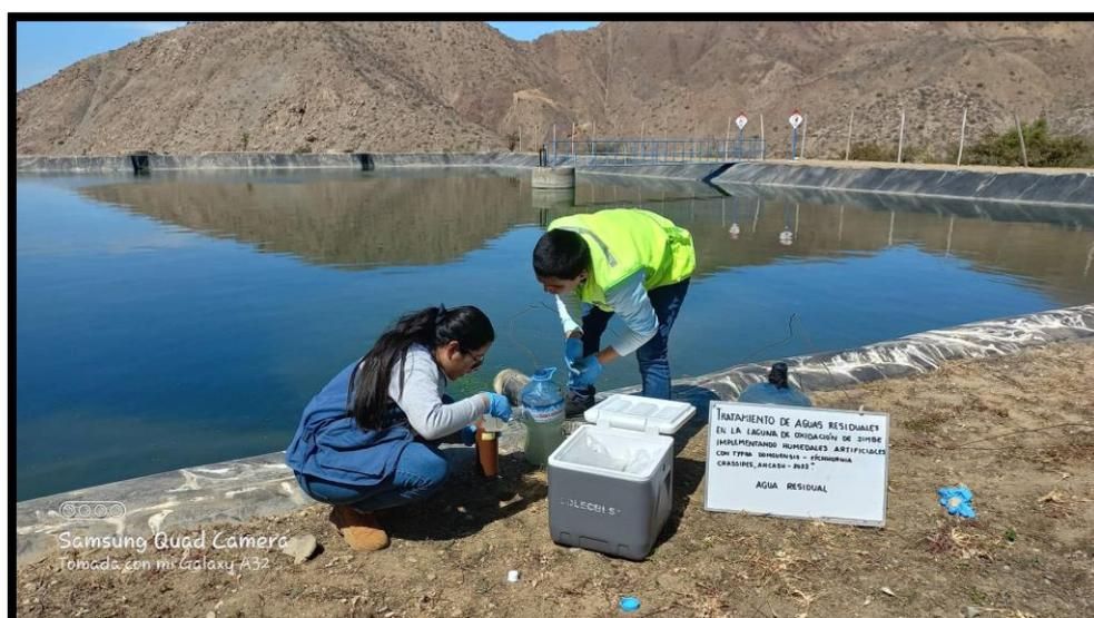
Figura 38. Recolección de muestra de agua residual para el ensayo de turbidez en el laboratorio.
