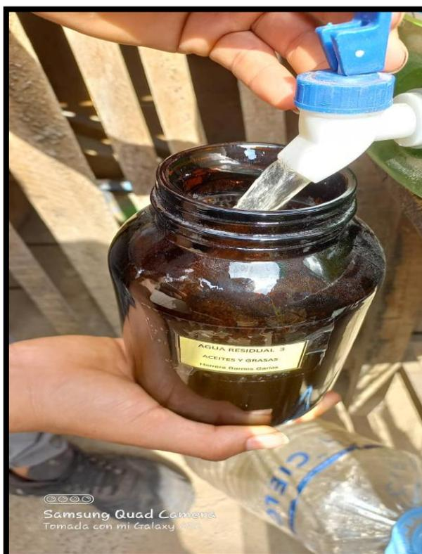
Figura 54. Toma de muestra del de tratamiento con eicchornia crassipes para el ensayo de aceites y grasas en el laboratorio
