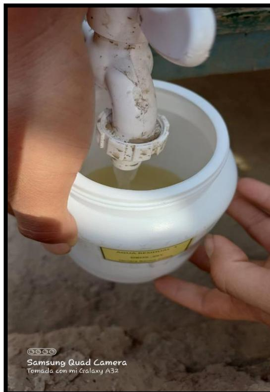
Figura 48. Toma de muestra del tratamiento con typha dominguensis para el ensayo de detergentes en el laboratorio.
