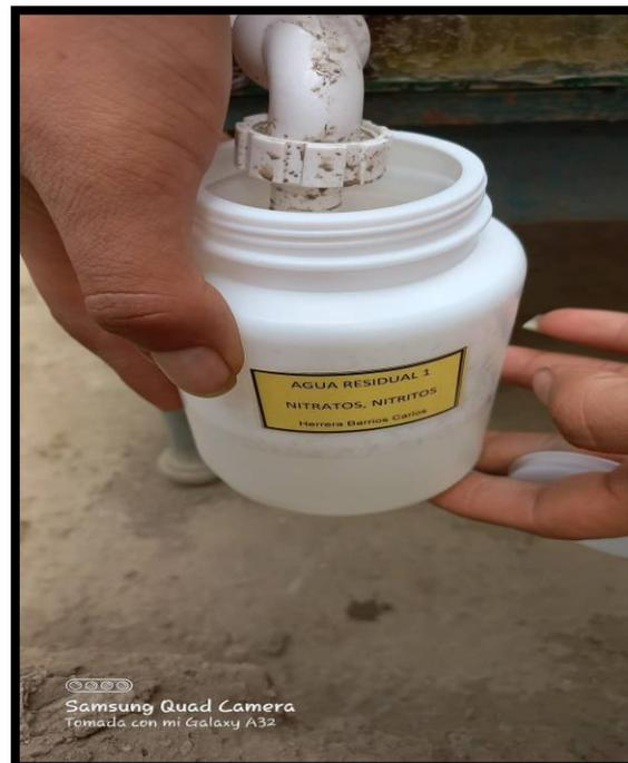
Figura 46. Toma de muestra del tratamiento con typha dominguensis para el ensayo de nitritos y nitratos en el laboratorio.
