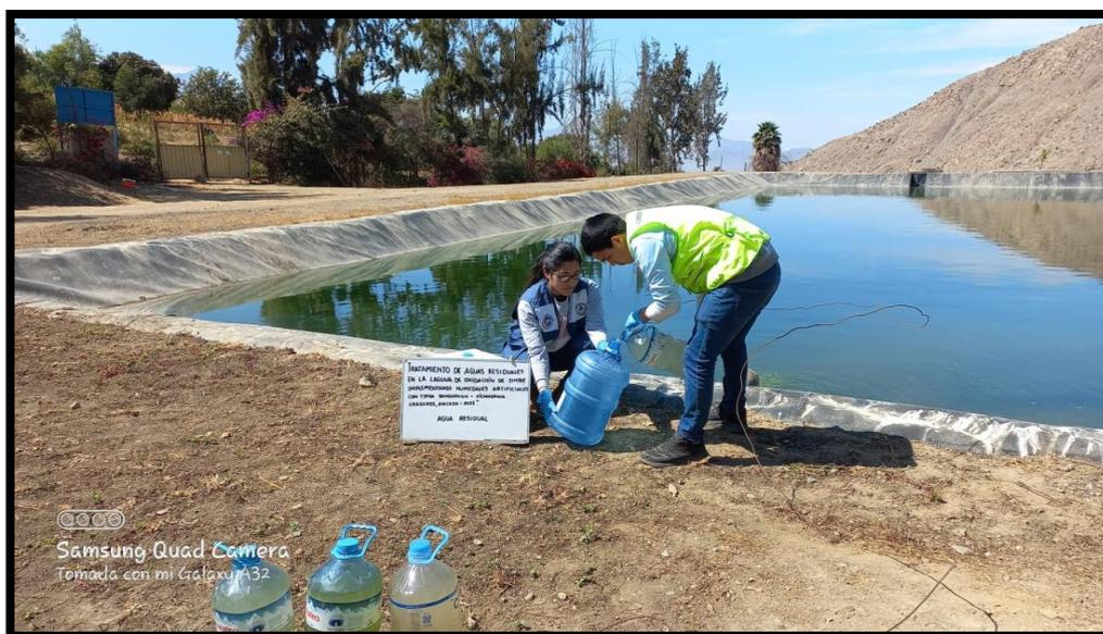
Figura 37. Recolección de muestras de agua residual de la laguna de oxidación de Jimbe.
