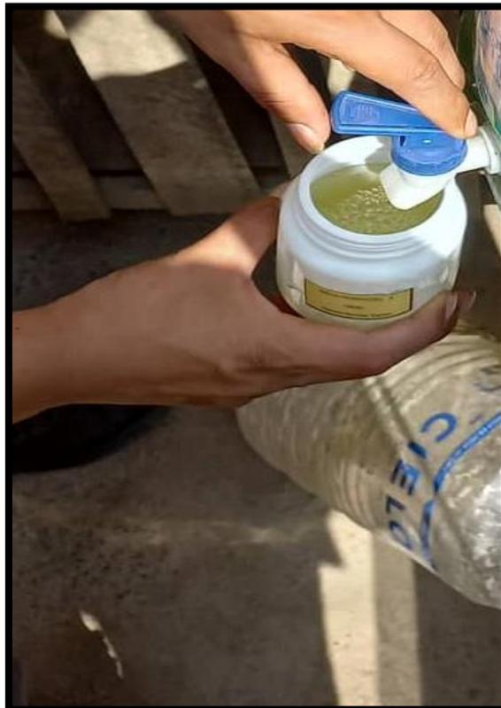
Figura 50. Toma de muestra del tratamiento con *eicchornia crassipes* para el ensayo DQO en el laboratorio.
