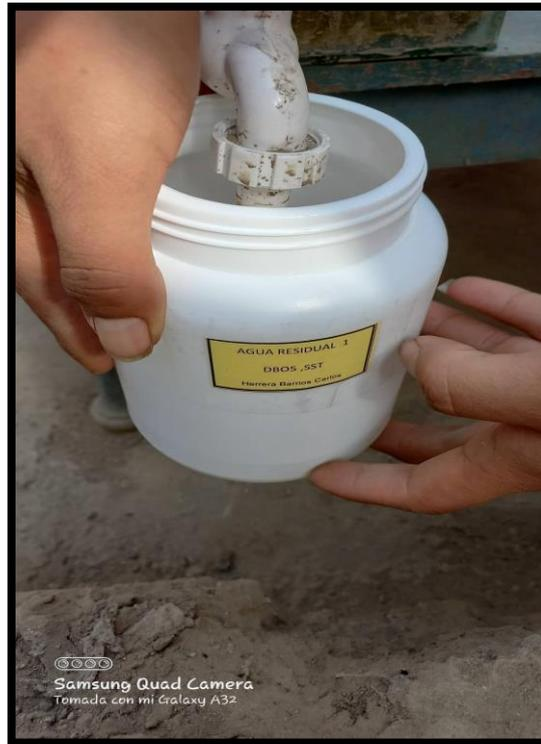
Figura 47. Toma de muestra del tratamiento con typha dominguensis para el ensayo de  $DBO_5$  y SST en el laboratorio.
