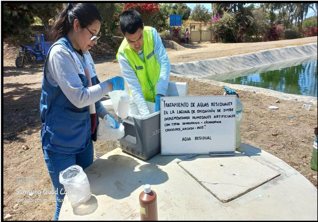
Figura 43. Empaquetando y sellados las muestras para los ensayos en el laboratorio
