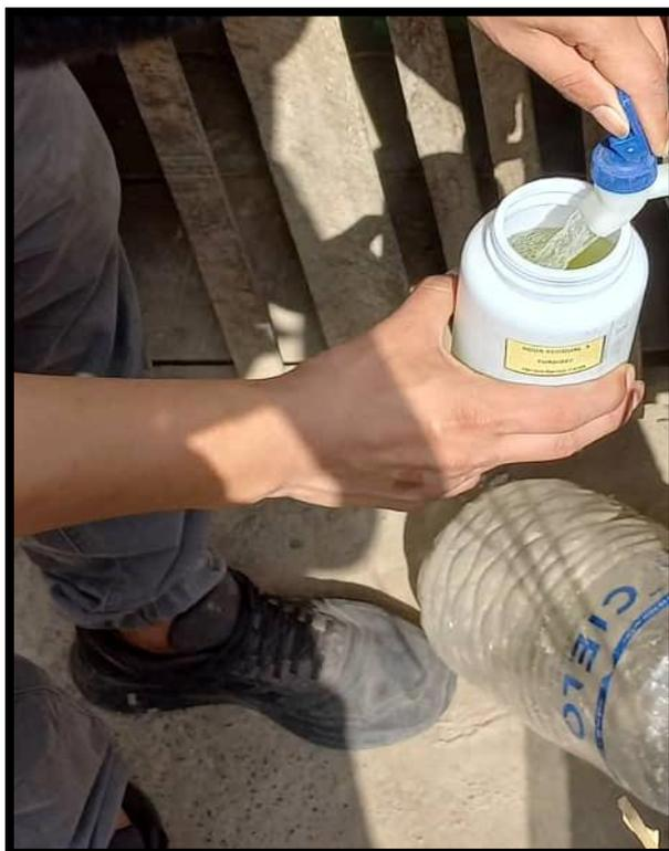
Figura 53. Toma de muestra del tratamiento con eicchornia crassipes para el ensayo de turbidez en el laboratorio.
