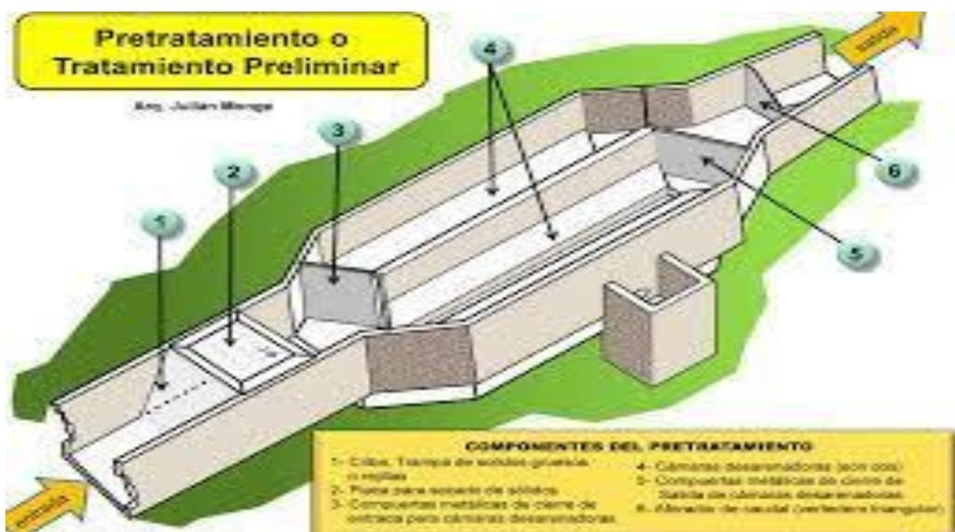
Figura 2. Componentes del pretratamiento (cribas y desarenadores)
