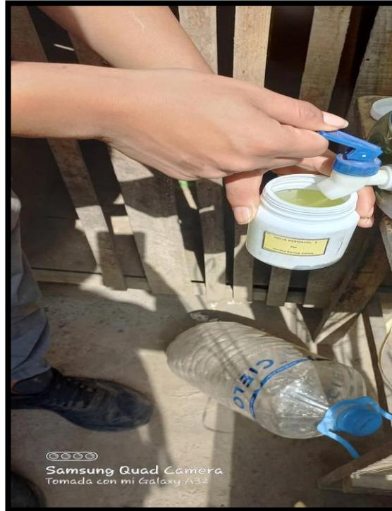
Figura 49. Toma de muestra de los primeros 8 días de tratamiento con *eicchornia crassipes* para el ensayo de pH en el laboratorio.
