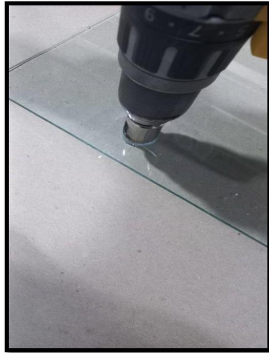
**Imagen 2.** Perforación al vidrio para la salida del agua residual tratada.
