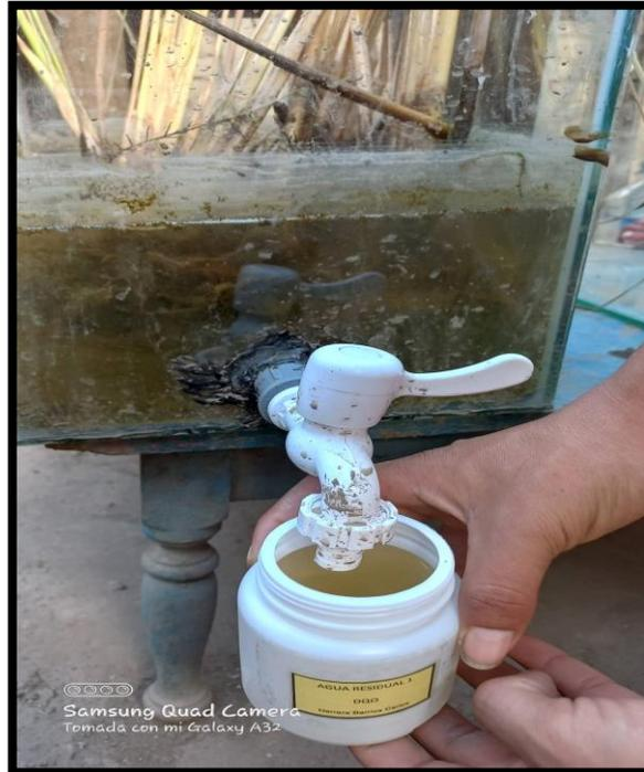
Figura 45. Toma de muestras del tratamiento con typha dominguensis para el ensayo de DQO en el laboratorio.
