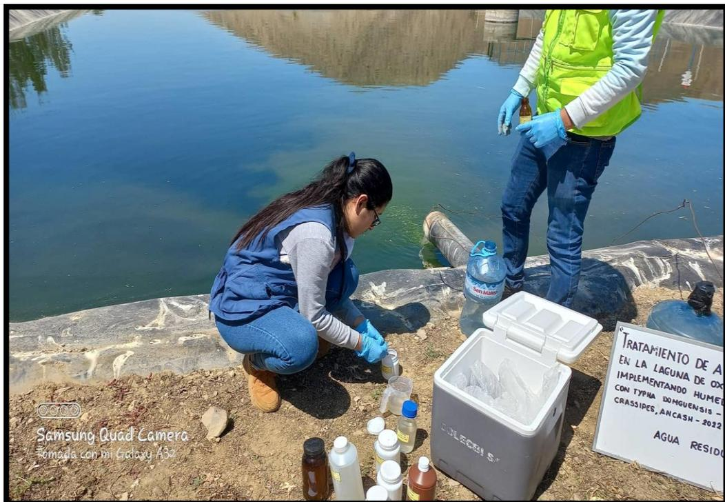
Figura 40. Recolección de muestra de agua residual para el ensayo pH en el laboratorio.
