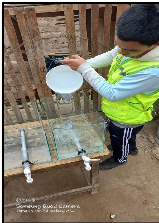
Figura 19. Prueba hidráulica a los humedales artificiales para evitar fugas.
