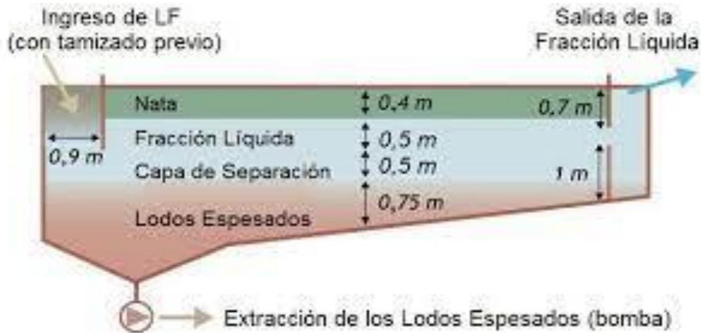
Figura 4. Esquema de las capas en un tanque de sedimentación y espesamiento.
