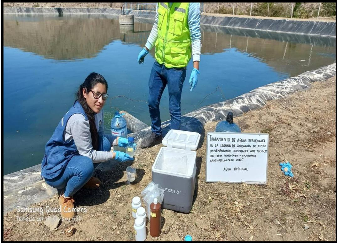
Figura 41. Muestras de agua residual para los ensayos de nitritos y nitratos en el laboratorio.
