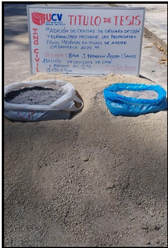
FOTOGRAFIA 23: Observamos el mezclado de cenizas CC y CP. Con el suelo dosis de 2%, para bloques de adobes de 15 x 30 x 9 cm.
