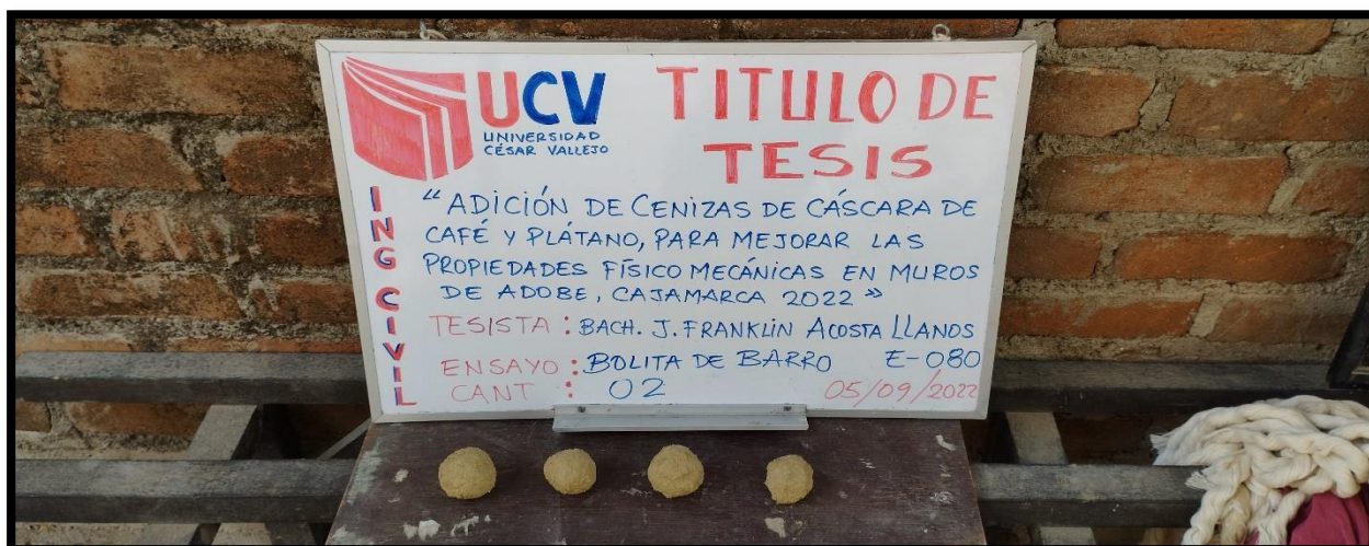
FOTOGRAFIA 10: Observamos el ensayo de bolitas de barro cantera 02 (resistencia seca)
