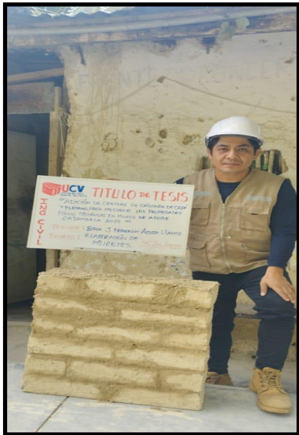
FOTOGRAFIA 29: Apreciamos los muretes de 65 x65 cm para ensayo a compresión diagonal.
