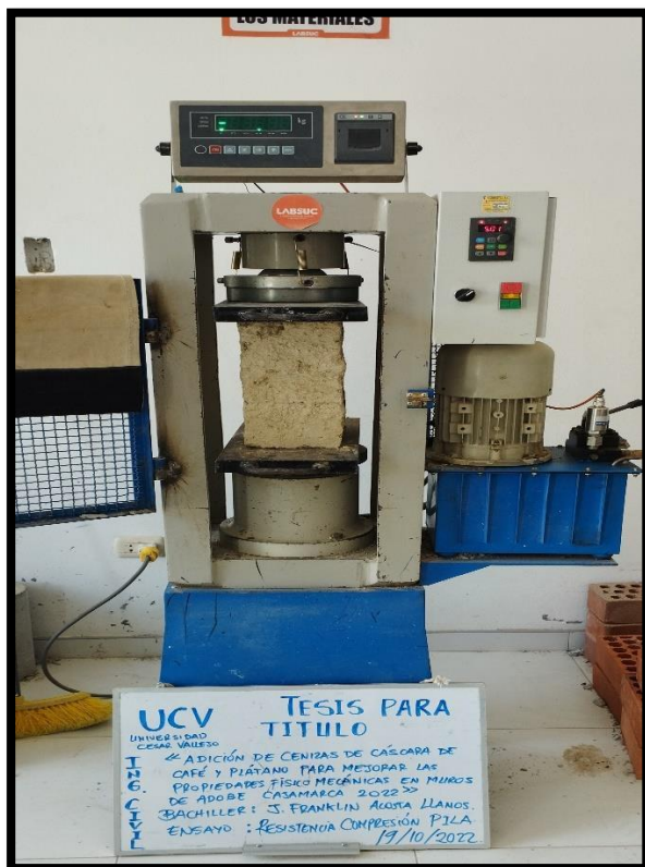
FOTOGRAFIA 30: Observamos la rotura de muestras de compresión en pila, en laboratorio.
