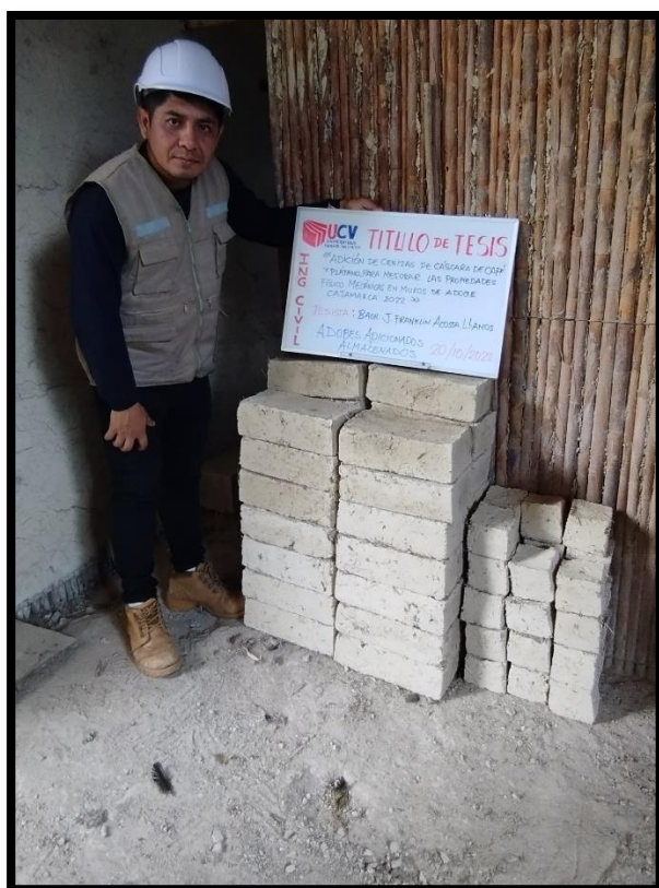
FOTOGRAFIA 28: Apreciamos el almacenamiento de muestras de adobe para ensayo de compresión de bloque, compresión axial de pila, y compresión diagonal de murete de adobe.
