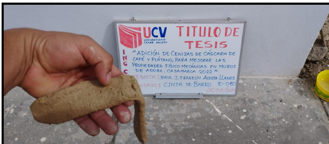
FOTOGRAFIA 11: Observamos el ensayo de cinta de barro cantera 01.
