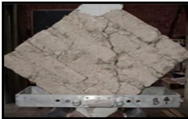
Figura 08: Prueba de compresión diagonal en murete
