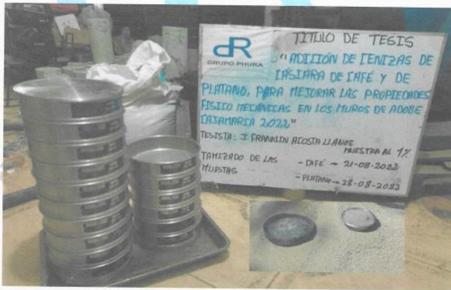
IMAGEN N°2: TAMIZADO DE LA MUESTRA DE CASCARA DE PLÁTANO PARA EL PROYECTO DENOMINAD "ADICIÓN DE CENIZAS DE CÁSCARAS DE CAFÉ Y PLÁTANO, PARA MEJORAR LAS PROPIEDADES FÍSICO MECÁNICAS EN MUROS DE ADOBE CAJAMARCA 2022"
