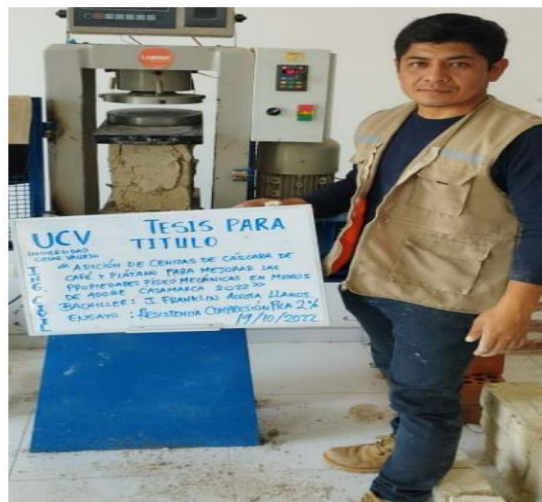
FOTOGRAFIA 13: Ensayo de resistencia a la compresión en pilas de adobe para el proyecto tesis "Adición De Cenizas De Cascara De Café Y Plátano, Para Mejorar Las Propiedades Físico Mecánicas En Muros De Adobe Cajamarca 2022"
