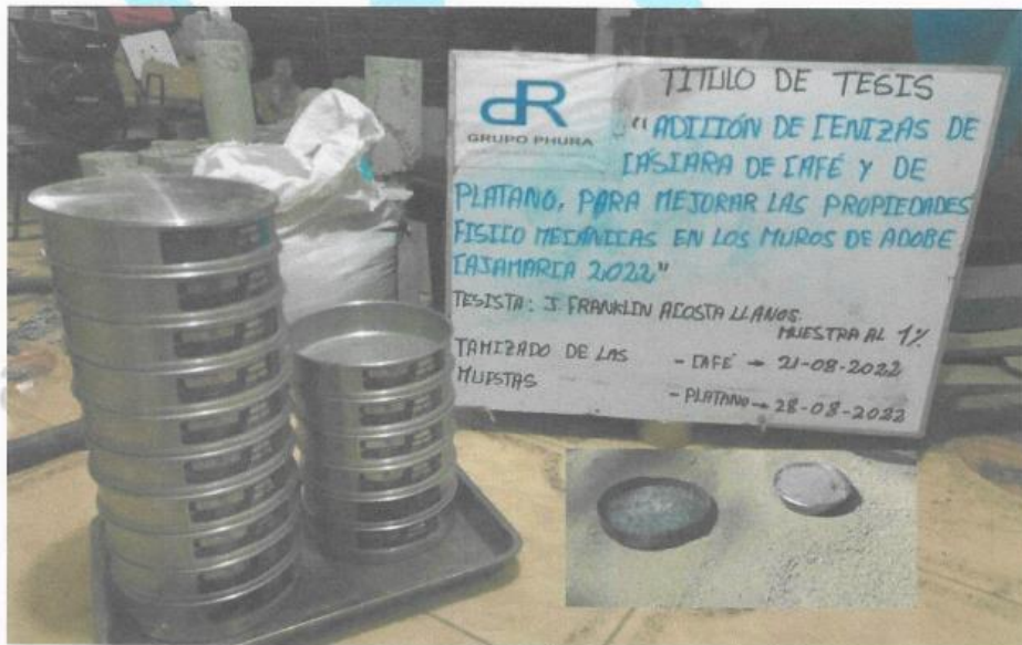
IMAGEN N°2: TAMIZADO DE LA MUESTRA DE CASCARA DE CAFÉ PARA EL PROYECTO DENOMINAD "ADICIÓN DE CENIZAS DE CÁSCARAS DE CAFÉ Y PLÁTANO, PARA MEJORAR LAS PROPIEDADES FÍSICO MECÁNICAS EN MUROS DE ADOBE CAJAMARCA 2022"
