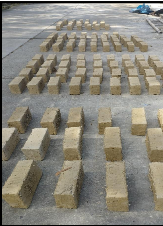
FOTOGRAFIA 26: Apreciamos la elaboración de muestras para compresión diagonal de murete.
