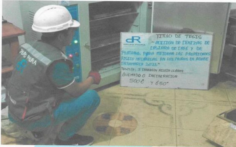
IMAGEN N°1: SECADO DE LA MUESTRA DE CASCARA DE PLÁTANO A 650 °C PARA EL PROYECTO DENOMINAD "ADICIÓN DE CENIZAS DE CÁSCARAS DE CAFÉ Y PLÁTANO, PARA MEJORAR LAS PROPIEDADES FÍSICO MECÁNICAS EN MUROS DE ADOBE CAJAMARCA 2022"
