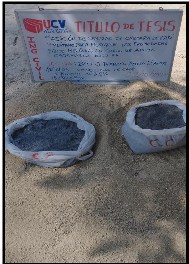
FOTOGRAFIA 23: Observamos el mezclado de cenizas CC y CP. Con el suelo dosis de 2%, para bloques de adobes de 15 x 30 x 9 cm.
