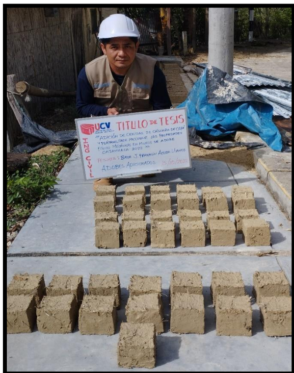
FOTOGRAFIA 27: Apreciamos las muestras adicionadas al 1%. 2%. 3.5% para ensayo de compresión de bloque, compresión axial de pila, y compresión diagonal de murete de adobe.
