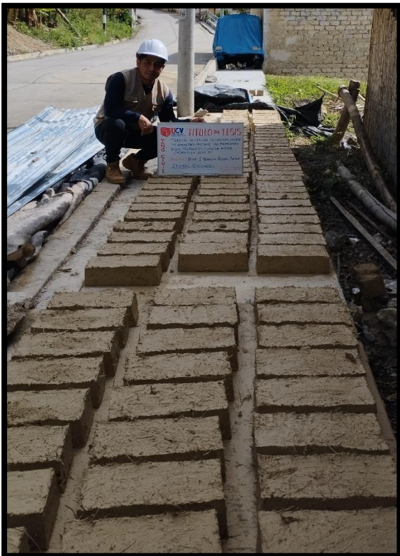
FOTOGRAFIA 26: Apreciamos la elaboración de muestras para compresión diagonal de murete.
