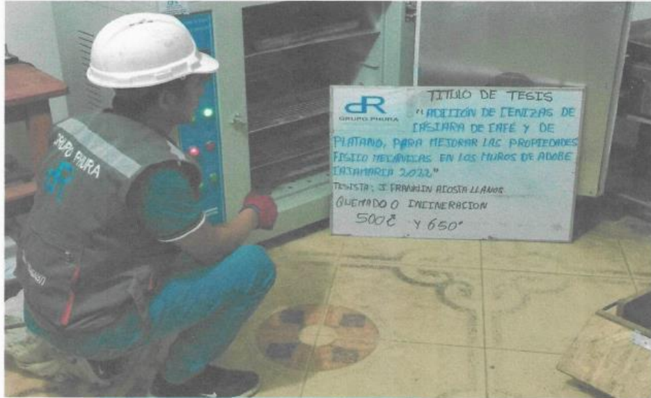
IMAGEN N°1: SECADO DE LA MUESTRA DE CASCARA DE CAFÉ A 500 °C PARA EL PROYECTO DENOMINAD "ADICIÓN DE CENIZAS DE CÁSCARAS DE CAFÉ Y PLÁTANO, PARA MEJORAR LAS PROPIEDADES FÍSICO MECÁNICAS EN MUROS DE ADOBE CAJAMARCA 2022"
