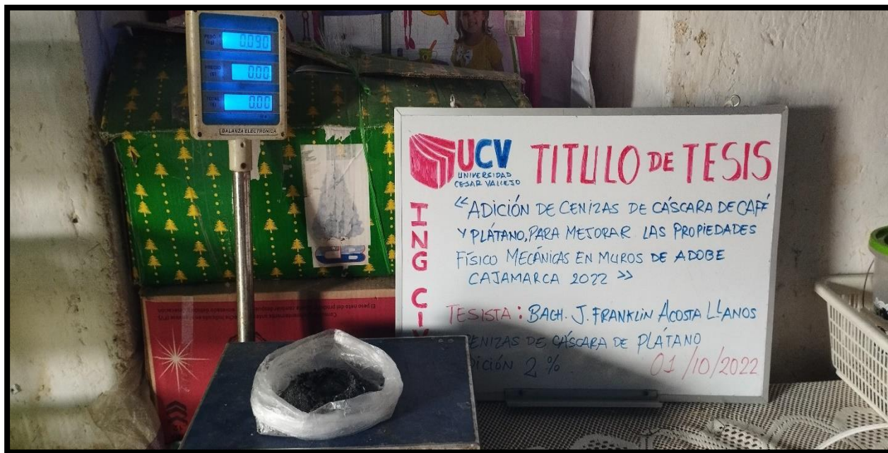
FOTOGRAFIA 17: Apreciamos el pesaje de cenizas de plátano para las adiciones, 2% y 3.5%
