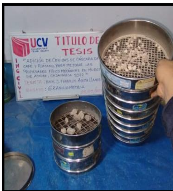
Figura 45: Tamizado muestra de suelo para ensayos de granulometría
