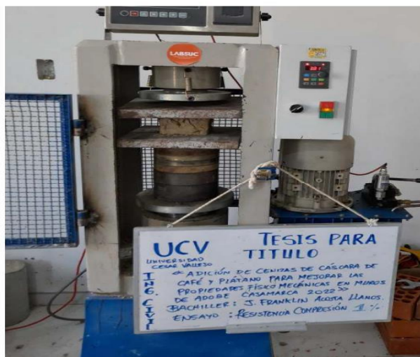
FOTOGRAFIA 06: Ensayo de resistencia a la compresión de unidad de adobe con adición del 1% para el proyecto tesis "Adición De Cenizas De Cascara De Café Y Plátano, Para Mejorar Las Propiedades Físico Mecánicas En Muros De Adobe Cajamarca 2022"
