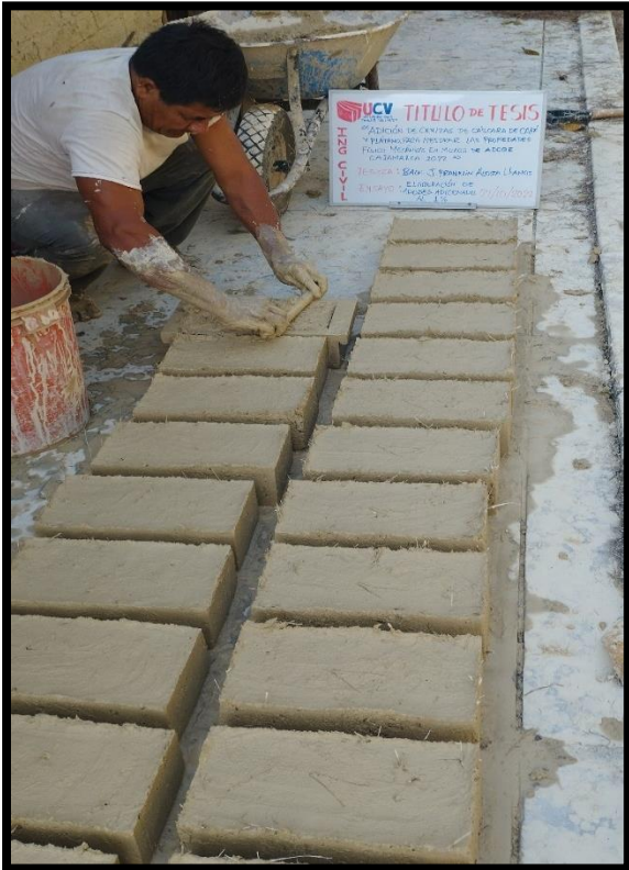
FOTOGRAFIA 25: Apreciamos la elaboración de muestras para compresión axial pila y compresión en unidad de adobe.
