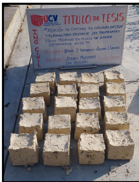
FOTOGRAFIA 24: Observamos el mezclado de cenizas CC y CP. Y elaboración de bloque de adobe de 10 x 10 x10 para ensayo de compresión de unidad de adobe.
