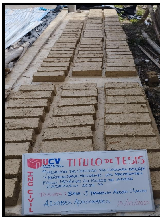
FOTOGRAFIA 27: Apreciamos las muestras adicionadas al 1%. 2%. 3.5% para ensayo de compresión de bloque, compresión axial de pila, y compresión diagonal de murete de adobe.
