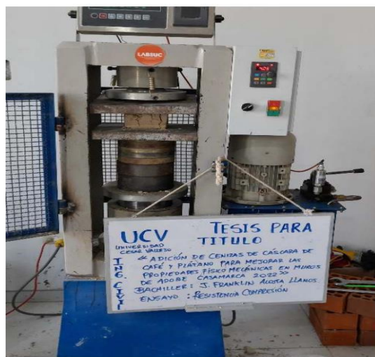
FOTOGRAFIA 01: Ensayo de resistencia a la compresión de unidad de adobe tradicional para el proyecto tesis "Adición De Cenizas De Cascara De Café Y Plátano, Para Mejorar Las Propiedades Físico Mecánicas En Muros De Adobe Cajamarca 2022"
