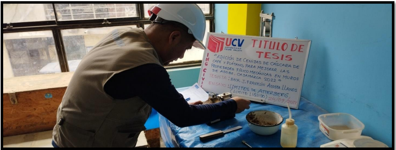
FOTOGRAFIA 07: Apreciamos los ensayos de Limites de consistencia en laboratorio.
