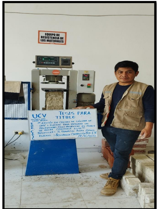
FOTOGRAFIA 30: Observamos la rotura de muestras de compresión en pila, en laboratorio.
