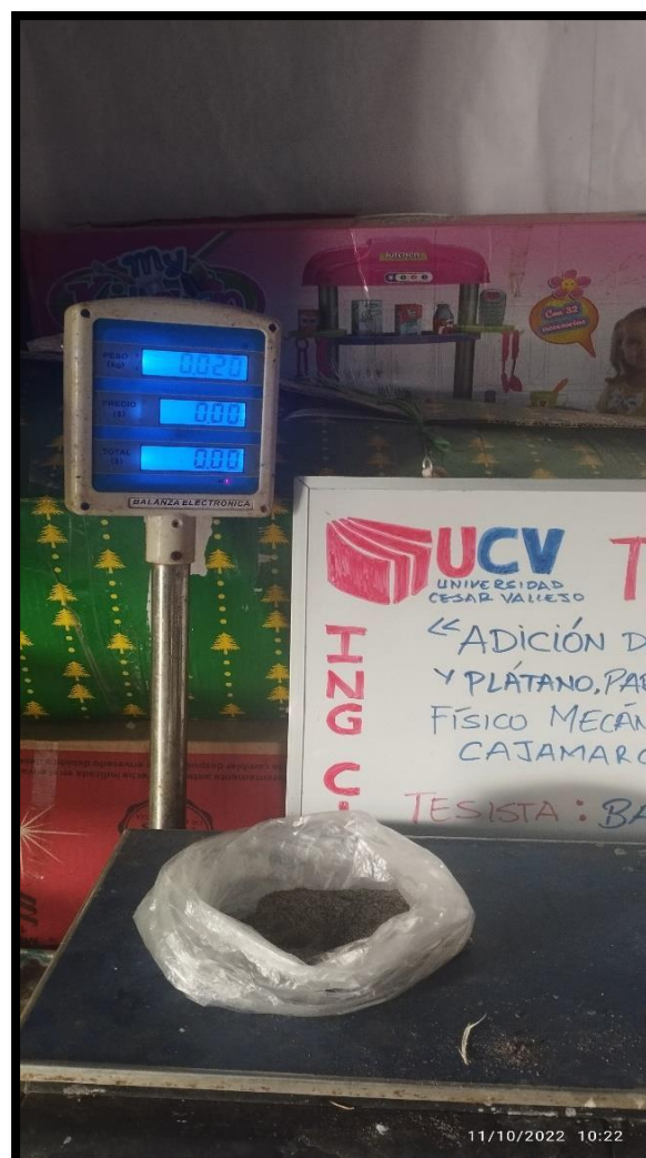
FOTOGRAFIA 13: Apreciamos la cáscara de plátano y el pesaje de sus cenizas para la adición.
