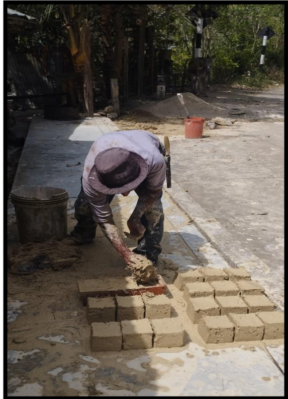
FOTOGRAFIA 25: Apreciamos la elaboración de muestras para compresión axial pila y compresión en unidad de adobe.
