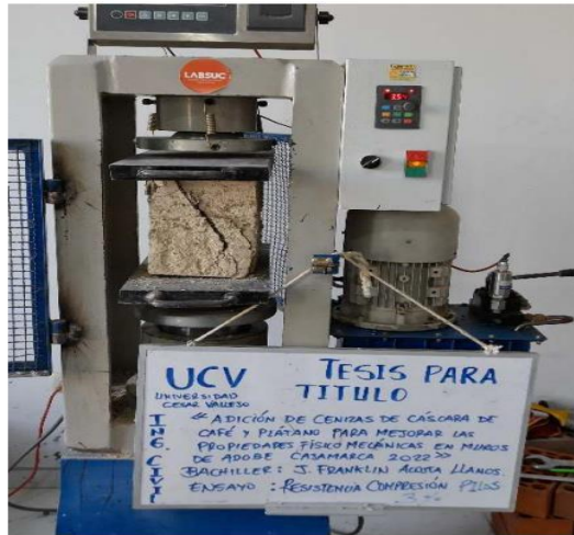
FOTOGRAFIA 15: Ensayo de resistencia a la compresión en pilas de adobe para el proyecto tesis "Adición De Cenizas De Cascara De Café Y Plátano, Para Mejorar Las Propiedades Físico Mecánicas En Muros De Adobe Cajamarca 2022"
