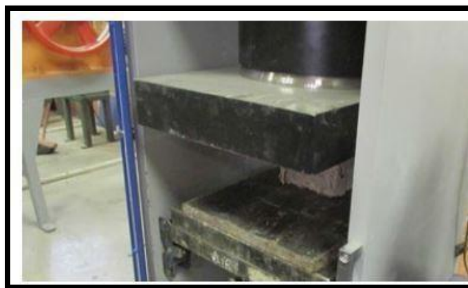
Figura 06: Prueba de resistencia a la compresión simple
