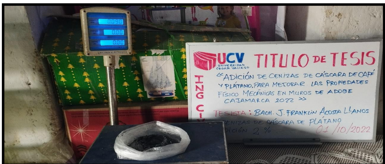
FOTOGRAFIA 16: Apreciamos el pesaje de cenizas de cáscara de café para las adiciones 2%.
