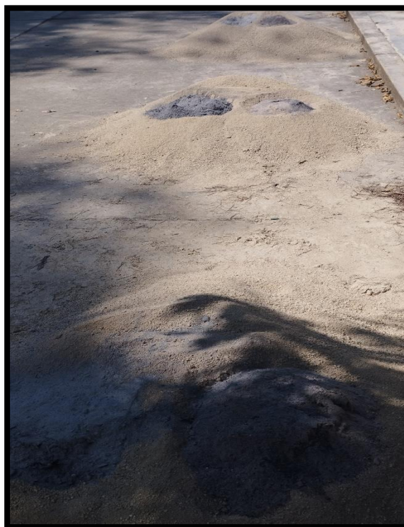
FOTOGRAFIA 24: Observamos el mezclado de cenizas CC y CP. Y elaboración de bloque de adobe de 10 x 10 x10 para ensayo de compresión de unidad de adobe.
