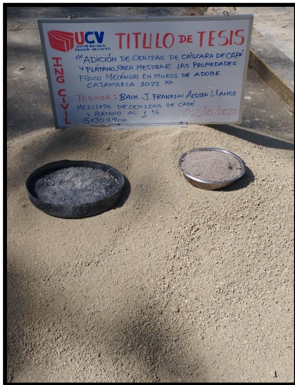
FOTOGRAFIA 22: Observamos el mezclado de cenizas CC y CP. Con el suelo dosis de 1%, para bloques de adobes de 15 x 30 x 9 cm.
