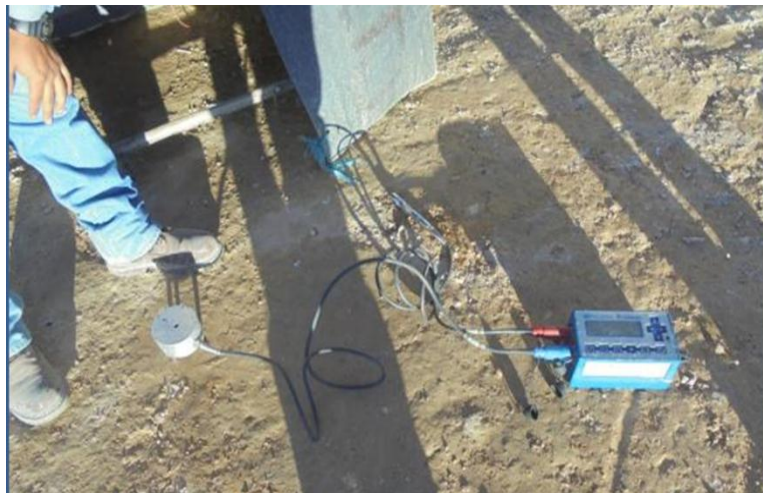
Figura N° 26: Instalación del equipo de medición de vibraciones
