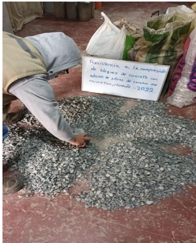
Imagen 08: Cuarteo del agregado grueso.
