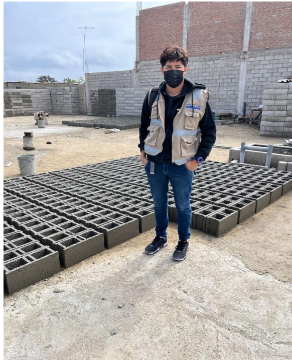
Imagen 16: Bloques de concreto con adición de caucho de neumático
