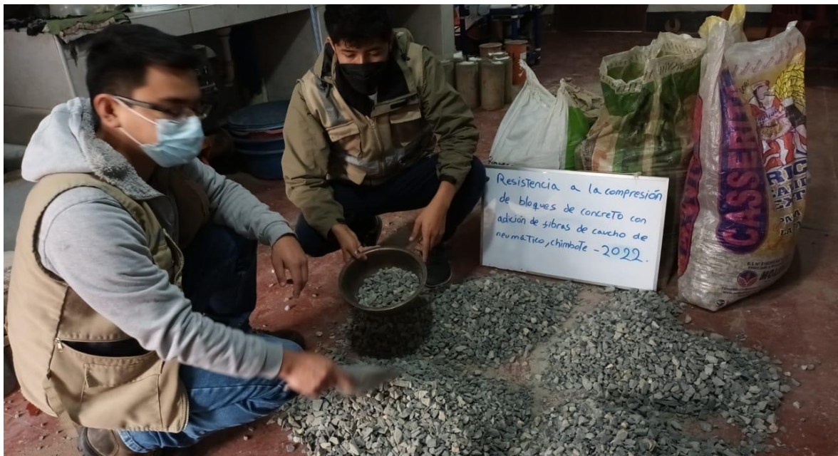
Imagen 08: Cuarteo del agregado grueso.
