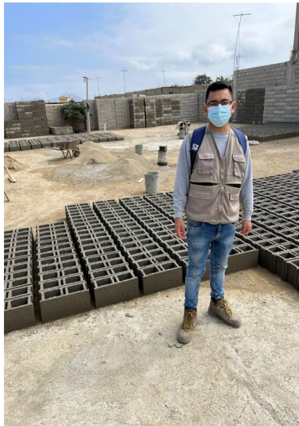
Imagen 16: Bloques de concreto con adición de caucho de neumático
