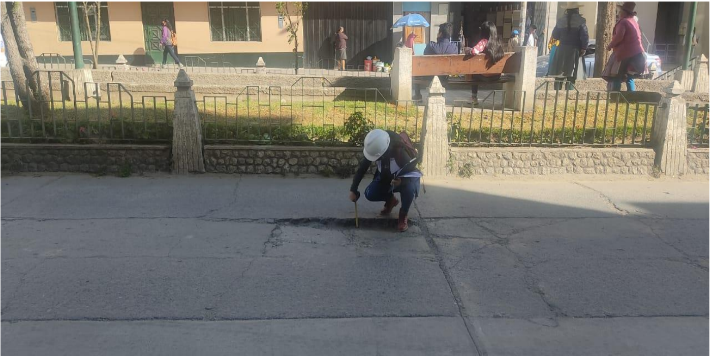
Figura 116. Evaluación de escala con una severidad media (25M)
