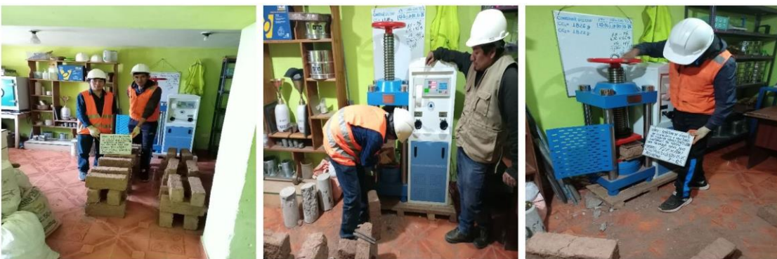
Ilustración 16. Ensayo de resistencia a flexión del adobe.
