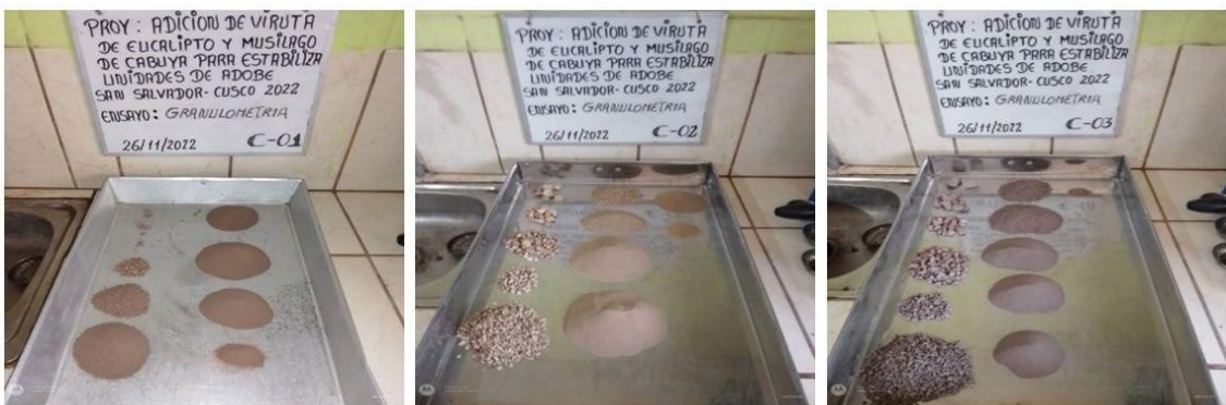
Ilustración 8. Ensayos de granulometría del suelo.
