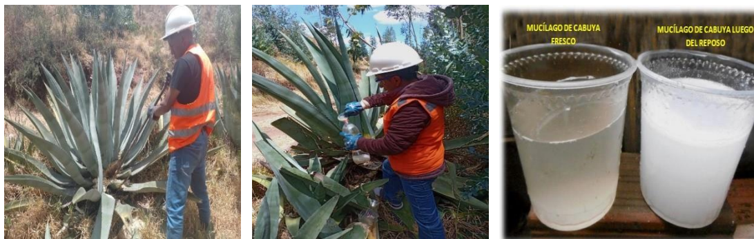
Figura 21. Extracción, recolección y muestra del mucilago de cabuya.
