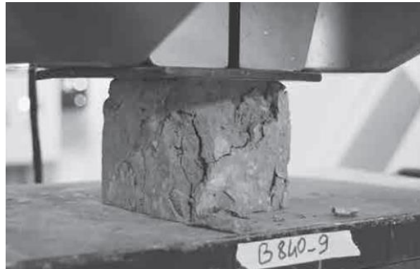
Figura 11. Ensayo de resistencia a la compresión del adobe.
