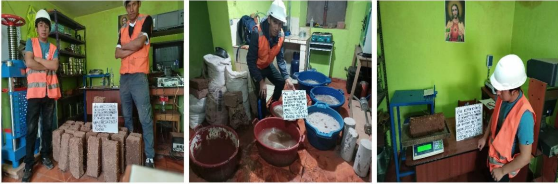
Ilustración 17. Ensayo de capacidad de absorción.
