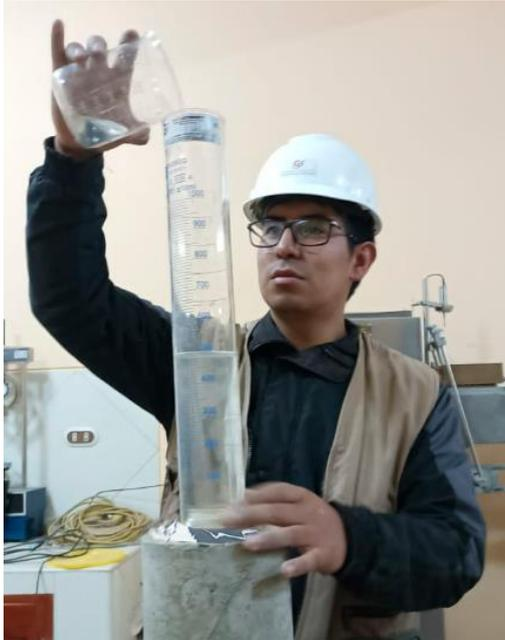
Fotografía N°18. Realización de prueba de infiltración de agua al concreto.
