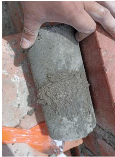
Fotografía N°33. Probeta reparada con mortero polimérico diseño N°2.
