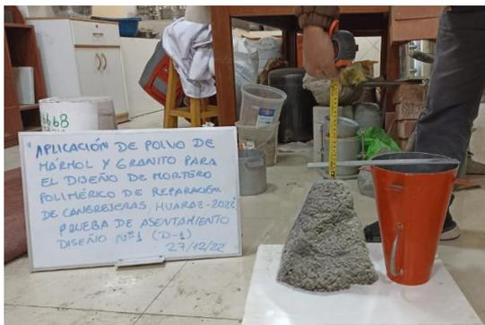
Fotografía N°10. Vista de la determinación del asentamiento del diseño N°1.
