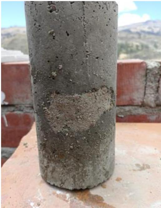
Fotografía N°32. Probeta reparada con mortero polimérico diseño N°1.
