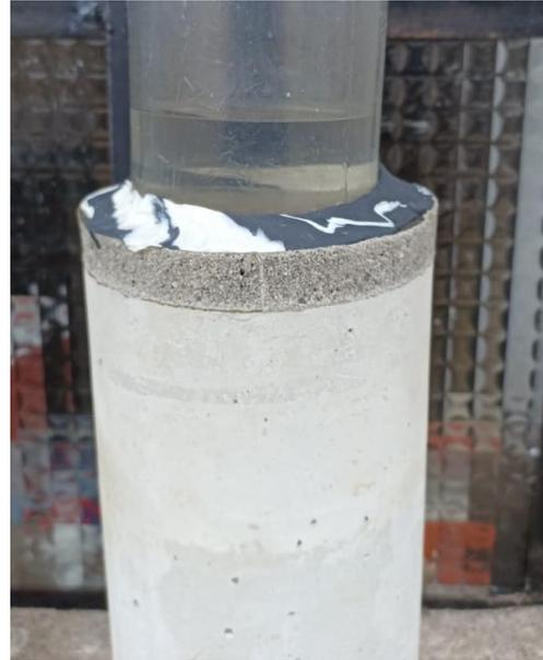
Fotografía N°19. Realización de prueba de infiltración de agua sobre capa de mortero polimérico.
