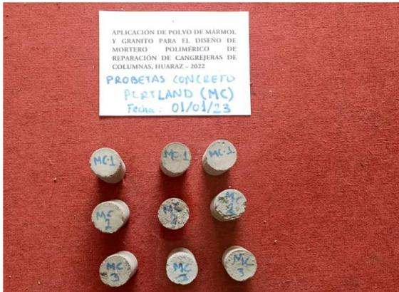
Fotografía N°14. Probetas de concreto portland (MC) para su ensayo a la compresión.
