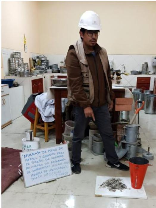
Fotografía N°8. Determinación de trabajabilidad del Diseño N°0.
