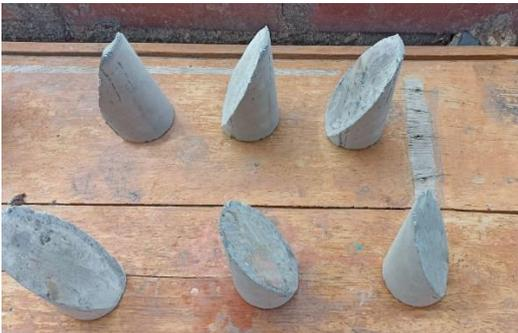
Fotografía N°18. Corte de probetas de concreto para ensayo de resistencia de adherencia.
