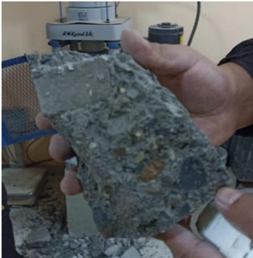
Fotografía N°36. Probeta post-rotura en zona de reparación.
