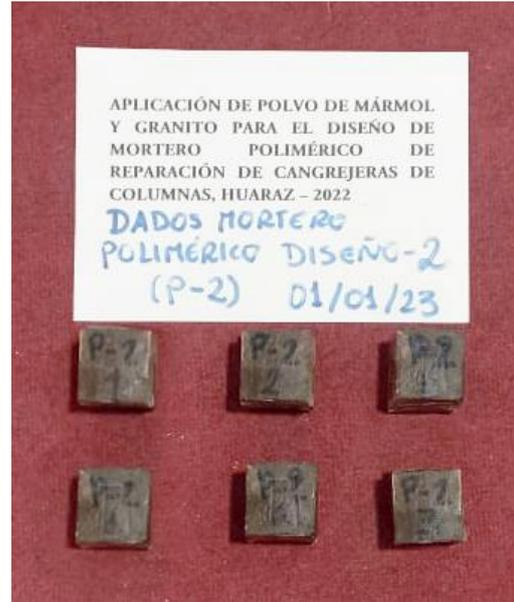
Fotografía N°11. Fabricación de dados de mortero polimérico con el diseño N°2.
