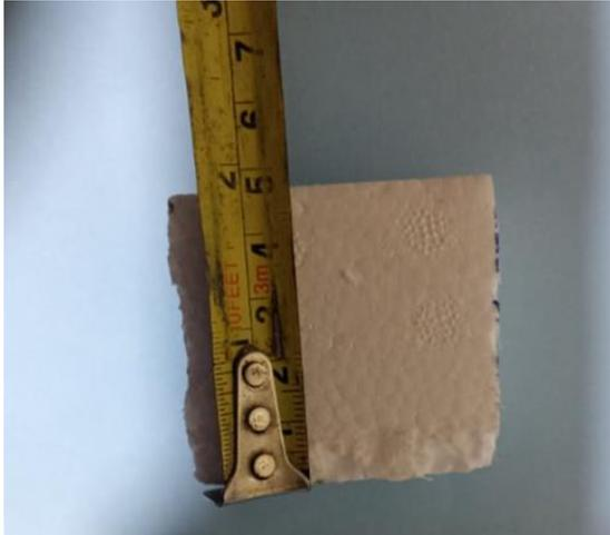
Fotografía N°24. Preparación de cubos de teknoport para introducción en probetas de concreto.
