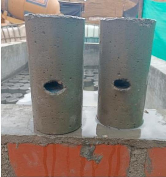
Fotografía N°28. Vacíos creados para simulación de cangrejeras.
