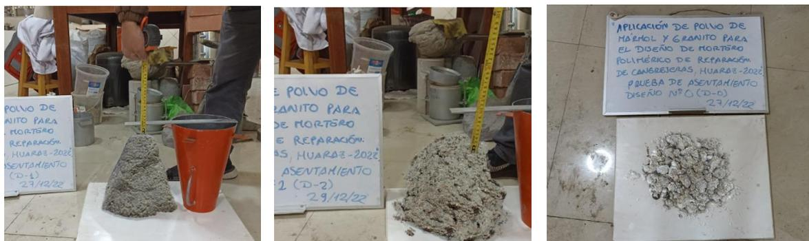
Figura 11. Determinación del Slump de los diseños de mezcla propuestos.
