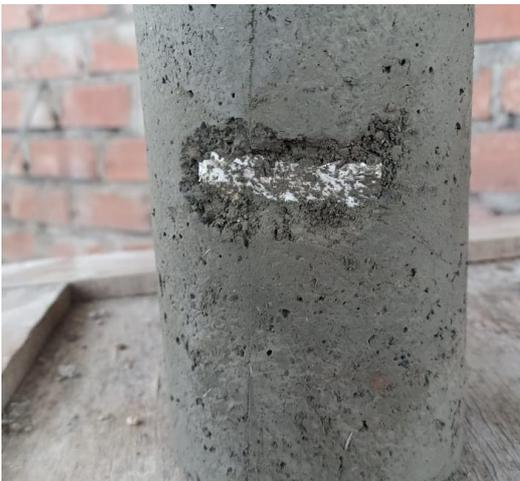
Fotografía N°26. Descubrimiento de vacíos creados con teknoport.
