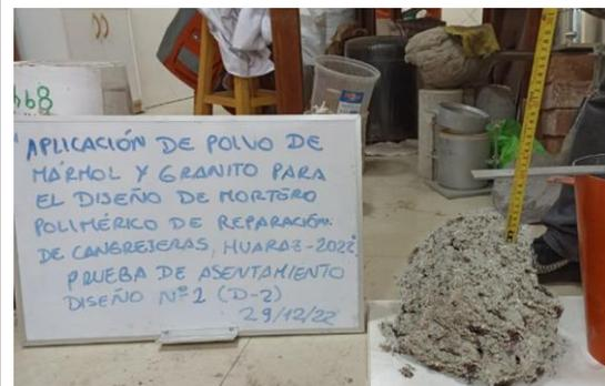
Fotografía N°10. Vista de la determinación del asentamiento del diseño N°2.
