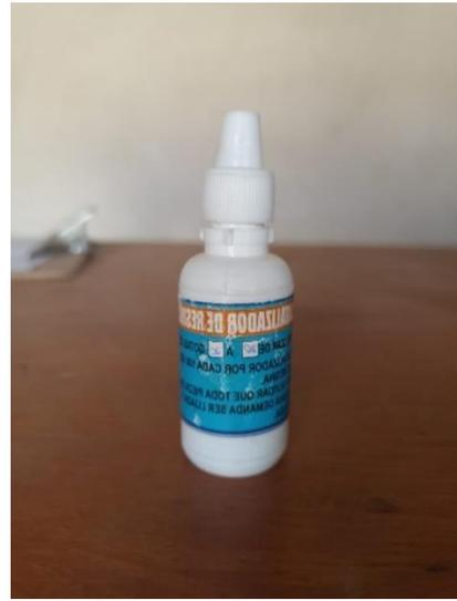
Fotografía N°2. Iniciador de resina de poliéster (catalizador).
