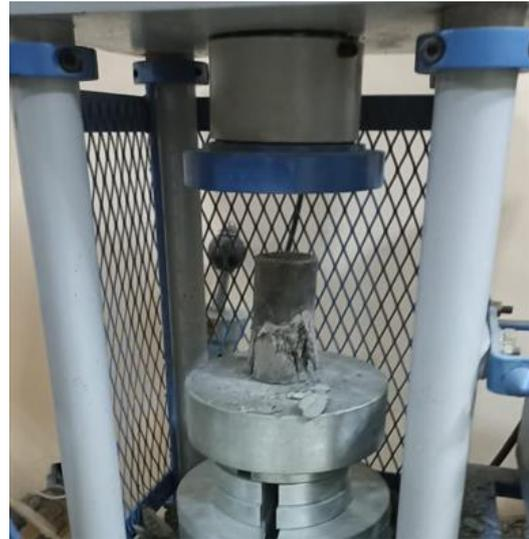
Fotografía N°21. Ensayo de resistencia de adherencia de la muestra.
