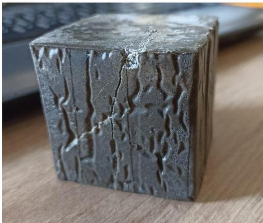
Fotografía N°16. Dado de mortero polimérico fisurado después de ensayo a la compresión.
