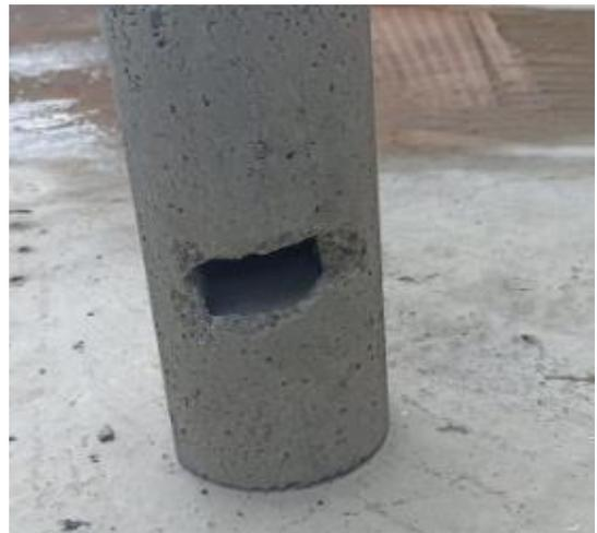
Fotografía N°27. Vacío creado para simulación de cangrejeras.
