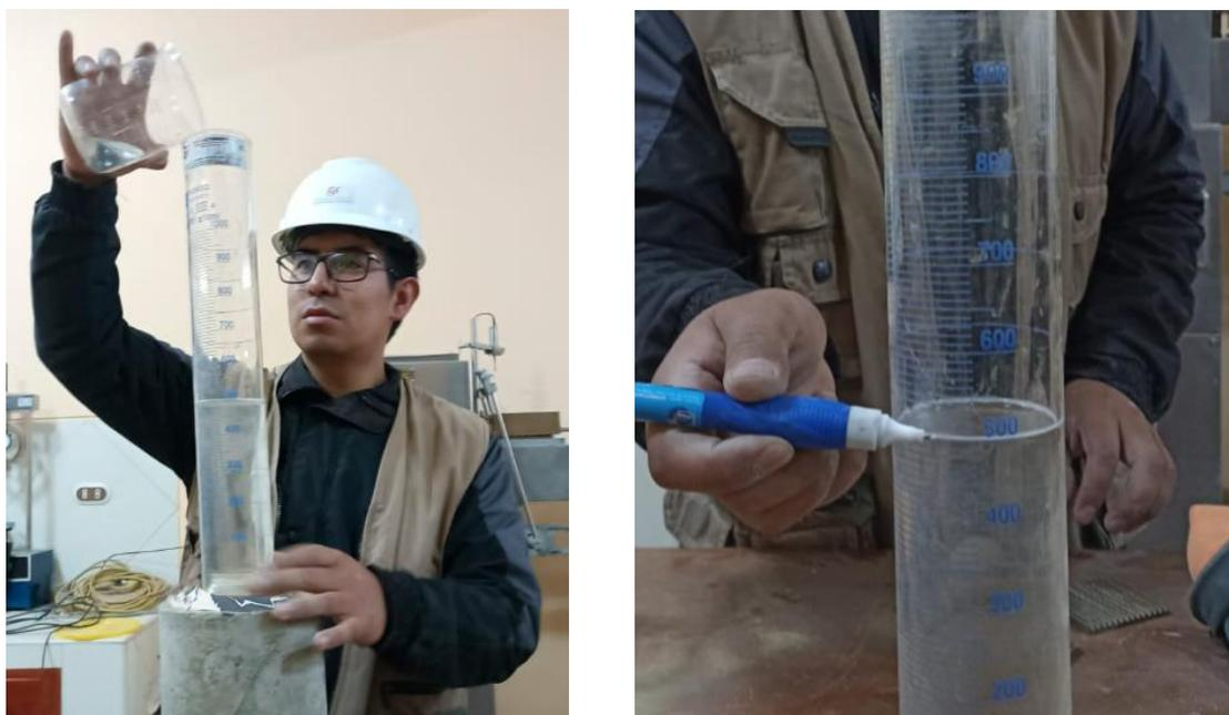
Figura 15. Realización de la prueba de determinación del ratio de infiltración de agua sobre los morteros.
