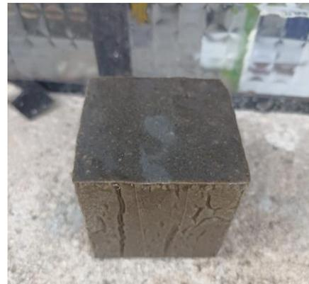
Fotografía N°13. Desmolde de dados de mortero polimérico.
