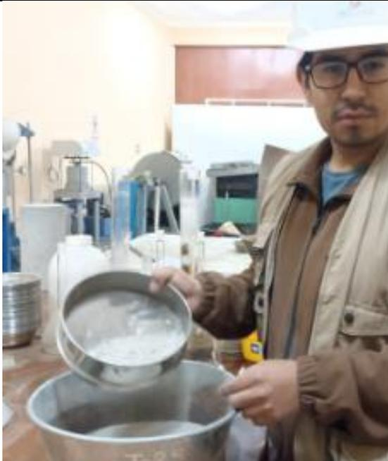
Fotografía N°6. Tamizaje de agregados.
