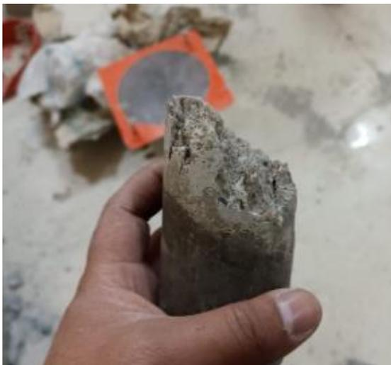
Fotografía N°22. Tipo de falla de probetas sometidas a prueba de resistencia de adherencia.
