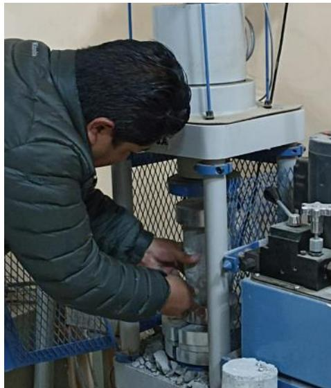
Figura 20. Reparación y ensayo de probetas con reparación.
