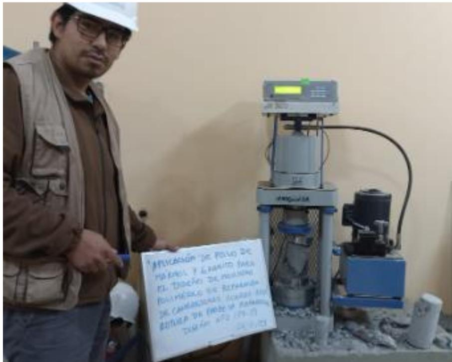
Fotografía N°34. Rotura de probeta reparada con mortero polimérico, Diseño N°2.
