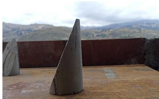
Fotografía N°19. Corte de probetas de concreto para ensayo de resistencia de adherencia.
