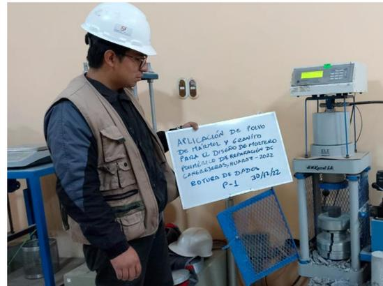
Fotografía N°15. Ensayo de dados de mortero polimérico a edades de 1, 2 y 3 días.
