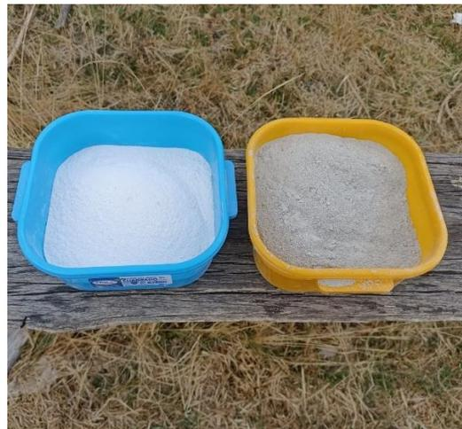
Fotografía N°7. Polvo de mármol y granito listos para la creación de mortero polimérico.
