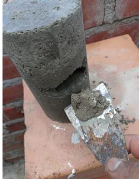
Fotografía N°29. Proceso de reparación de vacíos con mortero polimérico diseño N°1.
