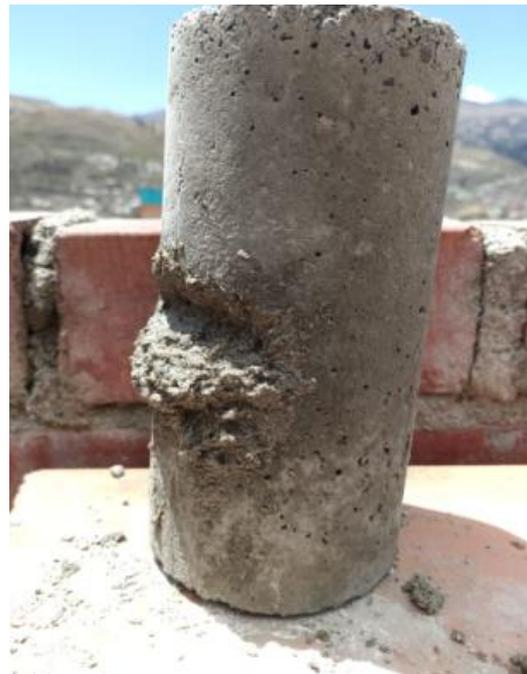
Fotografía N°31. Reparación de vacíos con mortero polimérico diseño N°2.
