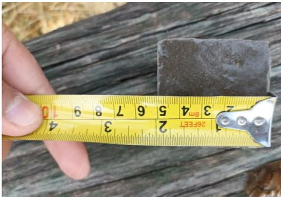
Fotografía N°12. Verificación de dimensiones de dados de mortero polimérico.
