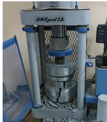
Figura 13. Creación de datos de mortero polimérico y ensayo a la compresión.
