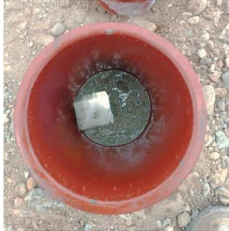
Fotografía N°25. Colocación de cubos de teknoport para simular vacíos en probetas.
