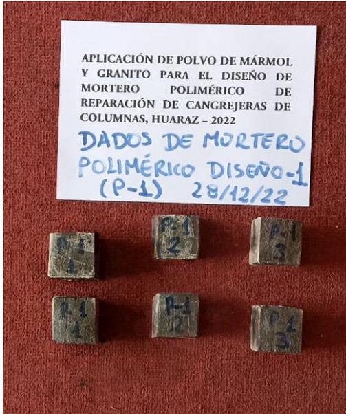
Fotografía N°10. Fabricación de dados de mortero polimérico con el diseño N°1.
