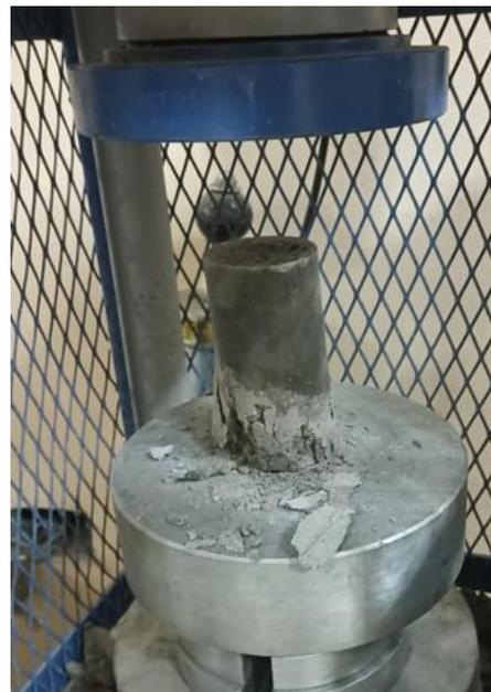
Fotografía N°23. Tipo de falla de probetas sometidas a prueba de resistencia de adherencia.
