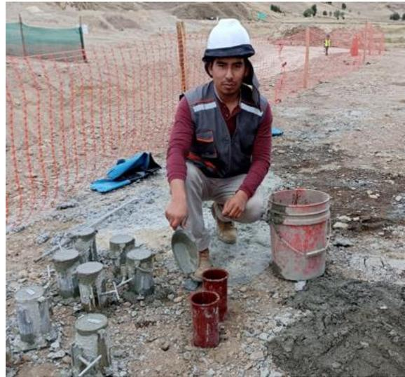
Figura 19. Elaboración de probetas de concreto portland con y sin vacíos.
