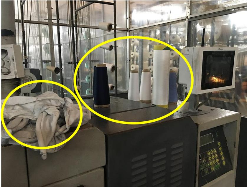
La superficie de la máquina de tejido contenía hilos que ya no estaban en uso, retazos de tela sucia (usado para limpiar la máquina).
