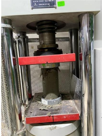
*Figura 3.* Ensayo resistencia a la compresión
