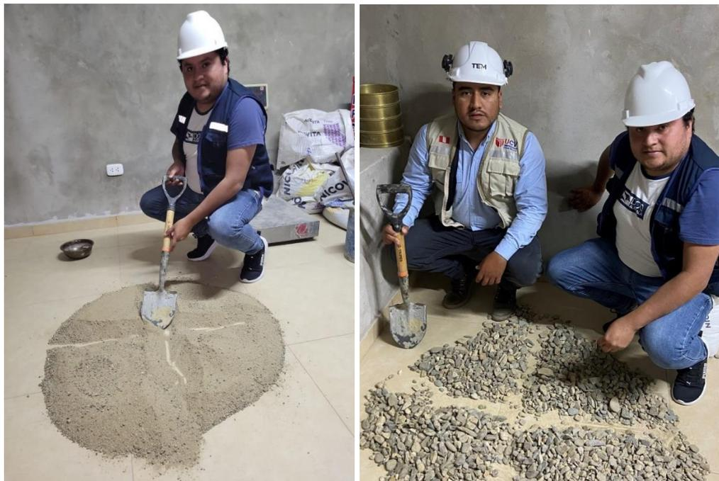
*Figura 7. Cuarteo de material agregado fino y grueso.*
