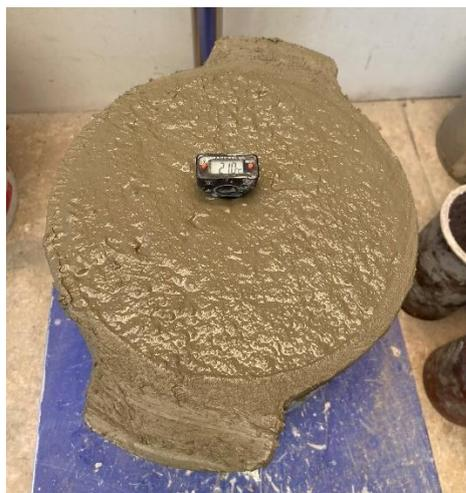
*Figura 17.* Ensayo Temperatura del concreto en estado fresco.
