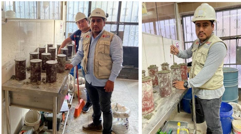
*Figura 18.* Elaboración de Especímenes de Concreto
