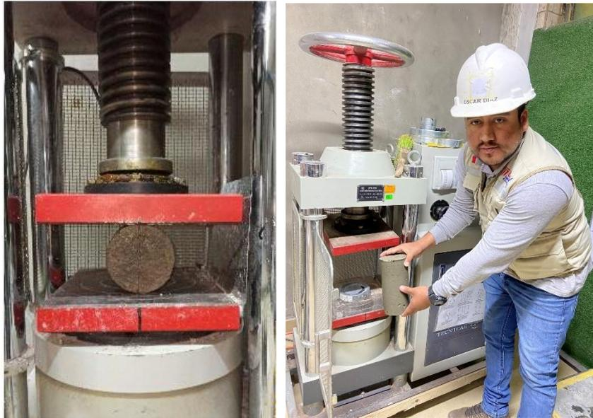
*Figura 21.* Ensayo Resistencia a la tracción del concreto.
