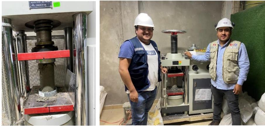
*Figura 20.* Ensayo Resistencia a la compresión del concreto.
