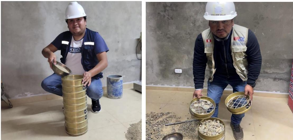
Figura 12. Tamizado agregado fino y grueso.
