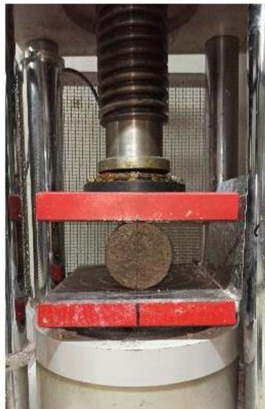
*Figura 4.* Ensayo resistencia a la tracción
