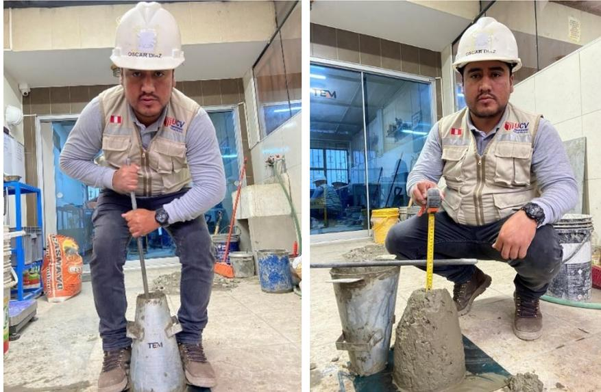
*Figura 16.* Ensayo de Asentamiento del concreto en estado fresco.
