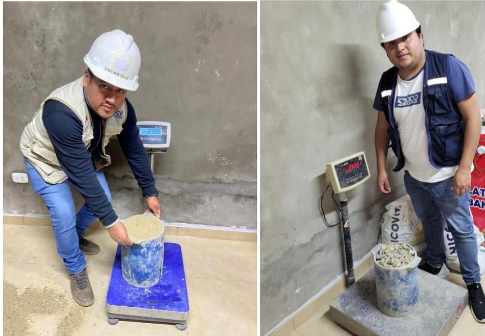
*Figura 9. Peso unitario de los agregados*
