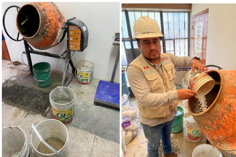
*Figura 14. Elaboración de Concretos f'c 210kg/cm2.*
