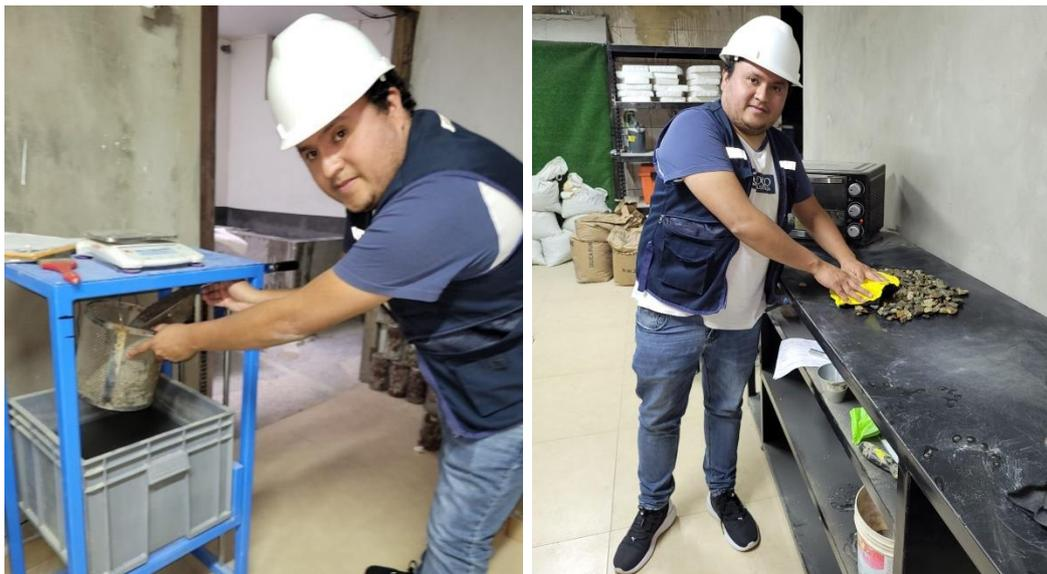
*Figura 11.* Ensayos peso específico y absorción agregado grueso.
