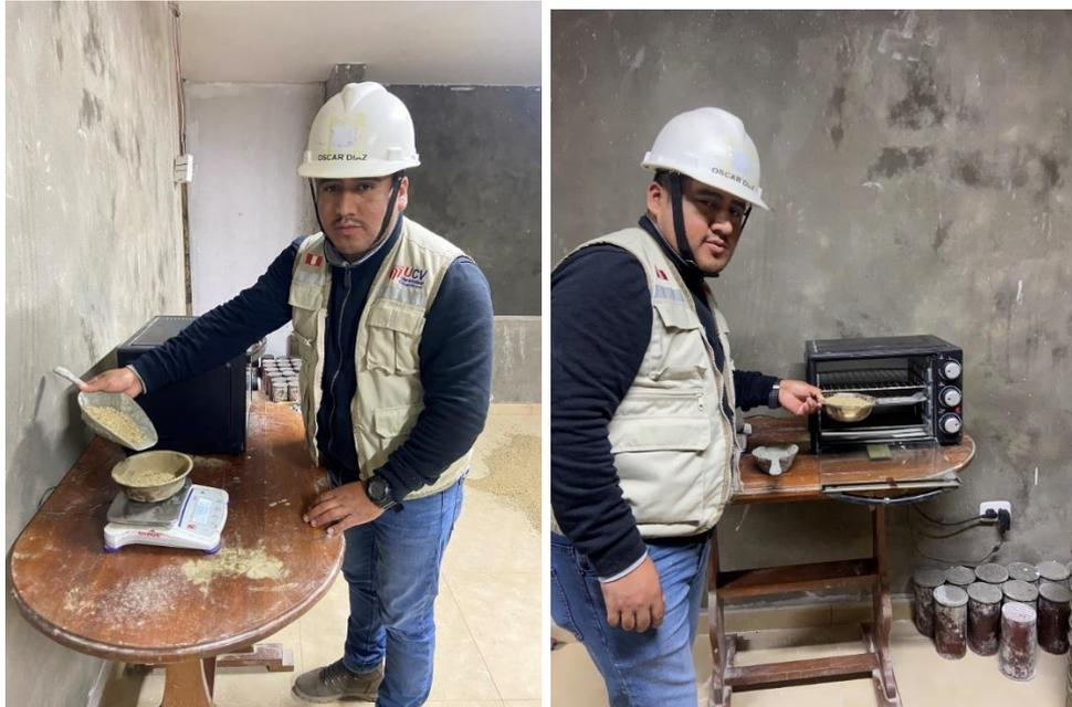
*Figura 8. Contenido de humedad de agregados*
