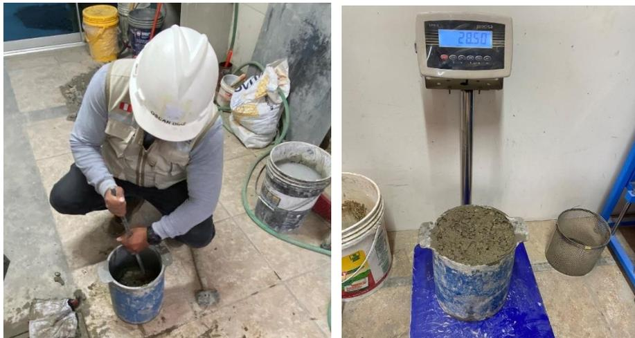
*Figura 15.* Ensayo Peso Unitario del concreto en estado fresco.
