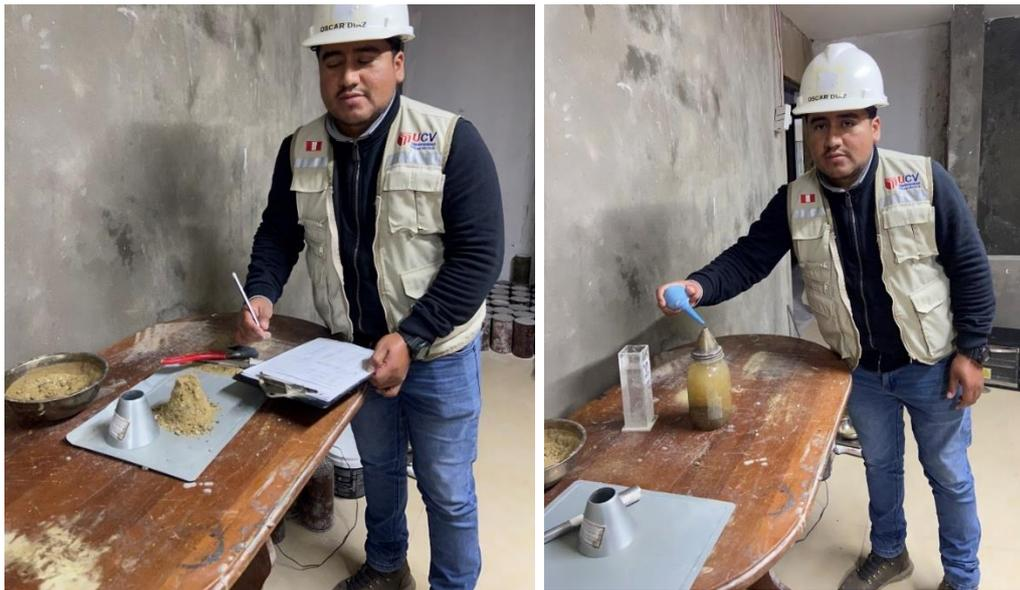
*Figura 10.* Ensayos peso específico y absorción agregado fino.
