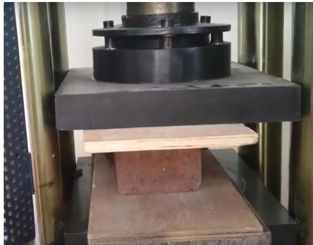
*Ilustración 2."Ensayo de resistencia a la compresión de la unidad de adoquín*
