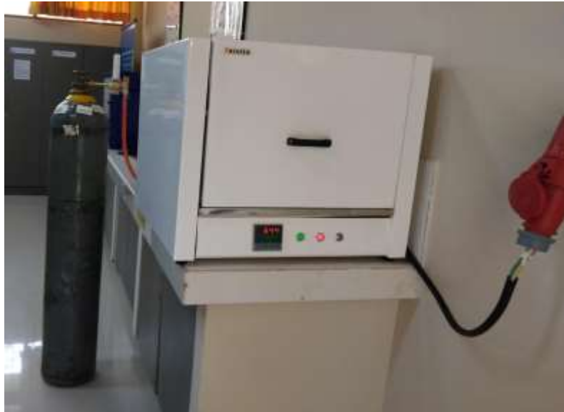
Figura 2: Proceso de pirolisis para obtener biochar
