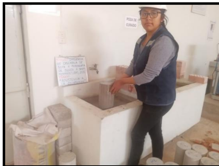
Figura 30. Poza del curado para la resistencia requerida
