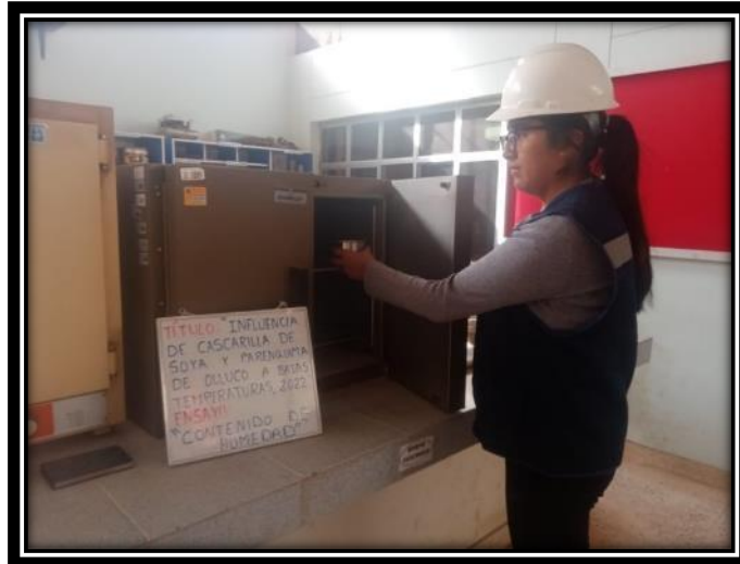
Figura 22. Ensayo contenido de humedad (colocación del material al horno)
