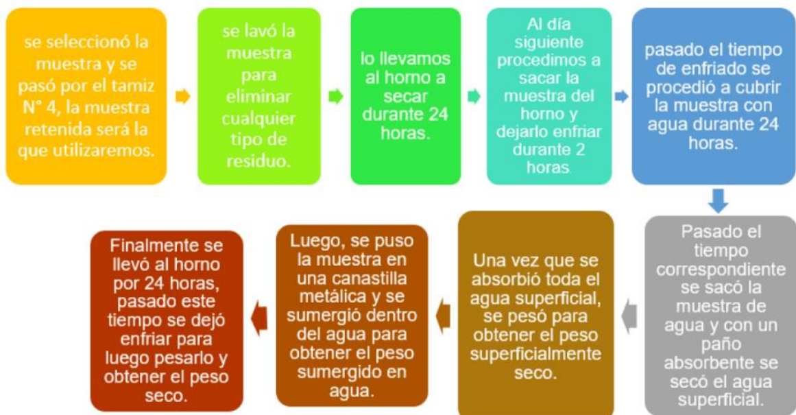
Figura 27. Procedimiento de peso específico y absorción
