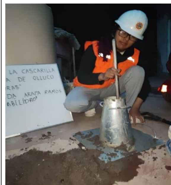
Fotografía 07: realizando los 25 golpes por 3 capa
