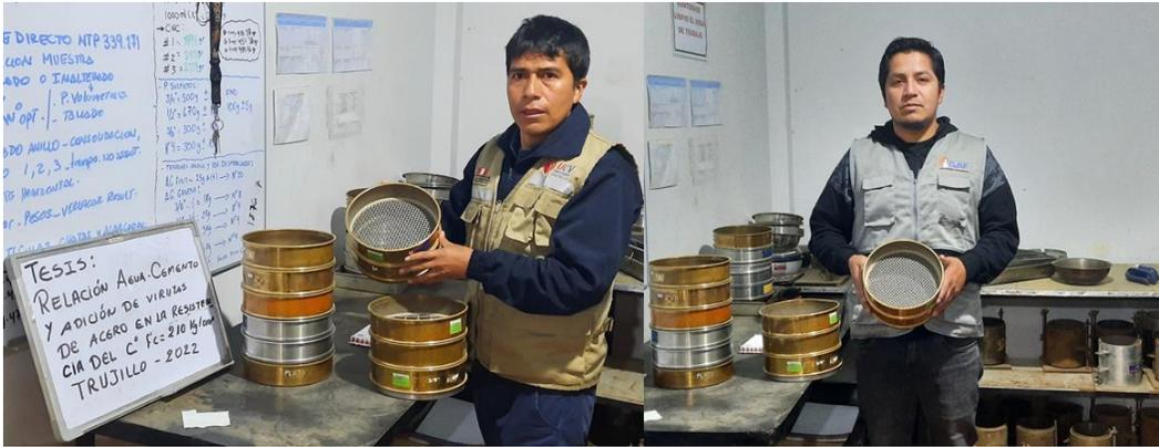
Imagen N° 3: Tamices para el analisis granulometrico de los agregados.
