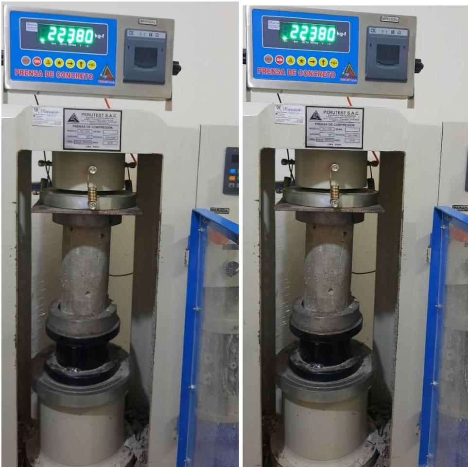
Imagen N° 7: Ensayos de rotura de probetas.
