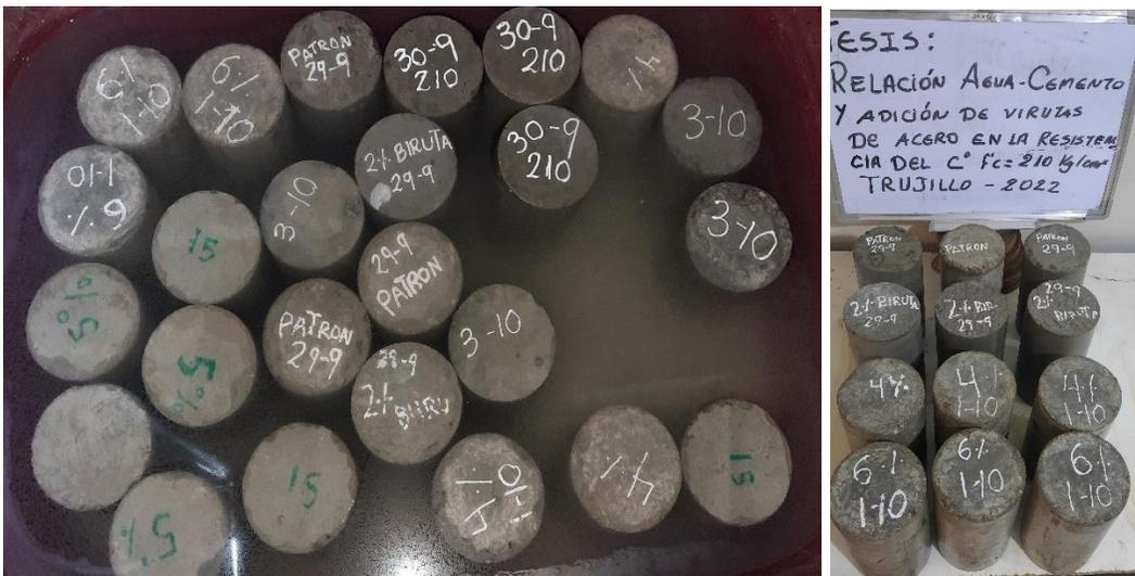
Imagen N° 5: Probetas en curado (patrones y adición de VA).
