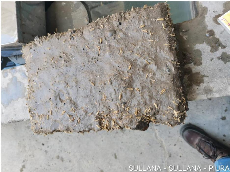
Figura N° 14 Muestra de Adobe después del Ensayo de Succión
