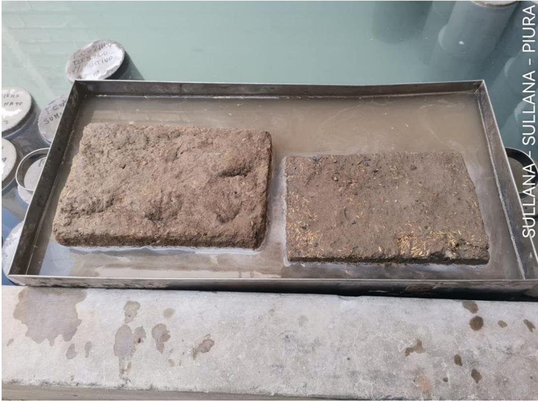
Figura N° 13 Ensayo de Succión de las unidades de Adobe
