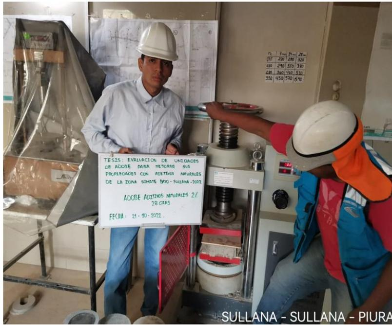
Figura N° 09 Ensayo de Resistencia a Compresión
