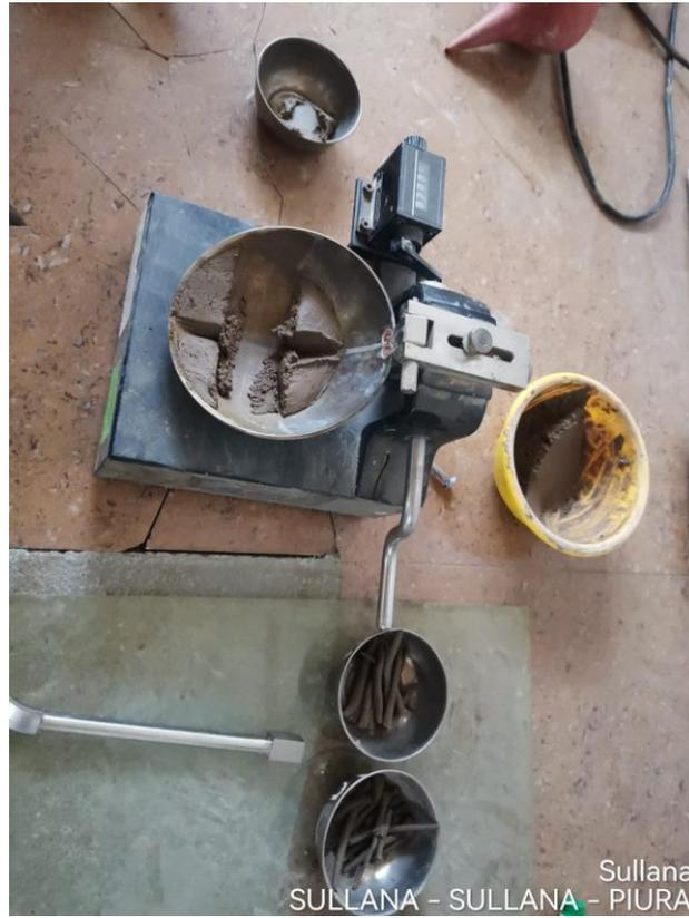
Figura N° 05 Muestras del Ensayo de Limite Liquido
