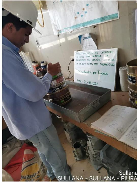
Figura N° 03 Granulometría por Tamizado
