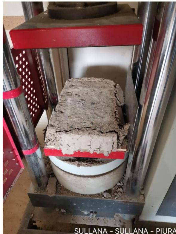
Figura N° 10 Muestras del Ensayo de Compresión
