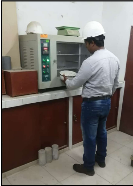
Figura 32. Las muestras se ingresan al horno para retirar la humedad
