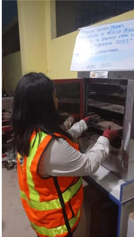
*Fotografía 15. Ensayo de absorción del agregado*
