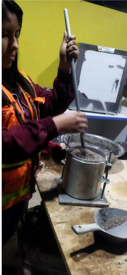
Fotografía 19. Peso unitario varillado del agregado
