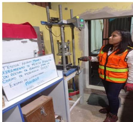
Figura 42. Ensayo Marshall
