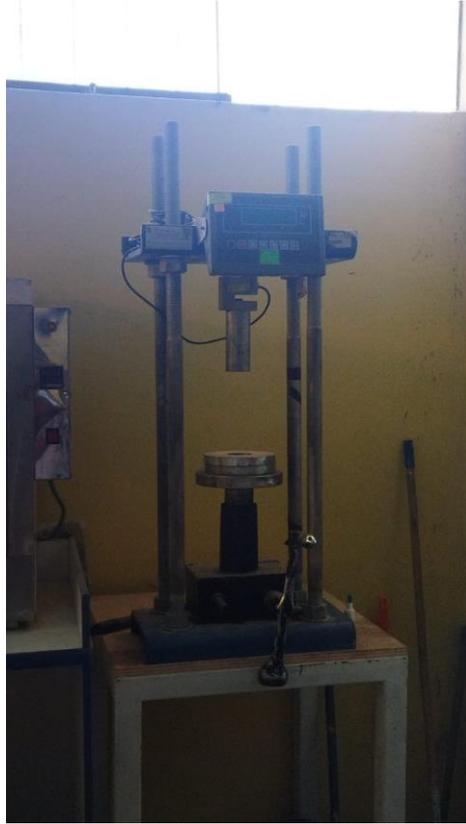
Fotografía 3. Prensa para ensayo Marshall
