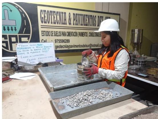
Figura 24. Análisis granulométrico
