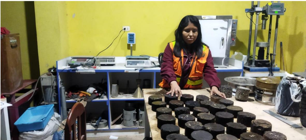
*Fotografía 16. Especímenes para ensayo Marshall*
