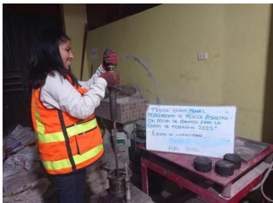
Figura 41. Compactación - núcleos de prueba
