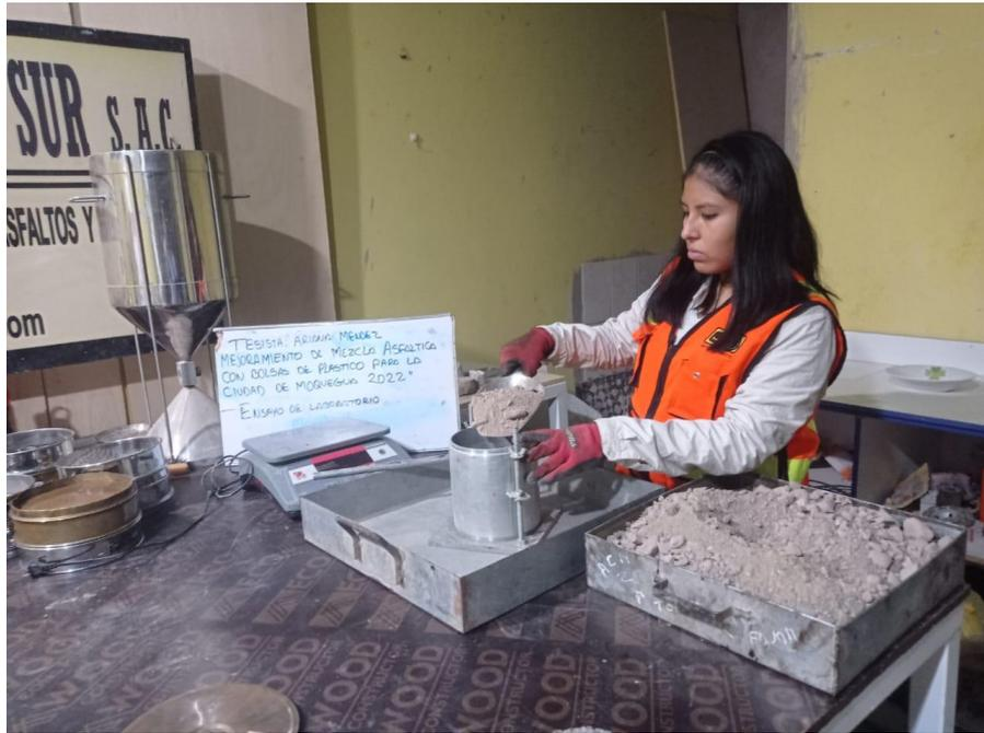
*Fotografía 1. Peso unitario suelto del agregado*
