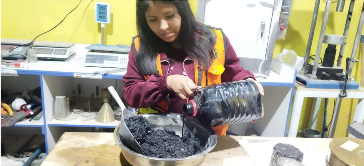
Fotografía 17. Elaboración de la mezcla asfáltica
