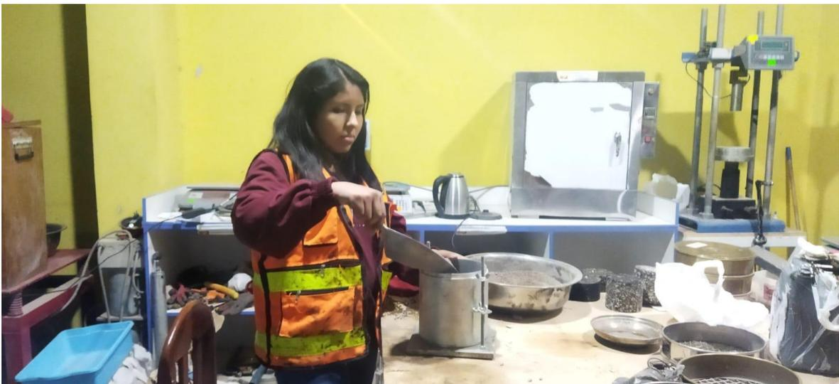
Fotografía 20. Peso unitario suelto del agregado
