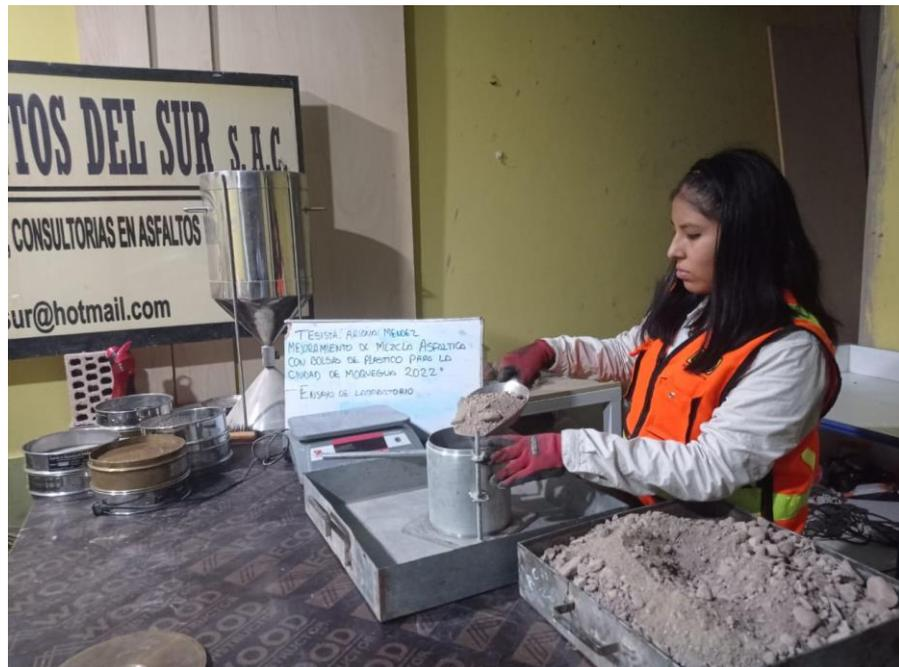
*Fotografía 2. Peso unitario compactado del agregado*
