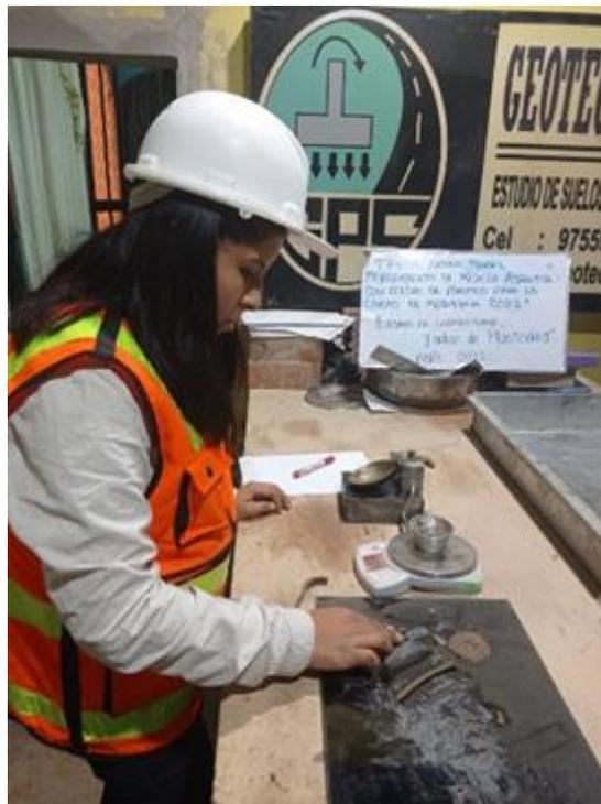
Fotografía 12. Ensayo de limite plástico
