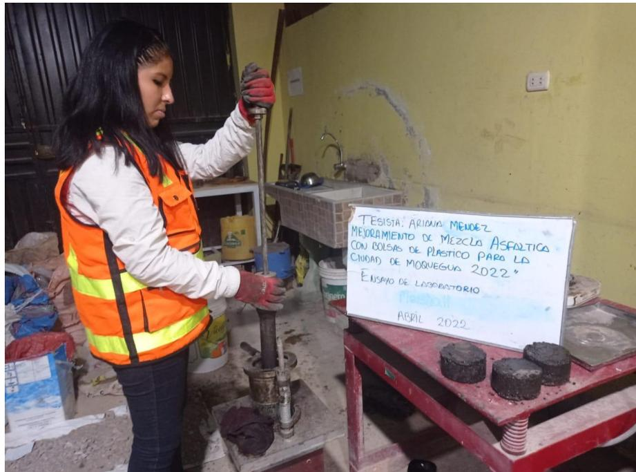
Fotografía 4. Elaboración de muestras para ensayo Marshall
