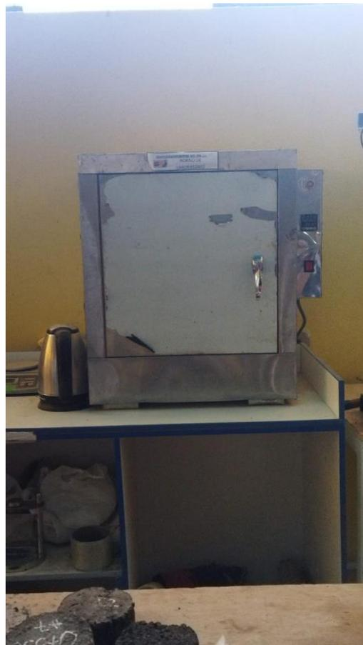
Fotografía 14. Horno normalizado para ensayos
