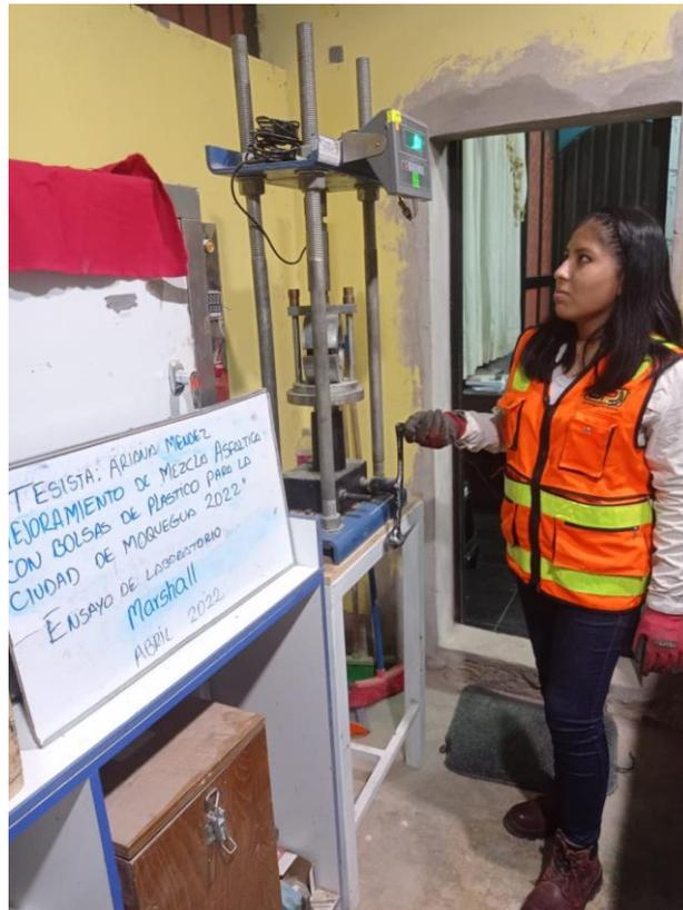
*Fotografía 7. Ejecución del ensayo Marshall*
