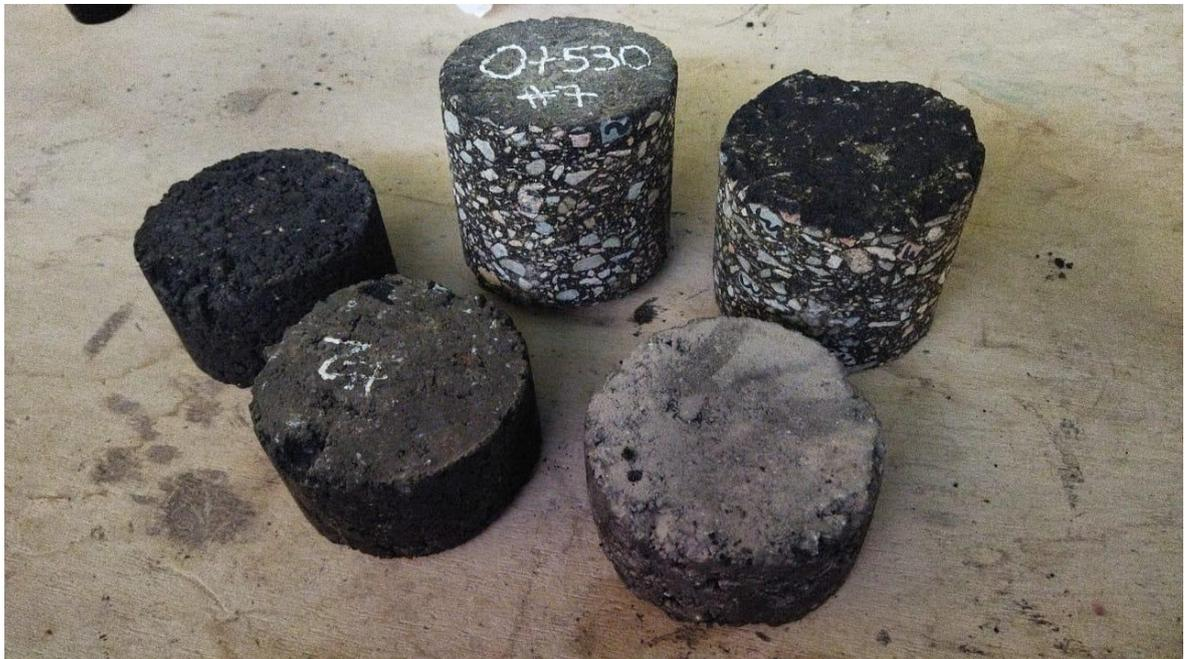
*Fotografía 6. Especimen compactado ensayo Marshall*
