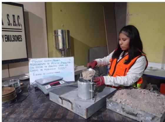
Figura 23. Peso unitario del agregado
