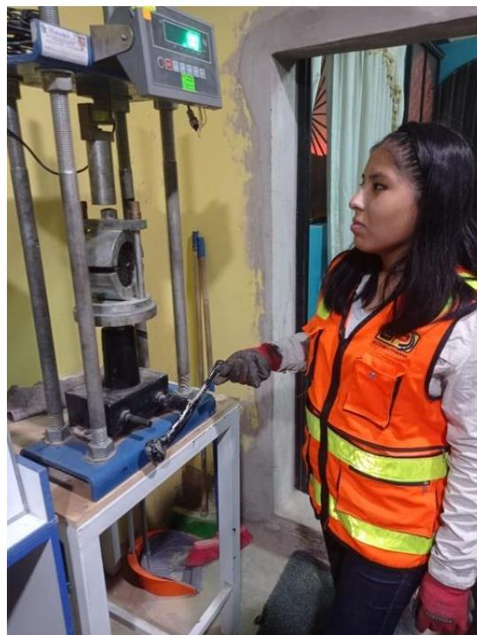
*Fotografía 8. Cuantificación del valor de resistencia-Marshall*
