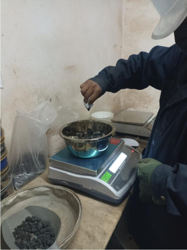
Fotografía 7. Preparación de muestra para realizar el ensayo Marshall
