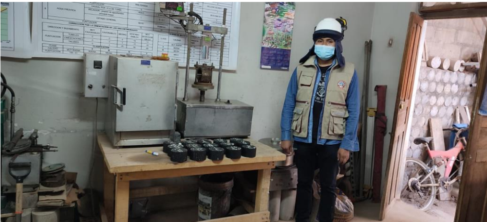
Fotografía 12. Muestras obtenidas para realizar el ensayo de Marshall.
