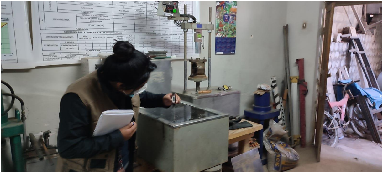
Fotografía 14. Revisión de la temperatura a 60° por 30 minutos.
