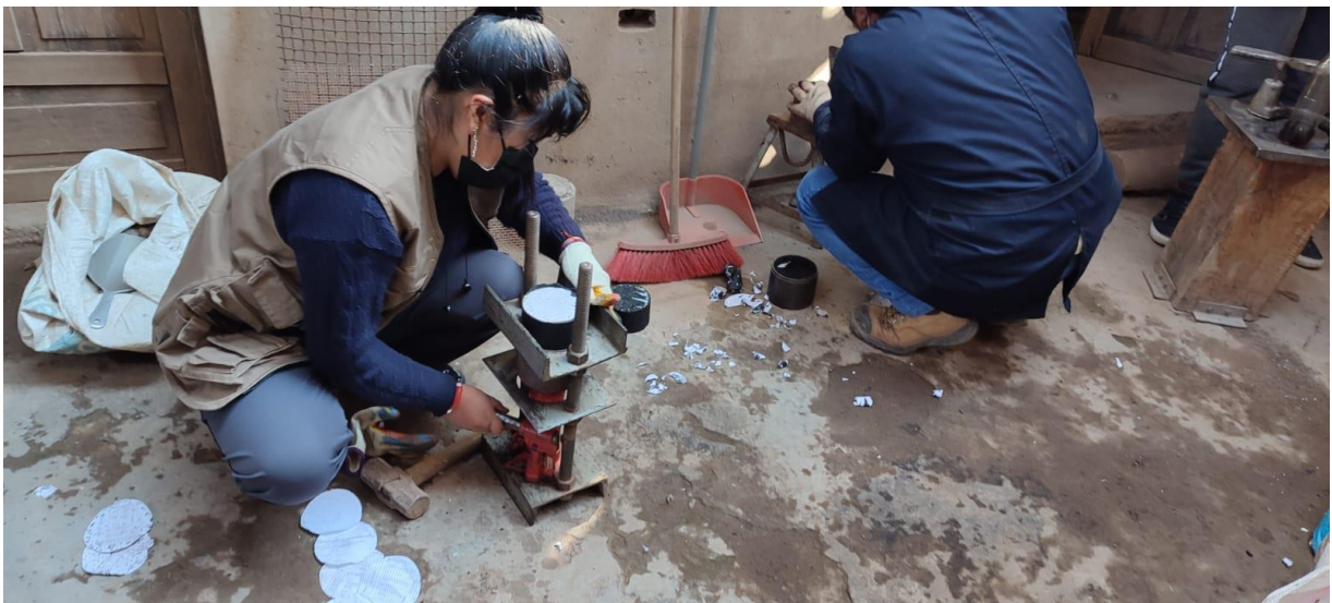
Fotografía 10. Desmolde de Briquetas.
