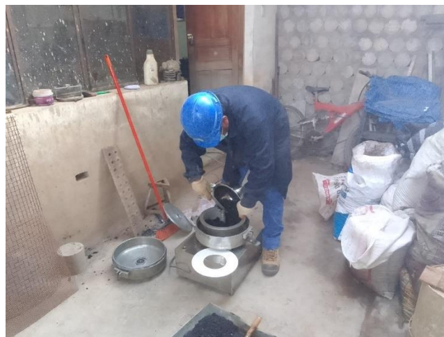
Figura 10. Vista de ensayo de lavado asfáltico.
