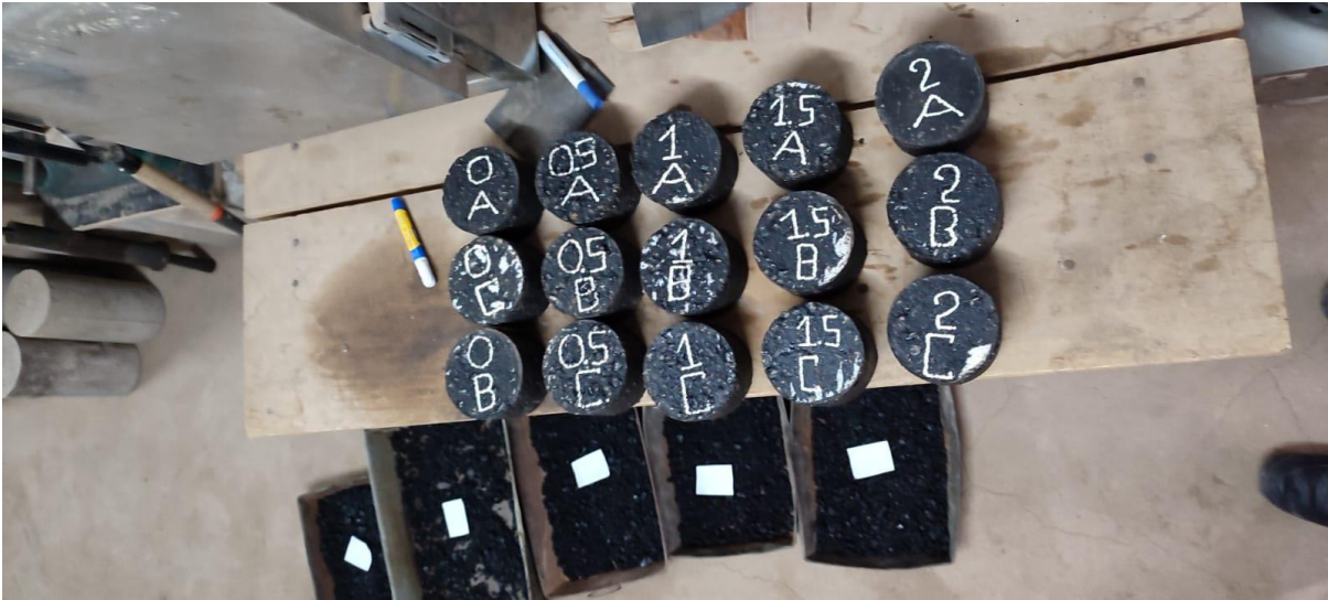
Fotografía 11. Muestras obtenidas de la mezcla asfáltica con RAP con diferentes porcentajes de rejuvenecedores asfálticos.
