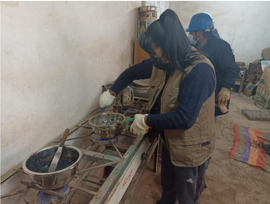
Fotografía 8. Preparación de la mezcla asfáltica con RAP adicionando rejuvenecedores asfálticos con diferentes porcentajes.
