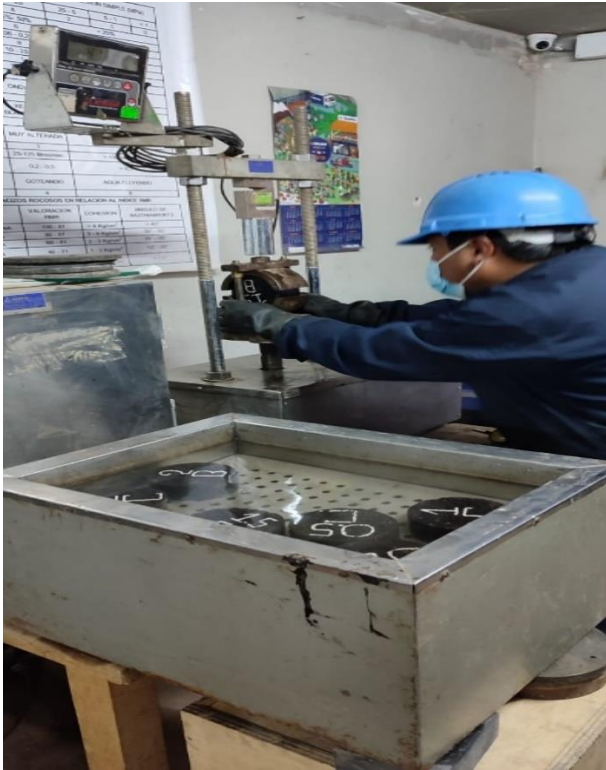
Fotografía 15. Realizando el ensayo Marshall para determinar estabilidad – flujo.
