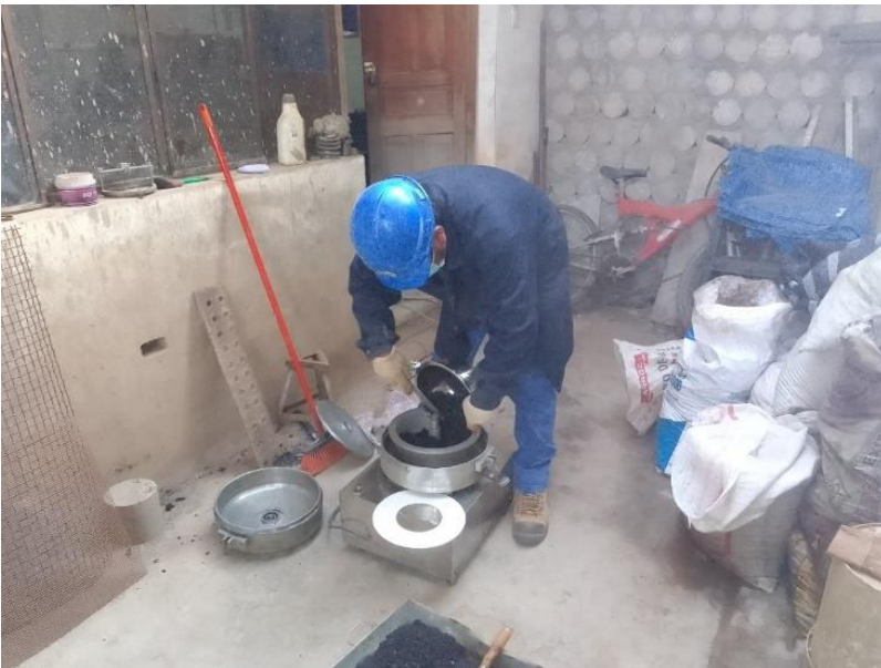
Fotografía 6. Ensayo de lavado asfáltico.
