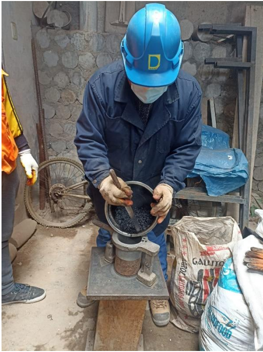
Fotografía 9. Colocación de la mezcla asfáltica con RAP y rejuvenecedoras asfálticas en el molde para someter a 75 golpes por cara.
