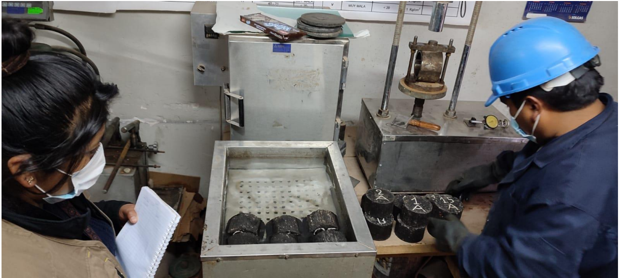
Fotografía 13. Colocación de briquetas en baño María.
