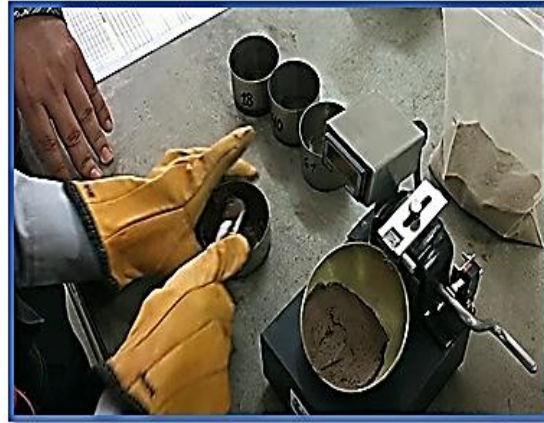
ESTADO LÍMITE LÍQUIDO, LÍMITE PLÁSTICO (ASTM D4318, NTP-339-129, MTC E110, METC E111)
