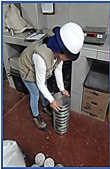
ENSAYO DE ANÁLISIS GRANULOMÉTRICO (ASTM D6913, MTC E107, NTP-339-128)
