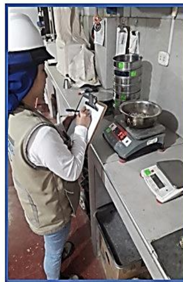
ENSAYO DE ANÁLISIS GRANULOMÉTRICO (ASTM D6913, MTC E107, NTP-339-128)
