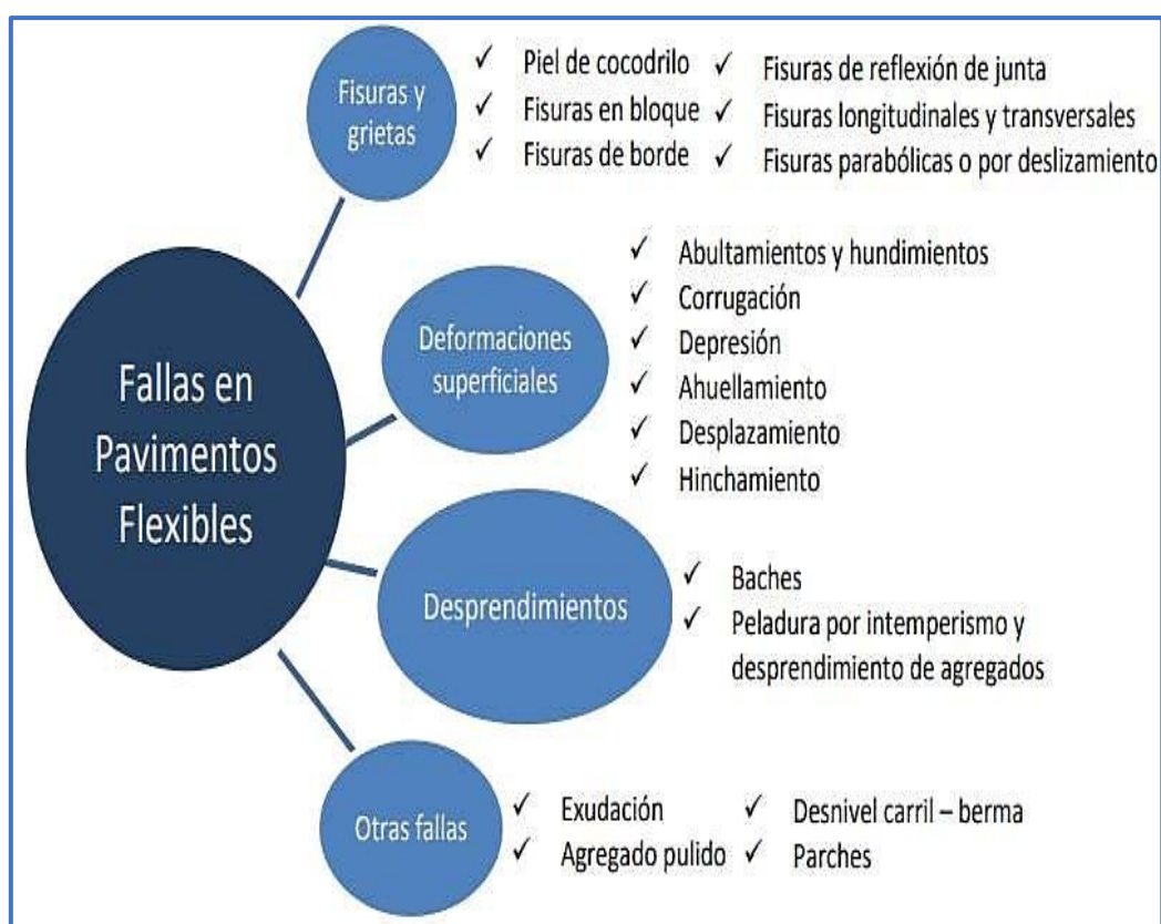
FIGURA N° 4: FALLAS EN PAVIMENTOS FLEXIBLES
